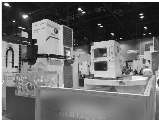
展位中最大的实物展品就是右图的RT130卧式镗铣机床，加工范围（X/Y/Z/W）：2500-3600/2100-3600/800-1250/1500-3500mm，最大承载：15000-25000kg。通过安装不同功能的附件头可以实现对国防工业、船舶、风电、工程机械等用户领域的大型零件的加工。
