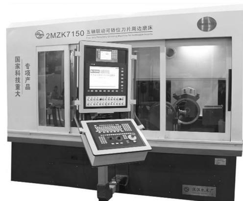
图1 2MZK7150全自动可转位刀片周边磨床外观
