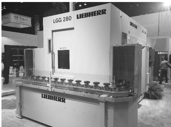
LGG280数控磨齿机是新开发的一代数控磨齿机。具有抛光功能和在机齿轮检测能力。工件直径280mm，模数6mm。突出的特点是新的磨头部件，磨齿时可以安装磨抛一体的蜗杆砂轮，一部分用于磨齿，一部分用于抛光；针对高精度磨齿的GH5.0/5.1砂轮头，配置双端动平衡系统，砂轮芯轴的主轴锥面为HSK50/40或者HSK40/32，转速分别为12000rpm和17000rpm。砂轮最大直径220mm，长度200mm。该系列机床还有加长型和高效磨削型（换装更大磨头部件GH6.0）。
