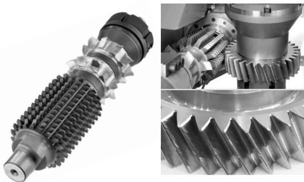
图31 蓝帜的滚—倒刀具系统、加工状况及结果
