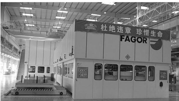
图17 法格开卷落料线
