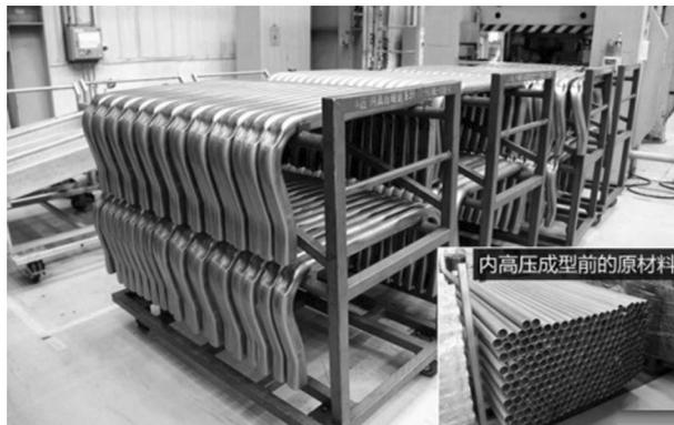
图26 内高压成品零件
