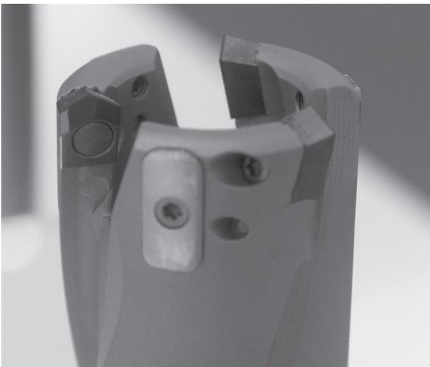
图24 玛帕的玻璃纤维套料钻
