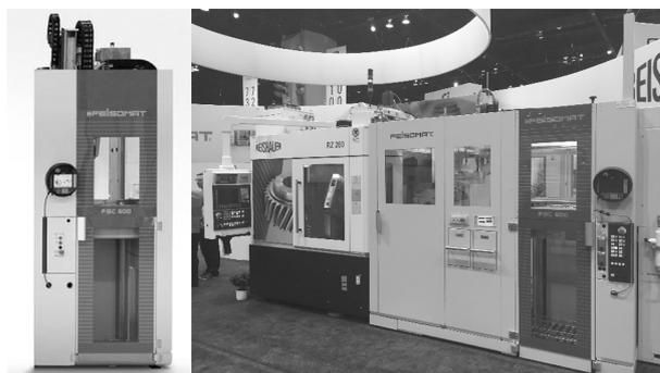
为了适应自动化生产的需要，在本次展会上还展示相应的解决方案，即集成自动存储系统-堆垛存储单元 FSC 600。该系统由REISHAUER公司旗下的子公司Felsomat为物流传输生产线而独特设计的。堆垛存储单元的高度、长度和功能均可以无限扩展，并且可以根据生产需要进行更改。堆垛交换由操作者在中央装载位置操作，而不用中断存储单元的运行。
