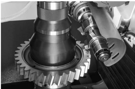
LC180数控滚齿机床（带独立倒角单元）最大的新优势是可以将原来滚齿和倒角两个工序合并在一台机床上同时进行，提高了加工效率和成本效益最大化。HSK 50接口的倒角切削主轴，安装的铣削主轴带有冷却喷嘴。独立的滚齿和倒角主轴均进行了刚度优化。工件直径180mm，模数3mm，滚刀直径90mm，滚刀转速6000rpm，倒角长度213mm。
