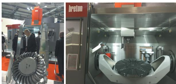
breton公司的摇篮式双摆工作台五轴加工机床及加工样品
