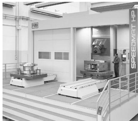
用于高效金属切削领域, 主要代表是汽轮机叶轮轴加工, 由于该类零件加工对精度和效率要求都很高, PAMA公司专门开发了MCR加工中心, 该技术方案是将两台机床布置在工件工作台的两侧, 实现由两台机床组成一个制造单元, 不仅提高效率, 也大大提高了精度。工件支撑系统由一个中心支撑架和两个液压支撑组成, 可以支撑最重220t和直径3m以内的叶轮转子轴。支撑轴径可在200mm至900mm之间调整。纵向行程15m, 立式行程分别为2.5m和1.2m。使用1.2m的铣刀盘可以实现最大300mm的切槽深度。
