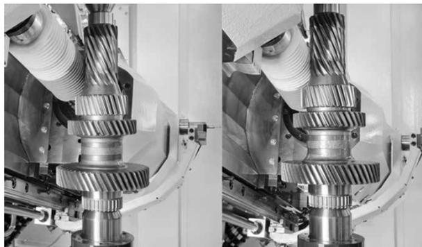
LS180F数控插齿机是面向变速箱制造中的多联齿轮轴零件的高效加工需求，这些齿轮零件往往为了追求紧凑的空间而导致齿轮间距离很小，其他齿轮加工工艺无法应用。新设计的该型机床插齿刀驱动采用数控方式，这有效降低了设置时间，并提高了加工精度。还有一个好处是可以实现工件一次装卡完成内外齿的加工。最大工件直径：180mm，模数：5mm，最高加工效率：1500、2000、3000往复/分钟，往复行程：70mm，切削范围：275mm，插刀锥柄：SK40/HSK-B80。
