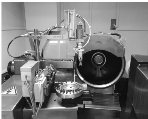
图15 2MK7130数控可转位刀片周边磨床
