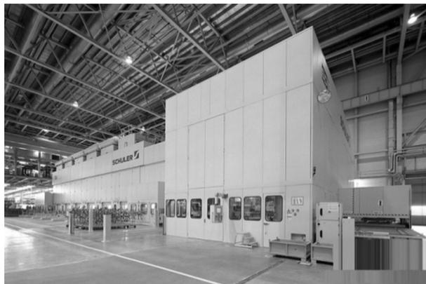
图11 宝马铁西厂伺服冲压生产线
