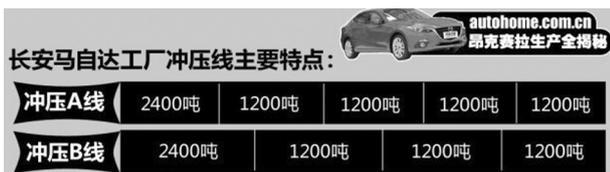
图13 长马江宁厂冲压线构成图
