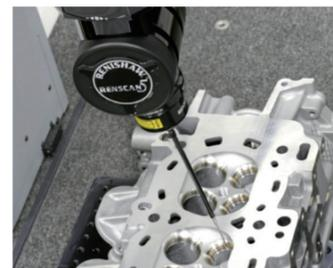
图5 五轴联动扫描用于缸盖测量任务: 12个进排气阀门座, 含36
