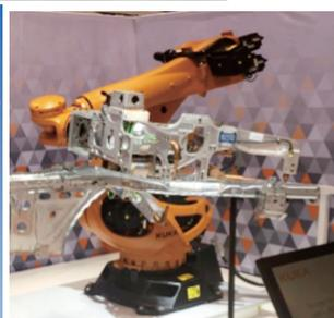
通过安装不同的功能头可实现夹持、搬运、焊接、喷涂、制造等多种功能，因此多用途工业机器人是其他特定用途功能型机器人的核心载体，根据实际使用需要演化出多规格的系列化产品。比较有代表性的国际品牌有FANUC、KUKA、NACHI等。目前，国际多用途工业机器人的承载能力范围：0.5~1350kg，可达范围：0~5m，轴数：2~7个。
