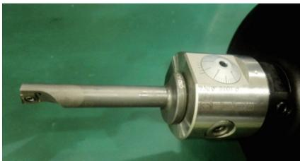
图4 加工双叉耳孔使用的刀具
