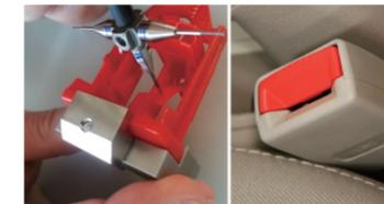
图15 安全带锁扣的测量
