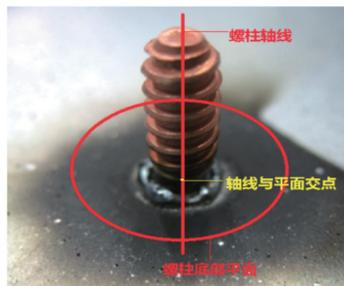
图12 测量螺柱的实例
