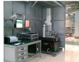
图27 适合车间环境的半开放式坐标测量机的应用实例
