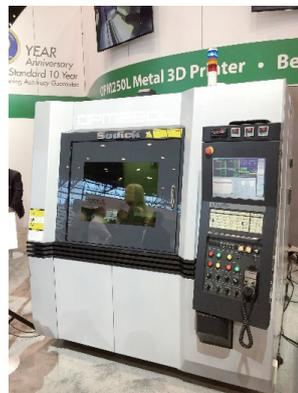
“高响应、高随动性”的特点，使高速和高精度加工可以并存。该机床具有以下功能和特点：45 000r/min的高速铣削主轴和用于对激光位置进行补偿的CCD摄像头；自动刀具交换装置（ATC），刀库中最多可设置16把刀具；可进行自动刀具测量；氮气发生装置，向激光烧结加工区域内供给氮气；粉末供给量调整机构，可调整造型区的普粉面积；配置废料收集桶，可用于收集加工后加工台上所残留的材料等。
