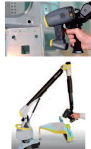
图23 尼康手持式激光扫描测头的两种应用
