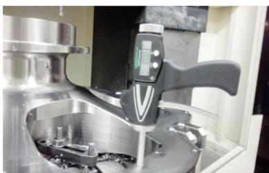
图1 动部件精度孔的加工需保证严格的孔径和表面粗糙度
