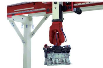
图6 利用桁架机械手传送零件
