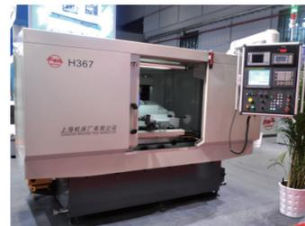
最大工件重量 30 kg; 中心高 125 mm; 圆度 (非偏心圆档) 0.0015 mm; 圆度 (偏心圆档) 0.002 mm; 直径纵截面一致性 (偏心圆档) 0.0025 mm; 偏心距误差 ±0.0025 mm; 表面粗糙度  $R_a = 0.32 \mu m$ 。
