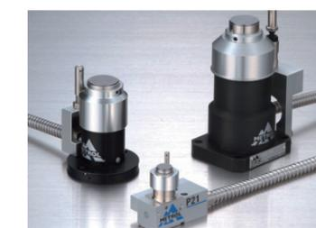
于进行刀具预设、检测磨损和折损、补偿热位移。销售数量达50万台,拥有全球顶级的市场份额。其动作点的重复精度:ON/OFF均为0.001mm(范围);保护构造:IP67;接点精度寿命:300万次。
