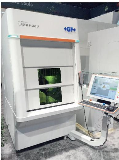
LASER P 400 U结构紧凑，工作区域600mm×400mm×250mm。模块化概念包括一个拥有专利的一体化
