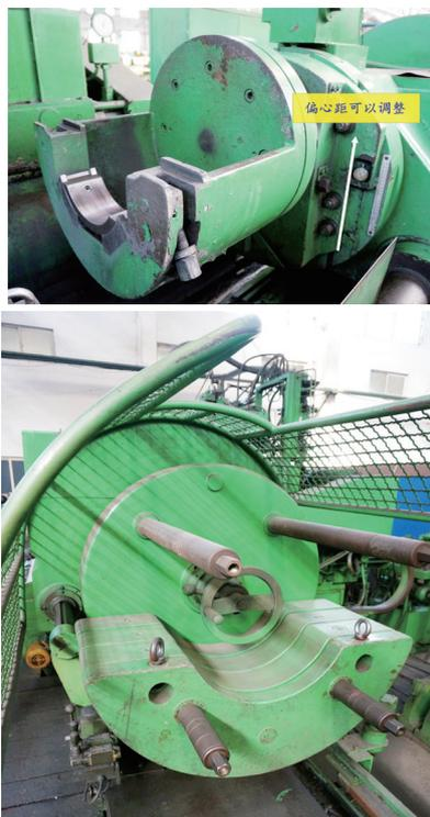
图2 曲轴工装与偏载的配置
