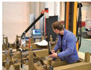
图9 采取手持方式检测夹具
