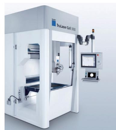
接和扫描焊接等。配制6轴机械手，定位精度±0.05mm，最大夹持重量30kg。加工范围（宽/高/深）：1400/800/1200mm。该机床可以用于叶轮零件的焊接加工和薄壁板材控制柜的激光热导焊等。
