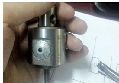
图2 A76002镗头配合镗杆具有2~20mm的镗削覆盖以及较大的刻度盘
