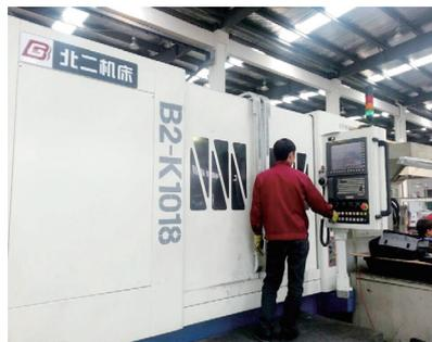
图4 北京二机厂双砂轮架随动曲轴磨床
