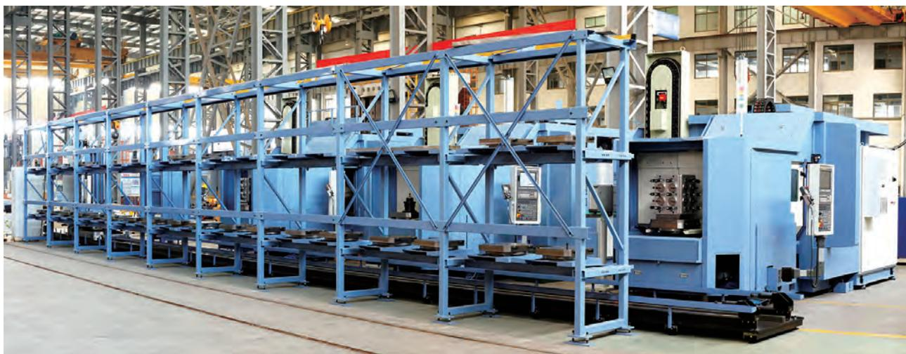
日发精机联合旗下MCM共同展出由一台四轴卧式加工中心、一台五轴卧式加工中心以及轨道穿梭车组成的，通过MCM自主研发的JFMX控制系统集成的柔性生产线。未来伴随杭州日发智能化系统工程有限公司软件不断开发升级，日发精机将把自动化产品、智能设备、IT技术完美结合，实现智能工厂和智能应用。让整个体
