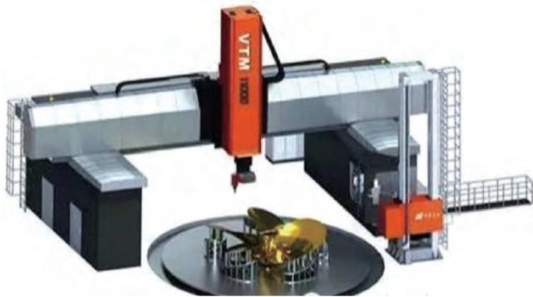
图6 加工螺旋桨的五轴龙门铣的双摆头加转台的配置
