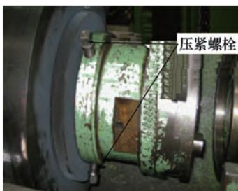
图1 原机床分度联接装置
