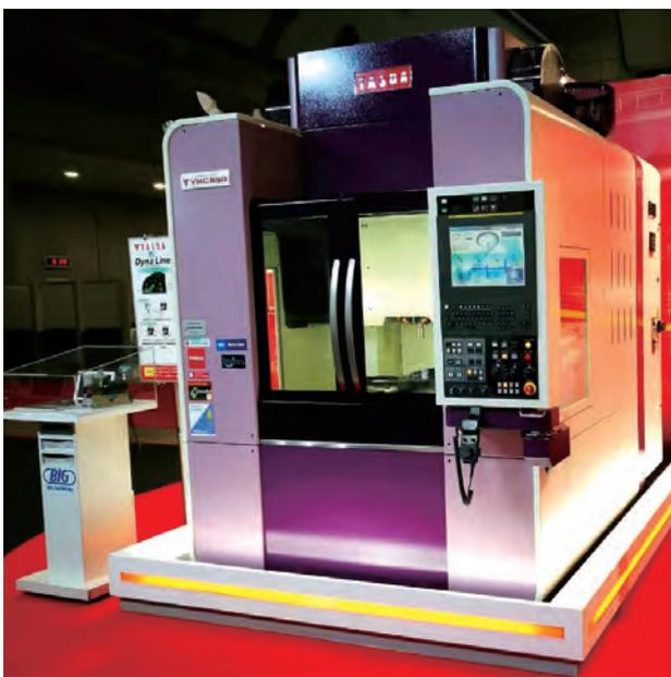
轴线性电动机驱动，高刚性结构，完善的热变形对策，实现长时间稳定高精度加工，搭载新OpeNe，提供简明易懂的直观操作、自我诊断及分析等功能。
