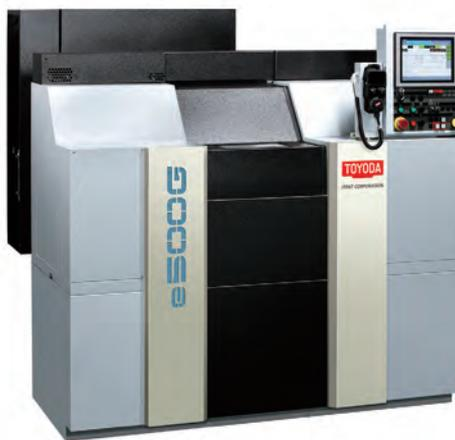
削直径80mm，工作台上最大回转直径200mm，顶尖距280mm，砂轮线速度45m/s，砂轮架/工作台快速40/30m/min，数控系统（JTEKT）TOYOPUC-GC70（Fanuc 0i可选）。全段磨削的两顶尖间工件装卡模式，砂轮架和工作台V平导轨，滚珠丝杆传动，高刚性低振动床身，专利的动静压轴承，普通砂轮和CBN砂轮可选，高精度过滤冷却液装置可选，紧凑的结构尺寸。
