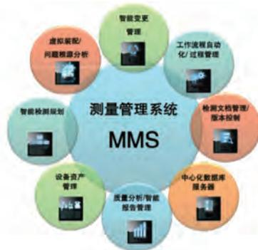
图8 组成MMS系统的八个模块单元
