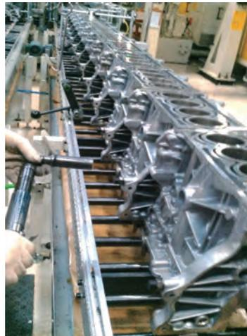
图6 工件在上料时安装电子芯片
