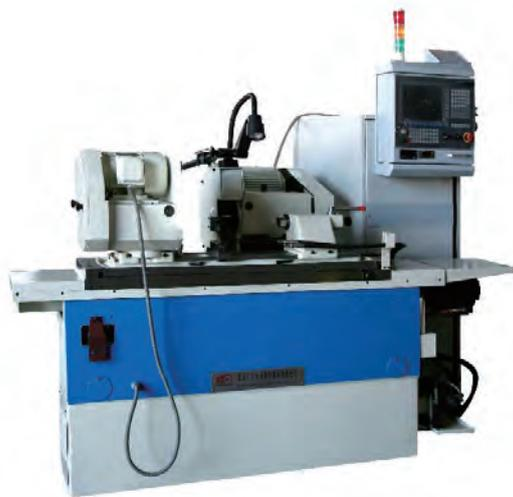
(23) 北京广宇大成数控机床有限公司MGK2850数控立式万能磨床。工作台直径（带磁盘）500mm，最大
