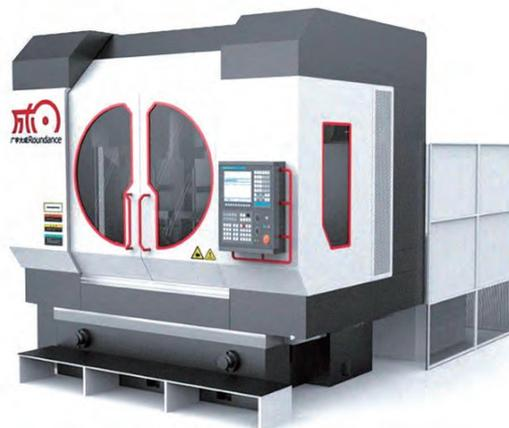
(24) 青海第二机床制造有限责任公司SK721全自动数控丝锥磨床。加工直径范围1~10mm，最大加工长度80mm，最大工件长度100mm，加工导程范围0~999mm，磨头角度调整范围±10°，砂轮轴功率5.5kW。适用于小规格丝锥、螺杆、螺纹环规、蜗杆、航空紧固件、医用外科接骨螺丝等直螺纹、锥螺纹及公、英制螺纹及小规格挤压丝锥的螺纹的磨削加工。
