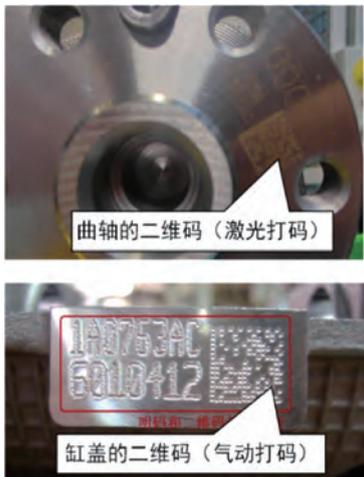
图5 曲轴和缸盖的二维码示例
