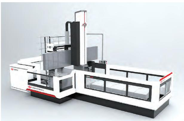
(16) 沈阳机床股份有限公司i5M8 智能多轴立式加工中心。工作台尺寸700mm × 500mm, X/Y/Z轴行程600/750/450mm, X/Y/Z快速30m/min, 主轴最高转速12 000r/min, 主电动机最大功率15kW, 刀库容量20把。
