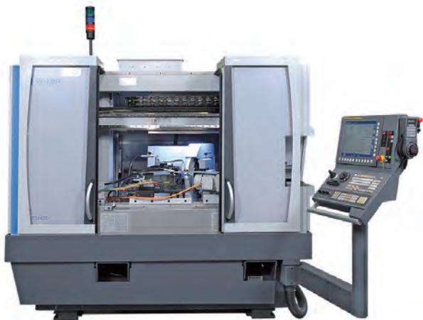
(13) 哈挺中国有限公司KELLENBERGER VARIA 高精度数控万能外圆磨床。中国首展, 顶尖距1 000/1 600mm, 磨削长度1 000/1 600mm, 中心高200/250/300mm, Z轴行程1 170/ 1 670mm, X轴行程365mm, X/Z轴快速10/20m/min, 数控系统海德汉GRINDplus 640 (FANUC 31i Model B可选)。X/Z/B的三轴联动(需配备KELLENBERGER专利技术的砂轮自动测量系统KEL-SET), 分离式结构设计阻断了震动和热量的传递, X、Z轴采用静压导轨实现0.1 μm微进给, 高扭矩直驱B轴及预紧静压导轨及高精度绝对值圆光栅实现0.000 1°进给, 并在锁紧与非锁紧两种状态下都能正常工作。
