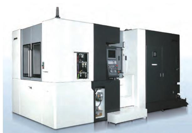
(9) 牧野机床(中国)有限公司a40卧式加工中心。X/Y/Z轴行程560/640/640mm，工作台尺寸400mm × 400mm，最大工件尺寸φ630 × 900mm，最大工件质量400 kg，主轴功率2/15/11kw (25%ED/10 min/连
