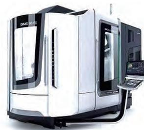
DMG MORI的DMC 80 FDS duoBLOCK®支持磨削技术，配DMG MORI内圆和外圆及端面磨削的加工循环。修磨循环进一步扩展功能范围。新的AE传感器(发声传感器)能检测砂轮与修磨机间的接触瞬间，确保高可靠性和高精度。此外，通过主轴负载还能检测到砂轮与工件接触的瞬间。磨削套件包括1 300升冷却单元，它带离心式过滤器，能有效过滤磨削加工中的细小颗粒( $> 10 \mu\text{m}$ )。
