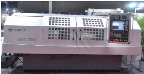
面粗糙度 $R_a=0.8\mu\text{m}$ 。卧式布局, 砂轮架移动数控切点跟踪磨削方式, 一次装夹完成曲轴主轴颈和连杆颈的外圆磨削, 滚动轴承支承内装式力矩电动机工件主轴, 滚动轴承支承砂轮主轴, X轴闭式静压导轨直线电动机驱动, 固定式顶尖, 金刚滚轮修整器, 液压中心架。
