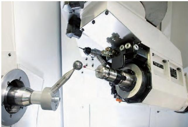
图9 在一摆一转结构的五轴机床上矫正五轴参数
