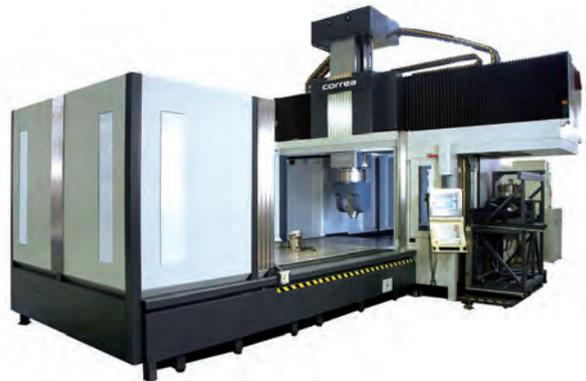
(14) 北京北一机床股份有限公司XKAS2525×60五轴联动高速高架横梁移动龙门加工中心。中国首展,工作台尺寸2 500mm×6 000mm,龙门通过宽度
