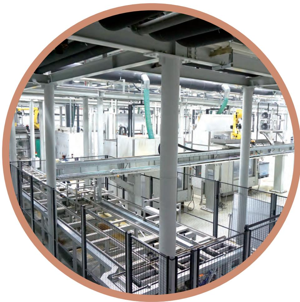
从铸件到最后的可视化检测，共有7个生产步骤，已经实现了高度自动化，整条生产线上目前仅有两个工位需要人工
