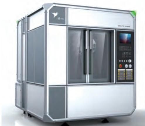
i5M1.4机床是针对消费电子行业开发的智能高速钻攻中心，主要用于手机、平板电脑等消费电子类产品的外壳、中框、按键等小型金属零部件的铣削，该产品将先进的机械设备同数控系统完美融合，在满足高效、高精、高表面粗糙度加工要求的同时，还搭载了智能操作、智能编辑、智能诊断、智能管理（车间信息系统/手机i平台）等一系列独有的智能化功能。
