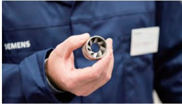
图为采用3D打印技术制造的燃气轮机旋流器
