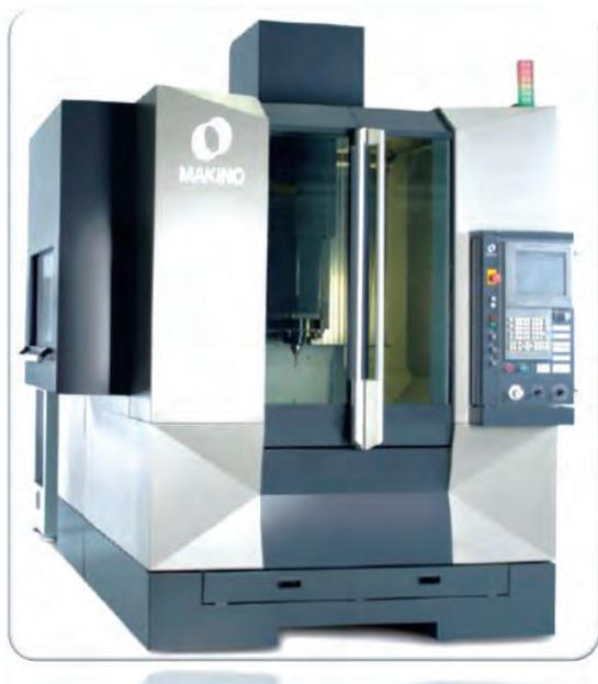
(3) 牧野机床(中国)有限公司D800Z五轴立式加工中心。中国首展，X/Y/Z轴行程1200/1100/650mm，X/Y/Z轴快速36m/min，B轴摆动角范围0~93°，C轴360°连续，最大工件尺寸 $\phi 1000 \times 550\text{mm}$ ，工作台最大承重1200kg，主轴最高转速14000r/min(20000r/min可选)。2个旋转轴马达直驱，中心冷却滚珠丝杠。独特的“Z”形摇篮式可倾转工作台(非传统悬臂梁设计)，确保工作台和工件的重心总是落在B轴和C轴的旋转中心，而不受倾斜角度的任何影响。配有新一代超级几何智能控制专利(SGI.4)软件，专门用于高速、小公差复杂三维模型中微小程序段的处理加工，有助于复杂型腔、型芯和航空航天零件的高速高精高效加工。机床具有可基于刀尖编程及路径优化的TCP控制功能。机床特别适用于模具和航空航天领域精密零件的加工。
