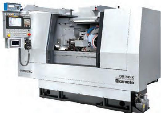
(17) 冈本工机(常州)有限公司PSG52CANC数控精密成形磨床。工作台尺寸550mm×200mm, 工作台上表面到砂轮下面距离395mm, 砂轮尺寸(外径×宽×内径)180mm×13mm×31.75mm, 砂轮主轴功率2.2kW。高刚性低悬垂直柱结构, 2轴闭环控制, 对话式编程软件含有凹槽磨削、复合磨削、轮廓磨削等常年积累的工艺经验, 所附附件进一步提升凹槽加工精度。
