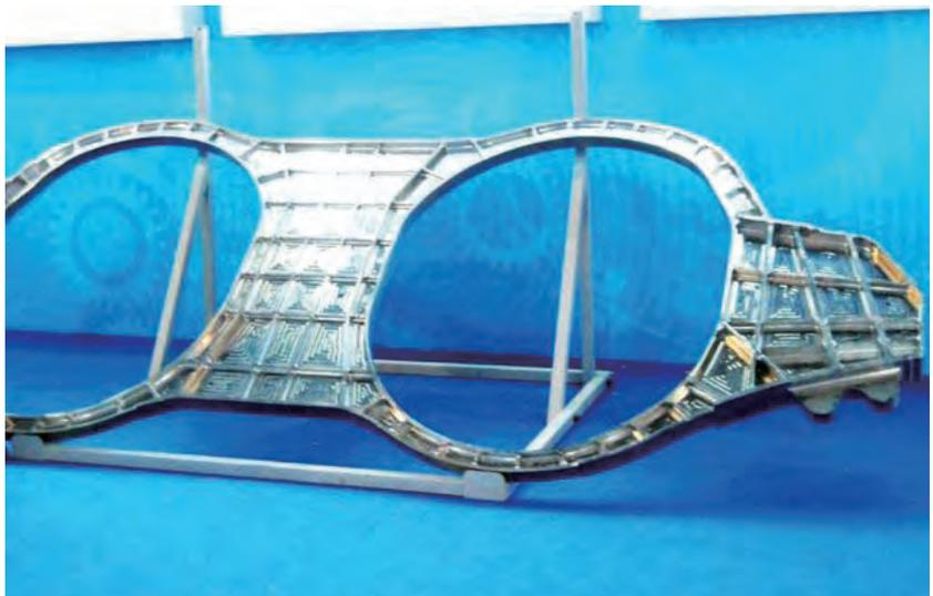
3D打印钛合金零件
