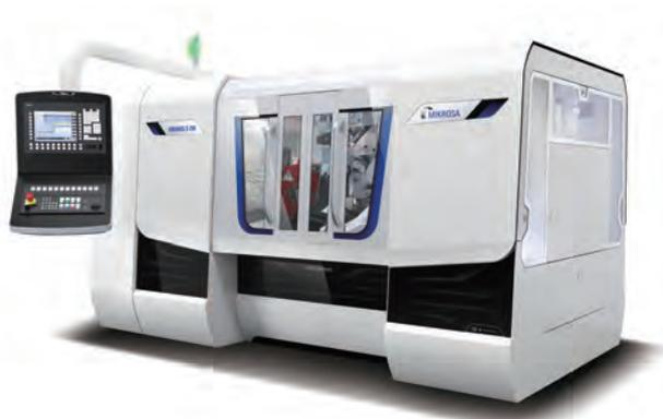
MIKROSA米克罗莎KRONOS S250；KRONOS S250机床为中、小型工件加工提供了最佳精度。其广泛的应用领域涵盖了小型喷油嘴、油泵活塞以及重型轴类零件的加工。此机床的特点包括可大批量生产，多工件同步磨削，砂轮偏置。砂轮和导轨侧的十字滑台系统给磨削操作带来了巨大的柔性。KRONOS S的设置方案是专门为刚玉和CBN磨削技术的应用而设计的。
