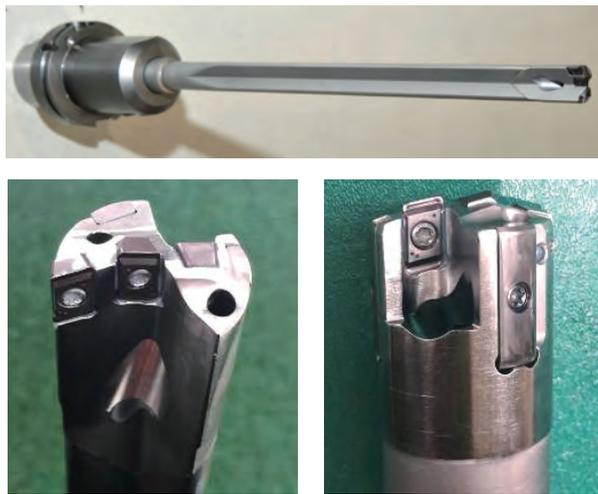
图6 优化后转位刀具及切削部位
