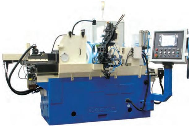
(10) 新日本工机株式会社HM4数控镗珩磨复合加工机床。工作台面尺寸 $420\text{mm} \times 700\text{mm}$ ，加工直径范围10~60mm，主轴转速范围1000~8000r/min，工作台最大承重300kg，主轴锥孔：BT40，X/Y/Z轴行程560/410/400mm，X/Y/Z轴快速5000mm/min，Z轴最大珩磨速度20m/min，刀库容量16把。可在一台机床上通过一次装卡实现高精度镗铣和珩磨复合加工，配有珩磨软件，可广泛用于RV减速机、液压泵阀和发动机等行业。
