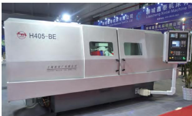
削，配有动平衡装置的滚动轴承砂轮主轴，滚动轴承支承的具有C轴功能的直驱工件主轴。
