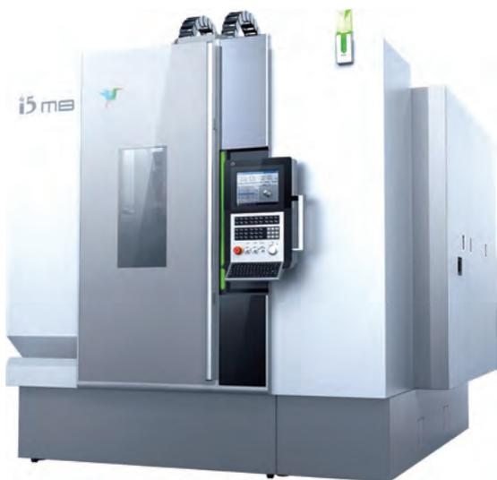
为平台智能型机床, 数控系统i5, 具有网络、智能校正、智能诊断、智能控制、智能管理等功能, 是企业智能制造的标志性产品。模块化设计, 具有单轴转台、双轴转台、车削主轴、车铣主轴、伺服刀塔、动力头等多种模块, 可根据客户要求快速衍生出四轴、五轴联动立加, 卧式车铣、立式车铣、倒立车等多种加工中心。机床整体为门式结构, 各轴采用直驱技术。
