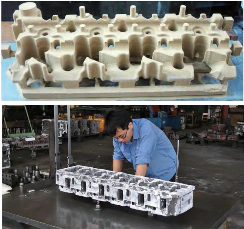
图2 装配后整套六缸发动机缸盖砂芯和铸铁六缸发动机缸盖
