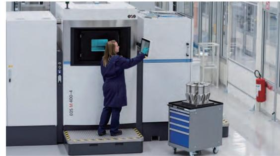
图为Finspong工厂内的3D打印车间。在这里，几台选择性激光熔化（SLM）机器利用金属粉末，逐层制造出新燃烧器。
