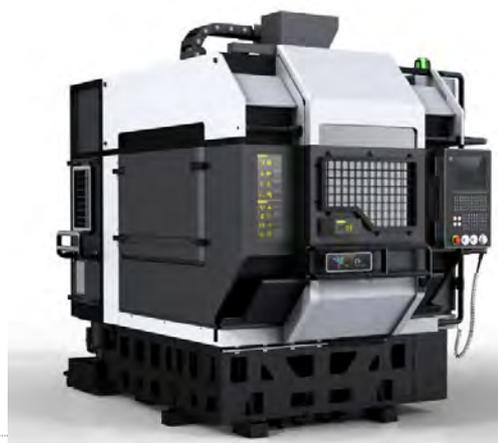
HoriTurn4080MY是一款最新与德国工程师合作开发的数控车床。机床主要功能部件选用了大量在世界范围内处于领先地位的优质供应商。在整机设计过程中，利用有限元计算等手段确保机床在大扭矩切削的情况下仍保持很好的精度。尾座及中心架的定位锁紧机构简单、成本低，其特点是采用通用化策略，灵活、模块化且便于维护。机床卧式车削操作，斜床身保证排屑顺畅。与竞争对手相比占地面积小，利于工厂规划。
