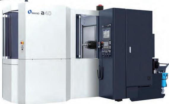
续),  $B$ 轴 $360^\circ$  (0.001°分度),  $X/Y/Z$ 轴快速60m/min。一款专为铝及铝合金压铸加工而设计的卧式加工中心,旨在减少加工中非切削时间的R.O.I.设计,主轴从静止加速到12 000r/min只需0.45s,刚性攻丝转速6 000r/min,刀具破损检测、刀库门开合宽度智能调整,惯量智能控制(IAC),专家控制系统及GI.5控制。
