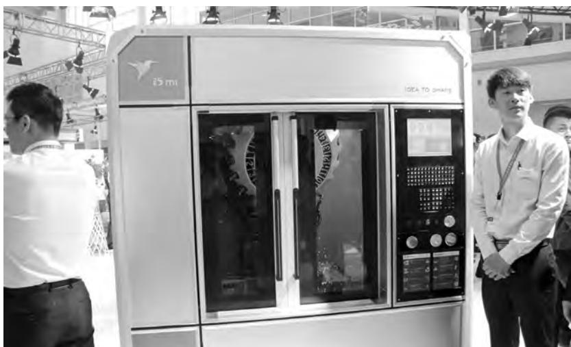
沈阳机床股份有限公司i5 M1智能高速钻攻中心为全球首展。i5M1智能机床率先采用蒙德里安风格全铝防护间的概念化设计，通过简约的线条与几何图形延伸交叠，呈现出轻盈、辨识度更高的模块化外观，给人以独特的视觉体验，与其面向的3C行业更加契合。整体采用全铝材质，有效地避免粉尘及油气外溢，减少环境污染，使排屑更容易，开门更自如，安装更简单。
