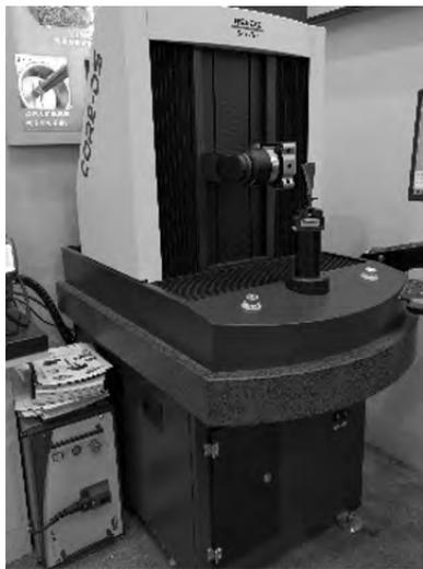
图19 温泽公司的叶片测量仪
