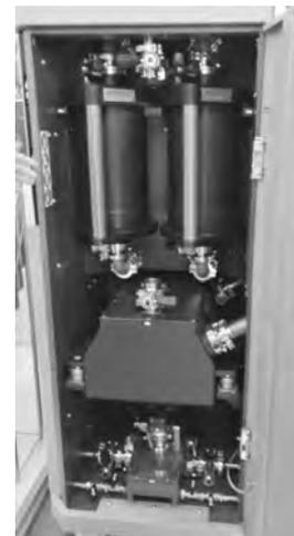
图16 雷尼绍公司的粉末循环利用系统
