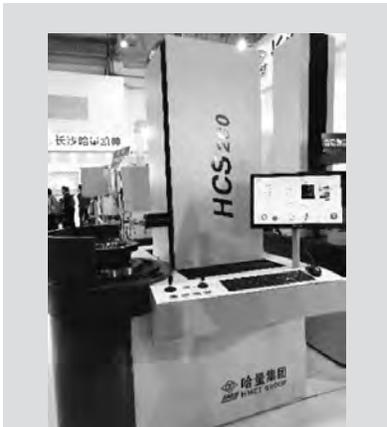
(b) 硬齿面螺伞加工刀盘调刀仪
