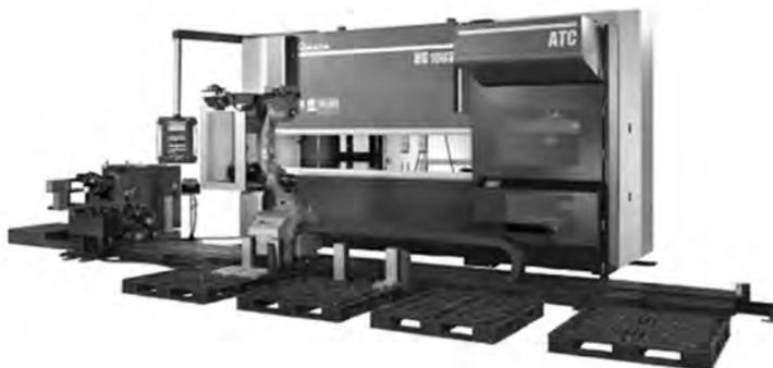
▼自动化折弯机，本次展出的折弯机+机器人系统HG-1003ARS，可应对多品种可变批量的生产场合，并实现长时间自动运转。采用7轴关节机器人和1台折弯机可实现上下料、夹持工件等一系列操作，复杂钣金形状也能实现高品质的加工。另外，通过无需示教的编程和自动加工前准备技术，减少折弯加工的加工前准备时间。
