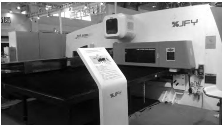
金方圆数控转塔冲床及上下料单元
