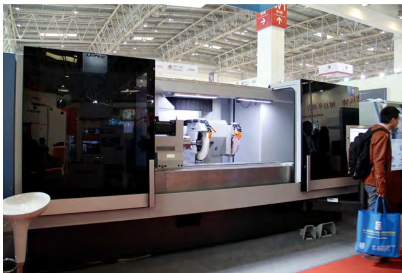
哈挺中国有限公司KELLENBERGER VARIA 高精度数控万能外圆磨床为中国首展，顶尖距 $1000/1600\text{mm}$ ，磨削长度 $1000/1600\text{mm}$ ，中心高
