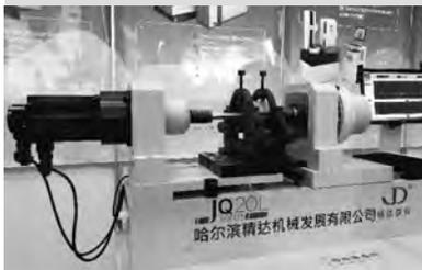
(b) 齿轮传动装置综合检测仪
