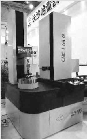
(c) 高精度螺伞齿轮测量仪
