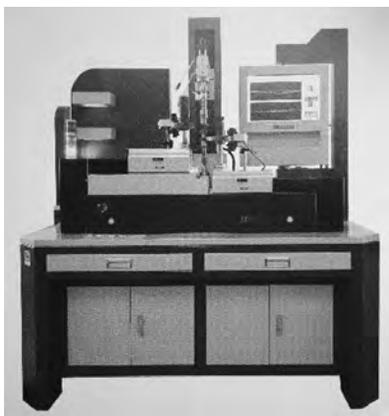
图13 哈尔滨创博的三轴齿轮双面啮合检查仪及局部图
