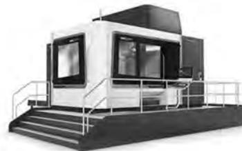
▼ULTRASONIC 20 linear 2nd Generation，除了普通的切削功能以外，还通过超声波振荡实现高精、高速和高效的磨削功能。可实现从金属材料到难切削材料（陶瓷，碳化物材料等）的广泛高精度加工。
