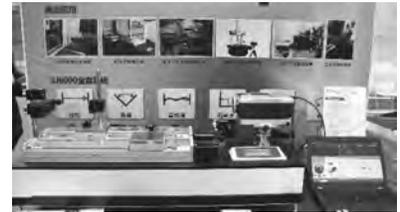
图17 深圳中图SJ6000激光干涉仪
