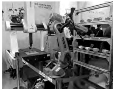
图9 西安力德自主研发的车间自动化智能测量系统
