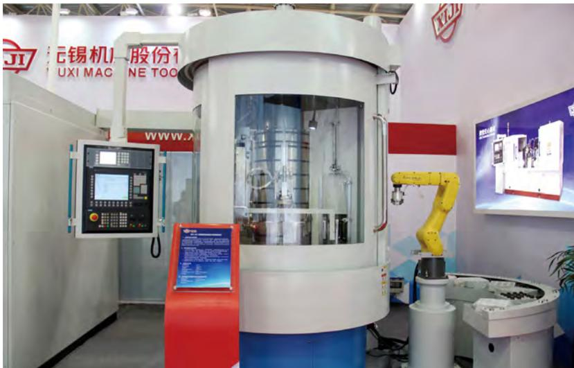
无锡机床股份有限公司WX-6013数控高精度内凹端面磨床为中国首展，填补了国内空白。其内凹端面深度 $\leq 50\text{mm}$ ，砂轮主轴转速 $10000\text{r/min}$ ，工件转速 $3000\text{r/min}$ ，数控系统为西门子840D控制系统，四轴两两联动。工作精度（以磨削喷油器体为例）：端面平面度 $0.0009\text{mm}$ （带内凹），表面粗
