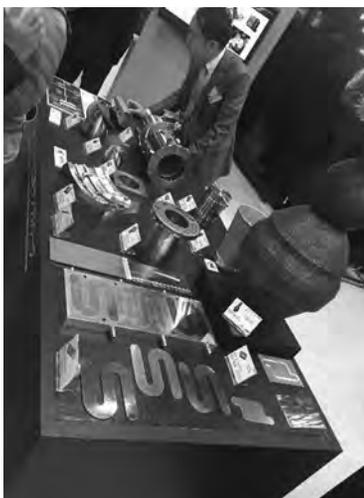
另一个显著展示特点就是基于用户解决方案的制造技术和机床展品的有机结合。比如，在应用前景比较火爆的增材制造和高效加工复合的展品和成果方面，MAZAK公司除了展出新升级换代的展品和技术以外，还将这个领域取得的最新制造样件集中展示。在增材制造技术方面，除了喷粉激光融覆的方式以外，为了提高经济性和适用面，还最新推出金属丝供料的激光堆焊的方式，与高效加工结合的复合加工机床在轮胎模具制造领域的应用前景比较广阔。
