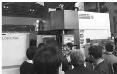
▼MULTUS U5000智能复合加工机床，最新推出的车铣复合加工机床，面向中大型规格零件及难加工材料的强力加工场合。工件主轴：3000r/min、37/30kW、1413N·m；刀具主轴：12000r/min、22/15/11kW。机床还集成了在机测量和齿轮加工功能，其中在机测量可通过安装测量头实现在机三座标测量和粗糙度测量，操作直观、自动化高，无需编写代码程序。
