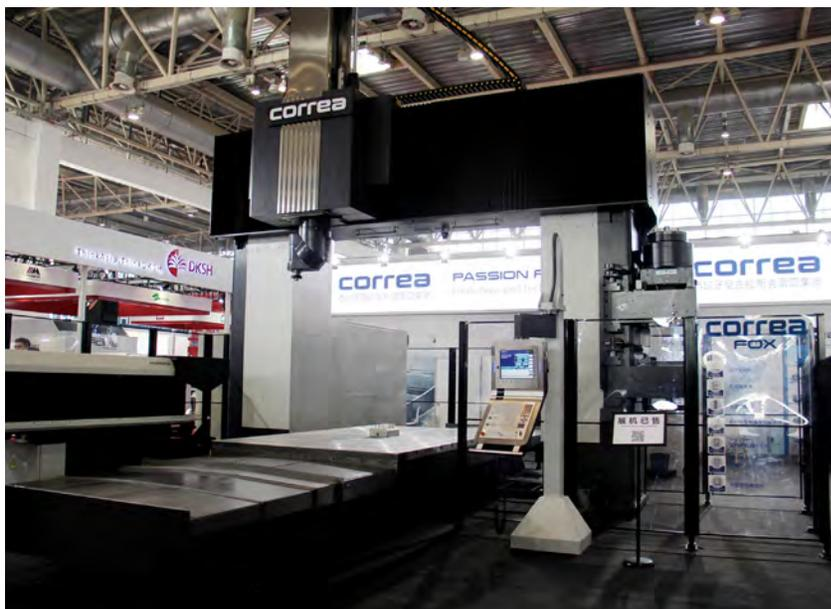
西班牙尼古拉斯克雷亚集团公司FOX-30数控定梁龙门式五轴五联动加工中心为中国首展，其工作台尺寸3500mm×2000mm，龙门通过宽3250mm，X/Y/Z轴行程3000/3750/1500mm，同时配备两个铣头及自动换头系统，万能回转式自动微分度铣头37kW，转速6000r/min，电主轴式五轴联动铣头功率60kW，转速20000r/min刀库容量40把。设计采用不同技术方案提高结构刚度和精度，框架结构尺寸具有良好的刚度和阻尼性能，驱动系统及运动机构保证了高精度和良好的动态性能，可选配多种附件和铣头，具有广泛的通用性，满足各领域粗精加工需求。
