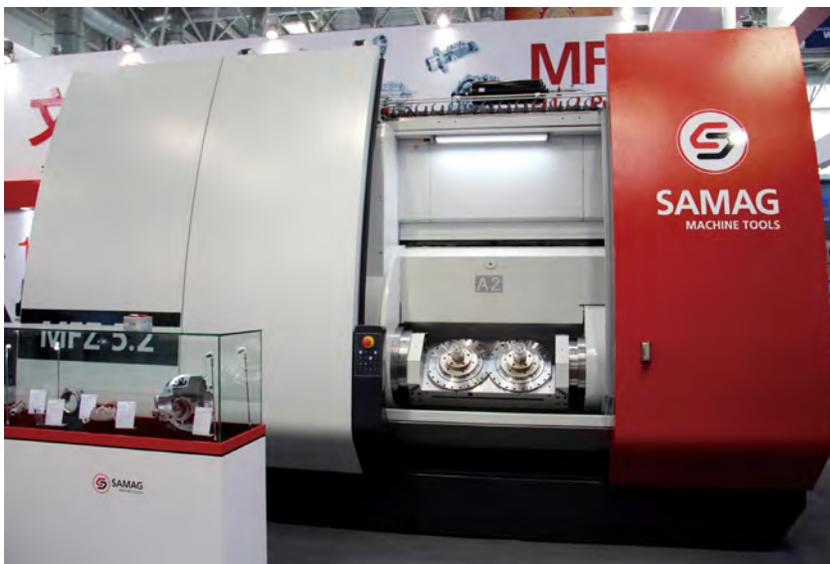
德国萨玛格萨尔费尔德机床有限公司MFZ 5.2双主轴卧式加工中心为中国首展。其主轴间距180~840mm，X/Y/Z快速100m/min，刀库容量72把，最大容量可达160把，换刀时间2.4秒。模块化多主轴设计理念，整体大理石床身，门式垂直Y轴双驱动机构（双进给驱动），三直线轴绝对测量系统，电机直接驱动B轴，切屑自由掉落。适用于中、大尺寸铝合金、铸铁和钢质材质零件批量生产。
