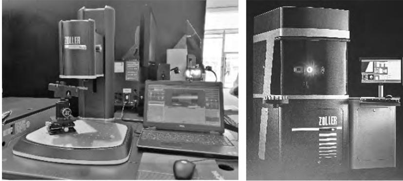
图24 Zoller手动刃口检测仪和全自动高端精密刀具检测仪Titan
