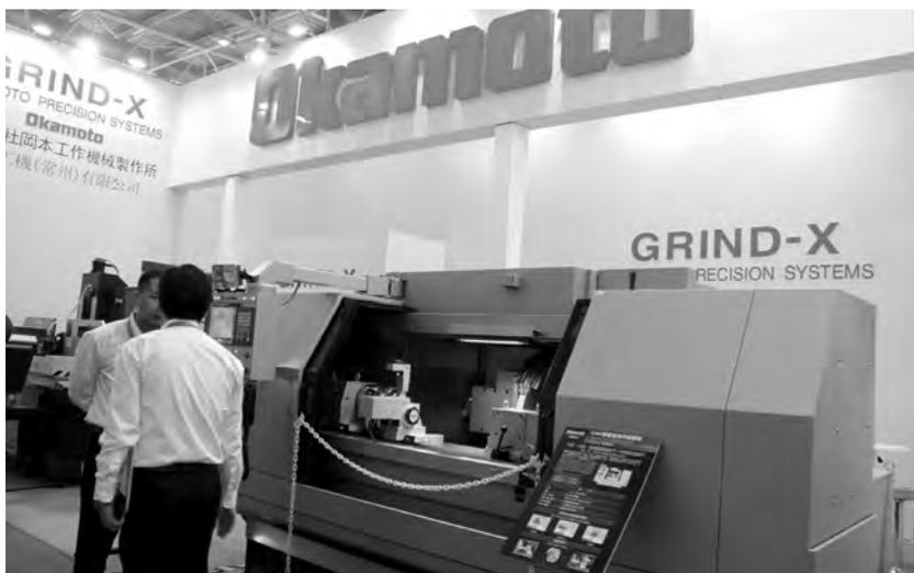
冈本工机（常州）有限公司UGM 3100NC精密复合外圆磨床为中国首展，是集外圆、内圆、端面磨削结合于一身的复合磨床。欧洲主流的单次装夹加工外圆、内圆、端面的复合磨床。有效减少由于工件装夹时产生的装夹失误、大幅缩短工作时间、降低工厂占有率等优势。另外，也有能够对应长尺寸工件的型号，顶尖距离可达1000mm（斜进规格为870mm）。
