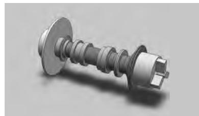
图5 主轴部件简化结构
