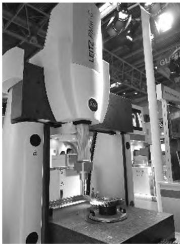
图22 Leitz坐标机测量叶轮
