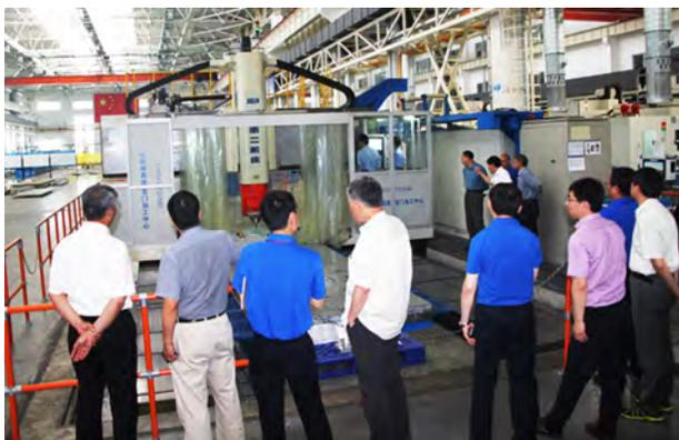
“高速龙门五轴联动加工中心”课题是济南二机床通过验收的第9个04专项项目，也是工信部对JIER五轴机床产品研发和市场应用的认可和滚动支持。设备配备了济南二机床自主研发的双摆角数控万能铣头、国产高速滚珠丝杠等功能部件以及国产五轴联动数控系统，能够完成大型
