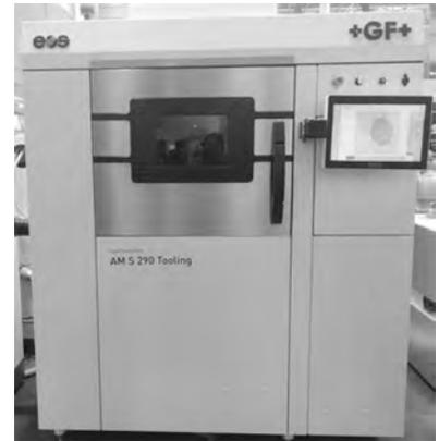
图18 EOS与GF合作推出的AM S 290 Tooling设备
