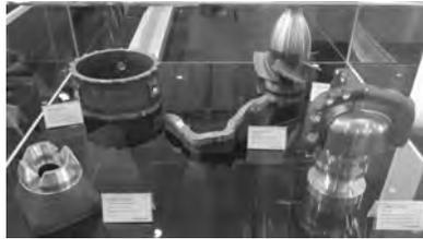
图17 德马吉公司LaserTec 65 3D机床增减材加工的零件
