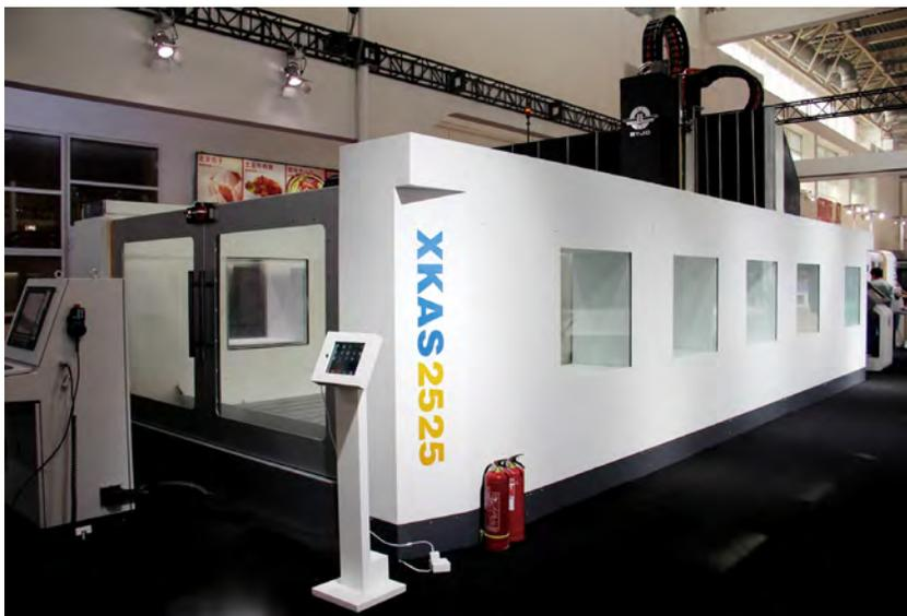
北京北一机床股份有限公司XKAS2525×60五轴联动高速高架横梁移动龙门加工中心为中国首展，其工作台尺寸2500mm×6000mm，龙门通过宽度3180mm，工作台单位承重2500kg/m<sup>2</sup>，X/Y/Z轴行程6200/2500/1000mm，A/C轴摆角范围±105° / ±360°，滑枕截面尺寸500mm×500mm，X/Y/Z轴快速45m/min，电主轴最高转速18000r/min，直线轴定位精度0.012mm，重复定位精度0.006mm。轻量化高刚度龙门框架设计，静压导轨和静压蜗母牙条传动，平面地基安装，无需考虑地坑，结构紧凑，占地面积小。
