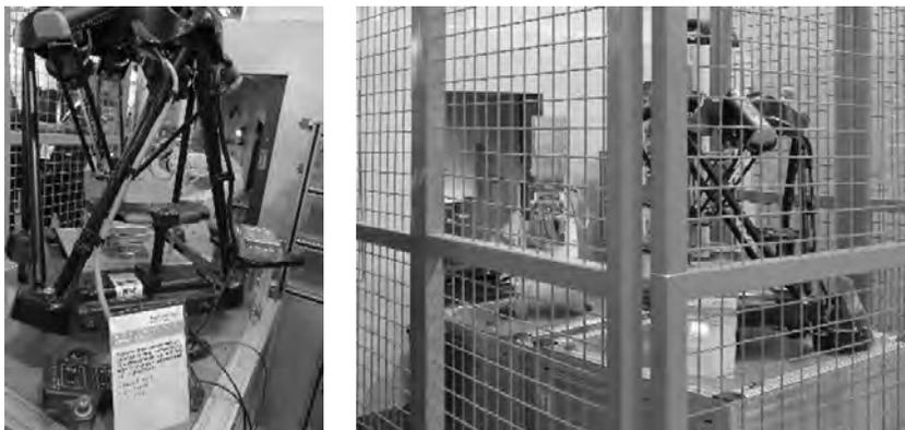
图8 雷尼肖展出的带刀具自动测量补偿的车间智能加工系统
