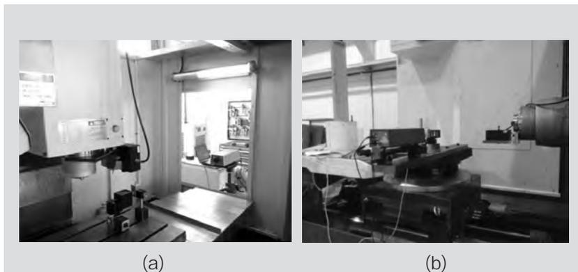
图15 六维激光测量系统对普什宁江立式、卧式加工中心的多维参数测试
