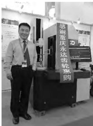
图11 智达3D测头齿轮测量中心
