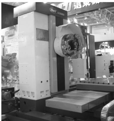
(1) 该机床的总体布局为立柱固定，主轴箱侧挂在立柱上沿立柱导轨上下移动，镗轴可轴向移动，工作台可实现纵、横向移动并可进行回转的卧式台型镗铣加工中心。
