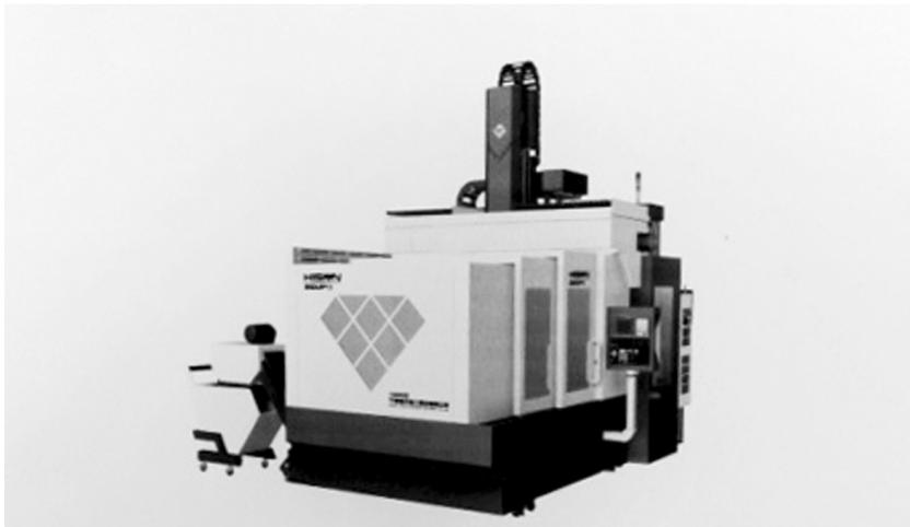
该机床为龙门框架固定，横梁固定在龙门框架上，滑枕座在横梁上左右移动，滑枕在滑枕座上上下移动，工作台在床身上移动的数控龙门镗铣床。
