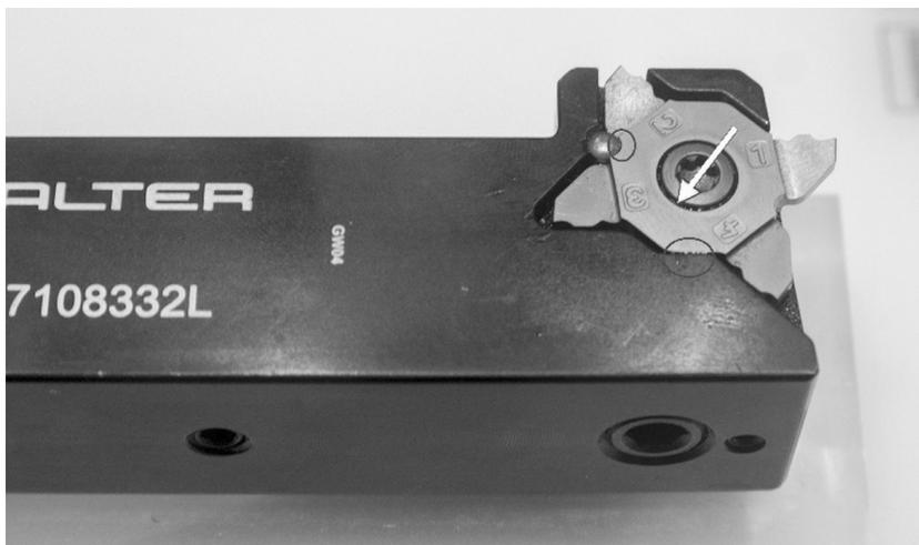
图8 瓦尔特刀具4刃切槽刀
