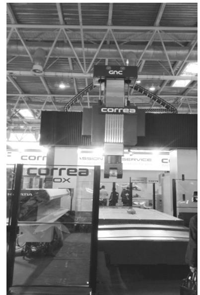
该系列机床的主要技术参数：工作台宽度：2000-2500，工作台长度：3500-4500-5500-6500-7500-8500；工作台承重：15~25t；加工范围X/Y/Z：3000-4000-5000-6000-7000-8000/3000-3750-4250/1000-1500；两立柱间距离：2500-3250-3750；主轴到工作台的最大距离：1500；6 X/Y/Z各轴的快速进给速度：25m/min；主轴最高转速：6000r/min，主电机功率：37kW；最大扭矩：1375N·m。
