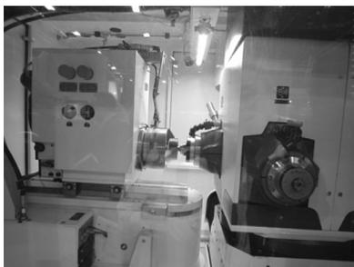
MS16车床设有六轴，可加工直径16mm的部件，其优势在于将凸轮控制与数控技术的灵活性融为一体，在保持高效精密的同时，提升柔性化加工水平，与凸轮控制车床相比，能耗更低，设计更紧凑(1300 mm宽，2600 mm长)，加工方式也更加多样化。
