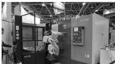
KTC 5000是一台带背主轴的斜床身车削中心，床身上回转直径600mm，主轴转速(主/背) 2500/4200r/min，主轴端部尺寸(主/背) A2-11/A2-8，数控系统是发那科32i系统。
