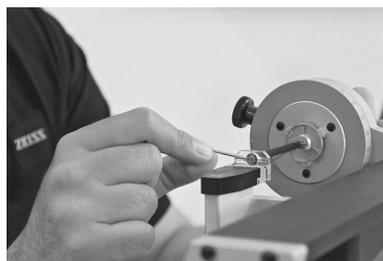
为了最大限度地减少测针与工件之间发生昂贵和费时的碰撞风险，Schwab建议使用一种额外的辅助工具：组装探针使用的角度调整装置。蔡司的FixAssist XXT 和 FixAssist VAST设置装置能够使测量工程师在组装测针系统时半功倍，更容易、更快速组装探针系统。它们不只是防止碰撞。因为测针系统不必在机器上
