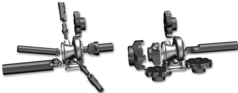
图49 方寸工具涡轮壳加工方案
