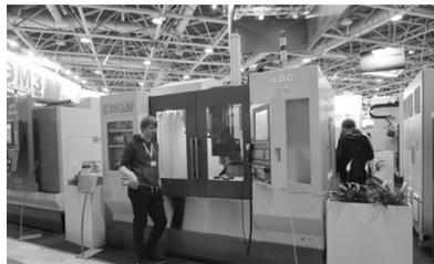
KBC B4的工作台尺寸480×1200mm，行程(X/Y/Z) 1050/540/560mm，主轴转速12000r/min，主轴规格BT40，数控系统是发那科Oi系统。
