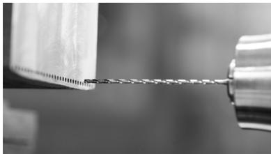
图28 玛帕用于小直径的深孔钻头
