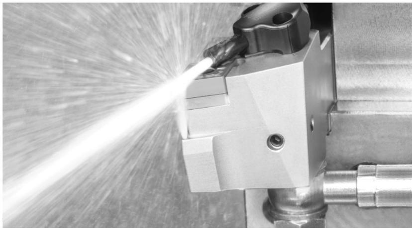
图7 泰珂洛双通道高压内冷却系统TungTurn-Jet
