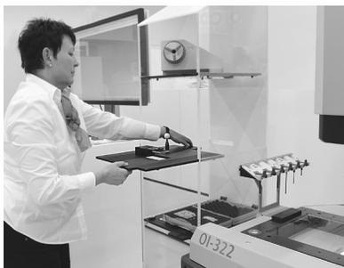
Schwab知道，即便使用拥有最合适探针系统的高性能测量机，质量保证也可能成为一个瓶颈。一个可能的原因是，在加载工件时，坐标测量机总是要停几分钟的时间。不管是一系列的手机外壳或传感器，都可能需要几分钟的时间进行加载，特别是需要在同一时间安装多个工件时。当测量不同的工件，需要操作者频繁更换夹具时，也会花费大量的时间和精力。
