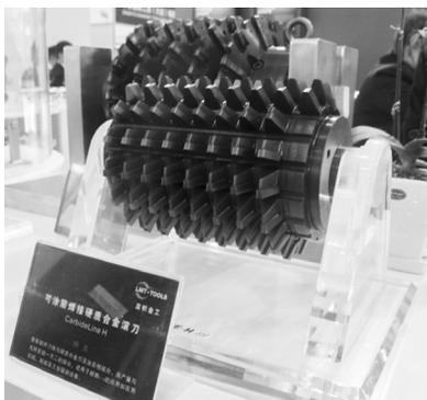
图39 蓝帜可涂层硬质合金齿轮滚刀
