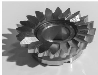
图36 汉江工具开发的车齿刀
