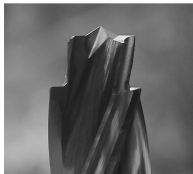
图47 錾玛贯穿孔加工（带有台阶）的破孔钻
