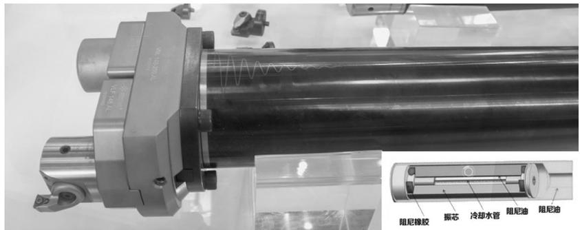
图31 松德的桥式减振镗杆及其原理
