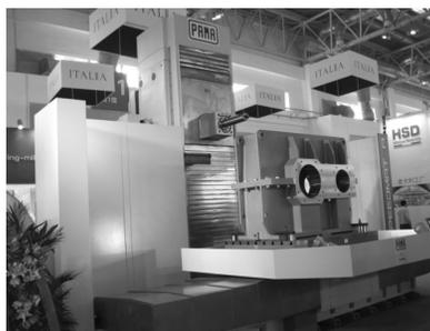
(1) 该机床的总体布局为纵、横向床身呈T字型布置形式，分别支撑工作台和立柱的运动，主要部件采用铸铁材料，具有良好的刚性和吸振性。立柱设计为小龙门框架式对称结构，主轴箱正挂于龙门框架内上下移动，使机床具有较高的刚性和良好的热对称性。镗轴可轴向移动。
