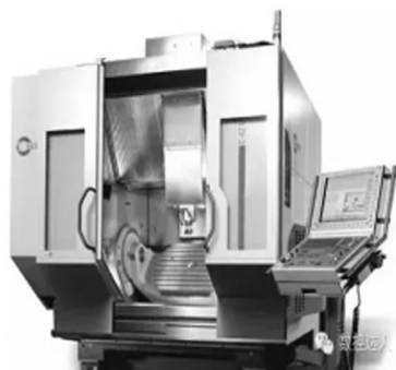
典型代表1：德国哈默全功能的5轴数控高性能C42U动态加工中心
