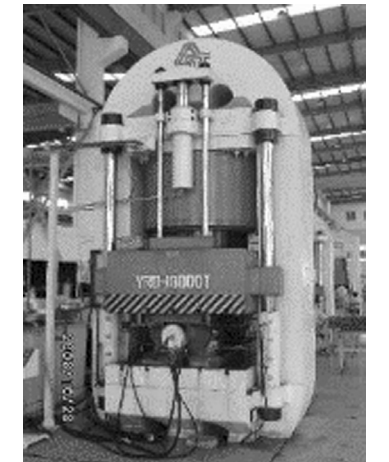
图7 10000T管材充液成型机及其所配置的超高压源
