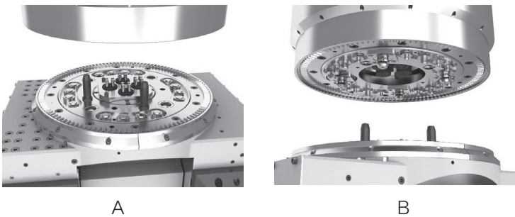
图6 A轴自动交换标准接口（A轴接口与C轴接口）
