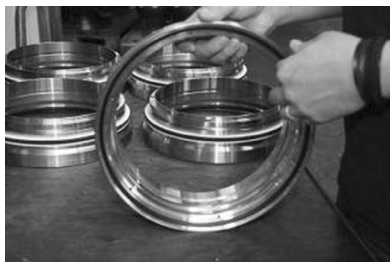
图3 金属和塑料座圈能满足高压球阀密性要求
