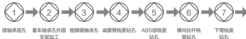
图2 转向节加工工艺流程
