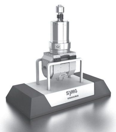
图1 直驱式A/C轴双摆角数控万能铣头外观图
