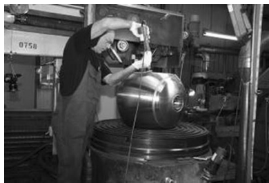
图1 阀芯在RMA磨削车间磨削处高亮表面。采用瓦尔特玉米铣刀，可沿槽加工倒角
