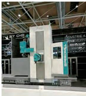
在展会上展出的是PAMA SPEEDMILL 卧式落地铣床,它是由立柱刀架部件和刀库组成的产品模型。PAMA SPEEDMILL卧式落地铣床系列包括三种基本型号,既SPEEDMILL 1000、SPEEDMILL 2000、SPEEDMILL 3000。该机床采用主轴直接驱动,用于高速加工,垂直行程可达4000 mm,滑枕行程可达1600 mm。主要参数
