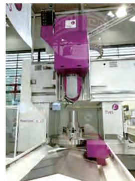
高精度、大转矩和高转速主轴、大流量高压冷却液系统，主要用于飞机结构的复杂零件的粗加工或精加工。主要参数为：工作台(托盘):直径1600mm，承重：5000kg。行程(X/Y/Z): 1950/2000/1000mm。铣头摆角(C/A): $N \times 360^\circ \pm 110^\circ$ ；主轴：电主轴HS5；最大功率(S1): 105kW；最大转矩(S1): 1000 N·m；速度:10000r/min。
