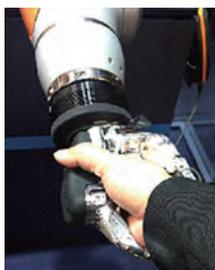
SCHUNK公司的五指机械手，模仿人手结构（分左右手），由9个电机驱动20个关节运动，可用于模仿人手的服务型机器人应用环节。目前有4种使用模式：握手模式、握钥匙模式、精密握持模式（如拿针），强力模式（使用手电钻打孔）。亲测握
