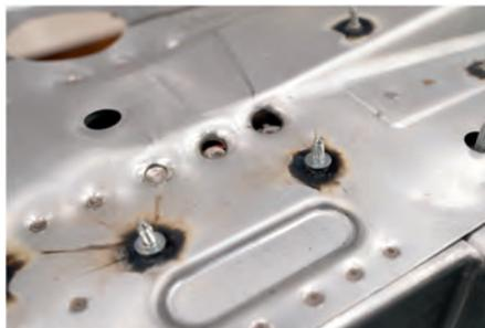
了三种测量原理（多线三角测量、灰度图像处理以及阴影分析），对车身制造来说是又一大优势。这三种测量原理使得蔡司系统可以测量复杂的几何特征，如特殊的钻孔、孔、螺纹、焊接螺母、间隙和面差。“焊接的螺母，我们有很多，但只能用ZEISS AIMax进行在线测量。数字摄像技术具有高分辨率和灵活的照明控制，可在各种情况下实现最佳照明，确保所评估的特征获得理想的对比度。例如：钣金下的螺母清晰可见。”已经熟悉俄罗斯大众工厂的蔡司系统的Steinert说，“得益于采用了适应性照明技术，可以测量不同的材料。这是一个重要的优势。”最重要的是，能够以闪电般的速度进行测量。ZEISS AIMAX的典型测量时间（包
