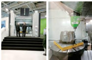
以及符合人体工程学的设计等特点。该机床可安装任何坚实的车间地面上,降低基础成本。FLEXTURN 25有2种结构形式:固定式横梁和移动式横梁(W轴)。主要参数为:车削工作台直径1600/1800/2000 mm,工件回转直径2500mm。转动功率60(120) kW,转动速度400/350 r/min,转动转矩21kN·m,车削高度1100(1400) mm。横梁移动1400(1700/2000) mm,(横梁-连续夹紧位置)W轴400(700/1000) mm。铣削功率30kW,铣削速度6000~10000r/min,铣削转矩939N·m。
