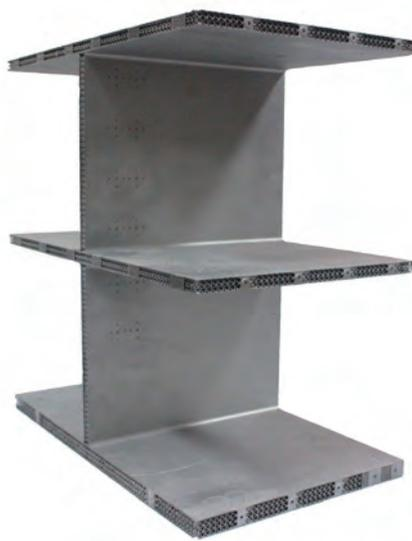
(图片：铂力特为中国航天科技集团五院总体部3D打印的微小卫星结构内部)
