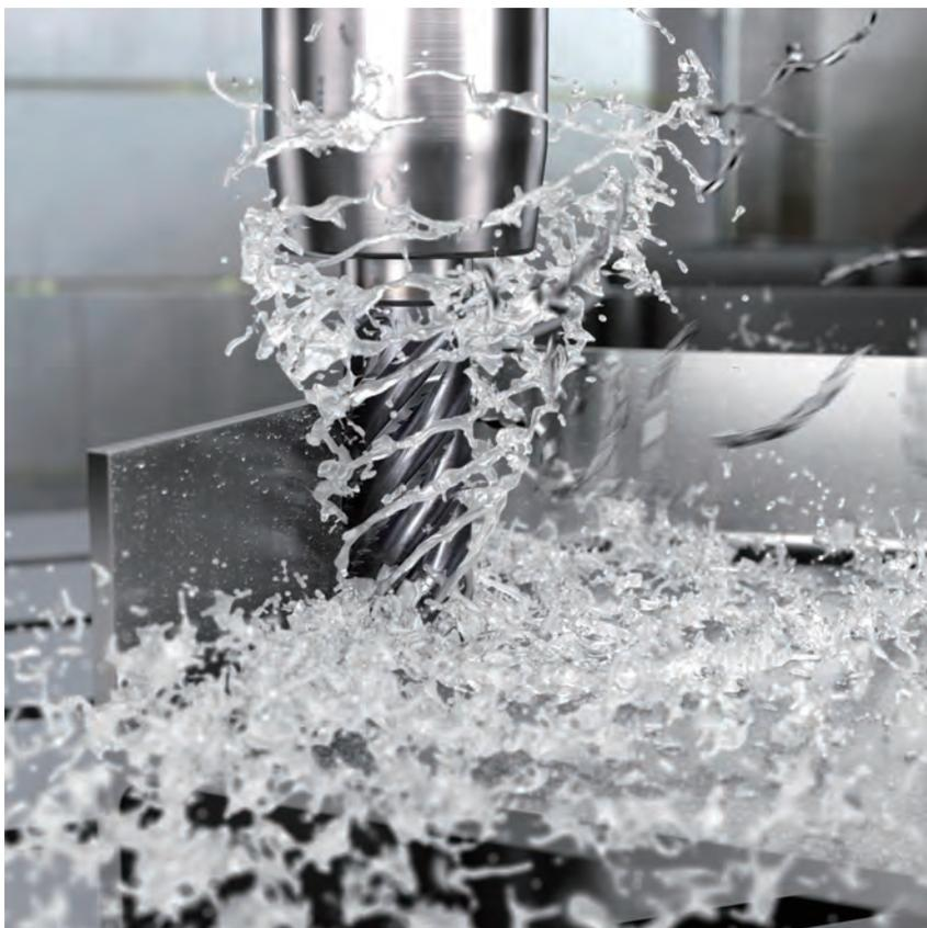
产品，端刃不过中心，具有不等齿距设计。此外，芯部尺寸经过优化，在钛合金加工中具有更高的刚性，而刀尖圆弧半径、前角和后角均专门针对这些苛刻材料的加工而设计。
