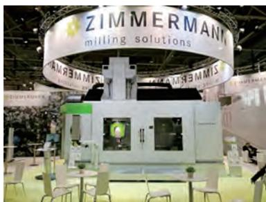
载荷为16t。F40紧凑型龙门工中心的8个底座元件减少了振动，这是工件高精度和最佳表面质量的基本要求。此外，侧壁填充特殊阻尼混凝土混合物进一步提高了机床性能。机床工作区域是完全封闭的，工作台为固定式。机床移动部分由增强型Z轴滑枕和结构优化的高架桥式龙门组成。配备新研发的叉型动态两轴铣头VH60，由于其整体铸造设计，具有非常高的温度稳定性。此外，振动和振动阻尼也减少到最小，保证了更精确的加工结果。高达102kW的功率和575N·m的转矩以及HSK-A100刀柄提供了最佳性能。A轴和C轴的无间隙驱动实现了精确的定位精度和重复定位精度。主要技术参数为：工作行程(X/Y/Z): 2400/2900/1250mm，工作台尺寸(长×宽×高): 2500mm×3250mm×600mm，工作台承载800kg/m(最大16000kg/m)，进给速度(X/Y/Z)60 m/min，加速度(X/Y/Z)5m/S。
