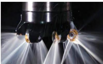
带内冷却结构的新型高性能刀具
