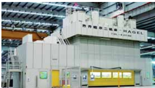
TDL-4 2500型多工位自动冲压生产线
