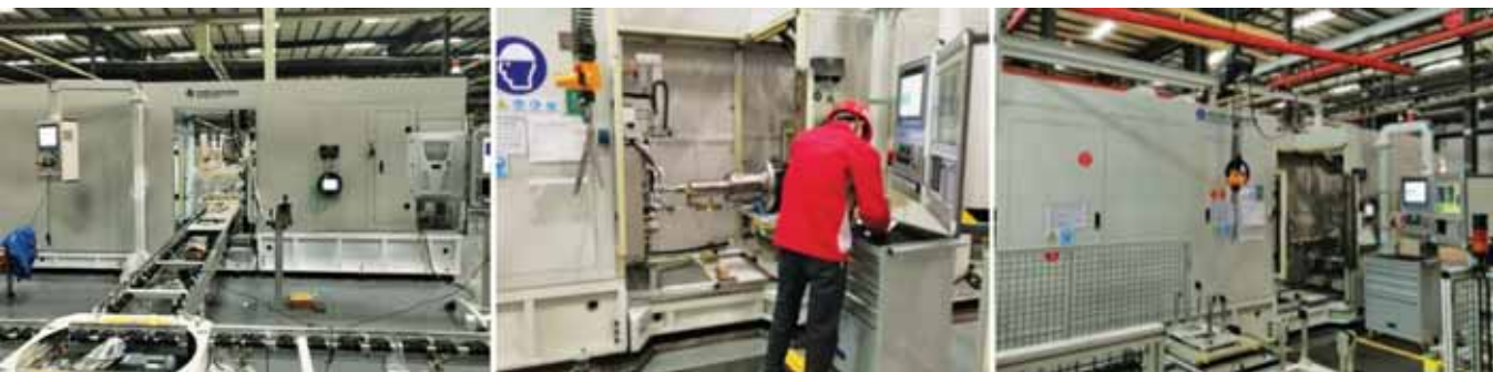
利用课题成果研发的 MT 和电动车变速器智能化在线检测试验设备
