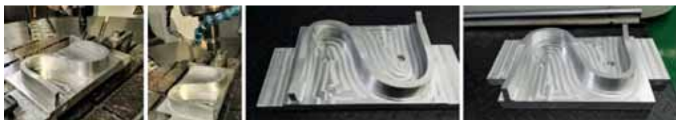
图 15 五轴国际标准 S 件切削测试终验收
