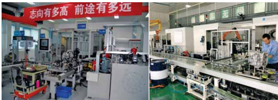
利用课题成果研发的 CVT 智能化在线检测试验设备
