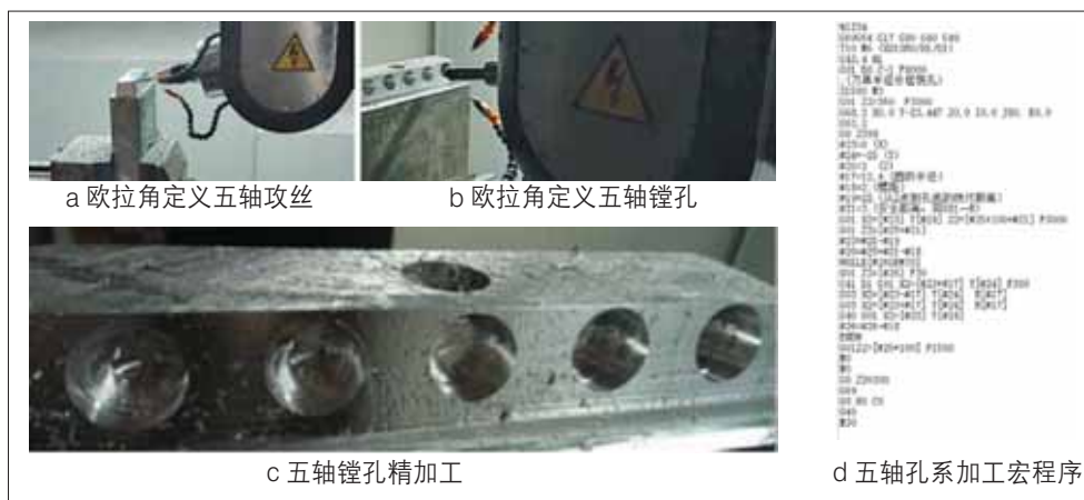
图 12 五轴孔系加工测试及其宏程序
