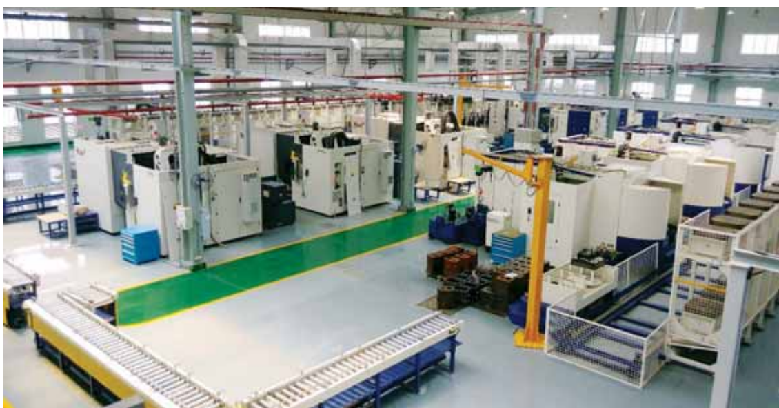
图 1 客户生产现场的变速箱壳体柔性生产线
