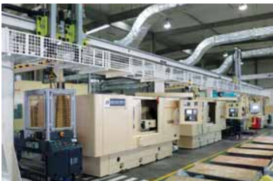
北京第二机床厂有限公司为上海拖拉机内燃机有限公司提供的发动机曲轴自动化生产线
