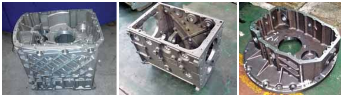
图2 变速箱壳体典型零件类型
