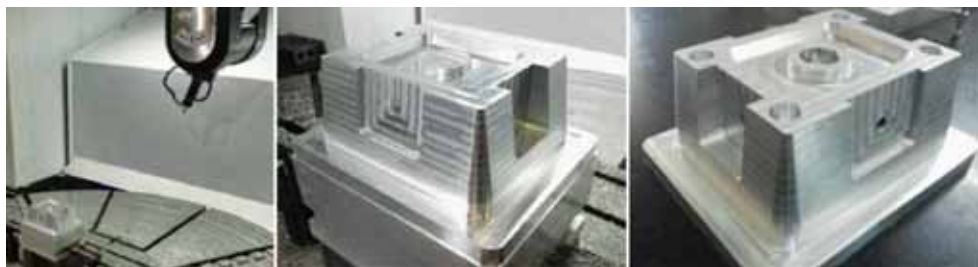
图 16 金字塔型件五轴综合测试切削终验收
