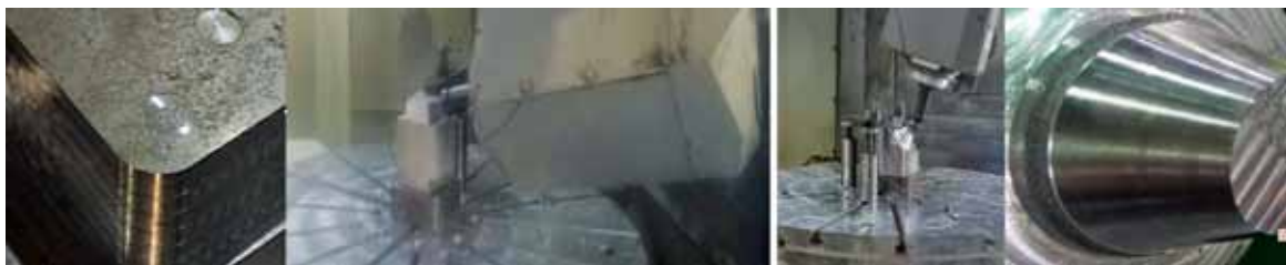
图 11 DMU125P 加工金字塔型件及 NASA 件对比测试
