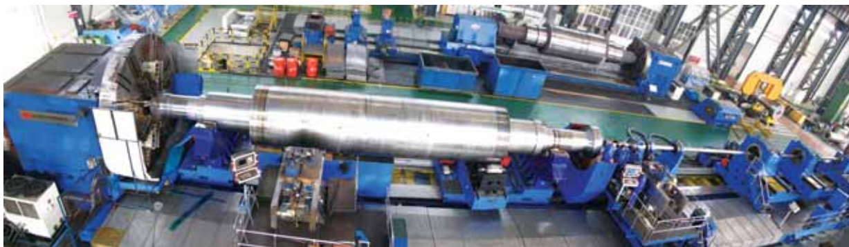
用于超临界核电半速转子加工的超重型数控卧式镗车床
