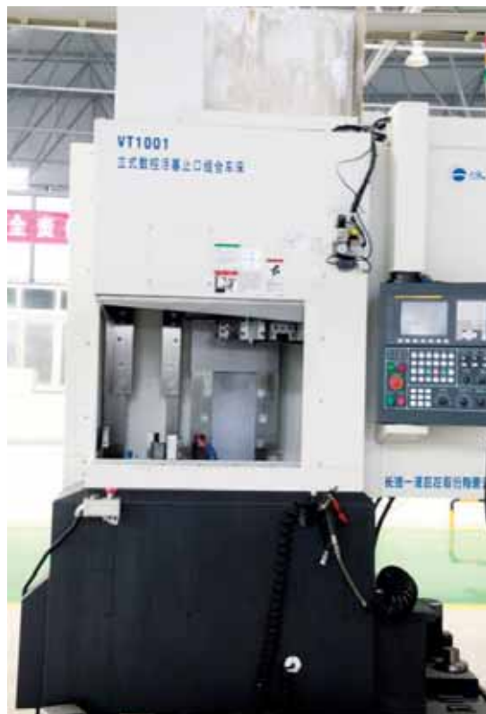
活塞生产线（山东双港活塞公司）上的数控活塞车床（长沙一派制造）
