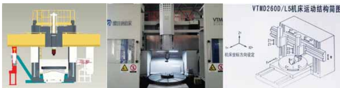
图 1 大型立式龙门车铣复合加工中心结构总图
