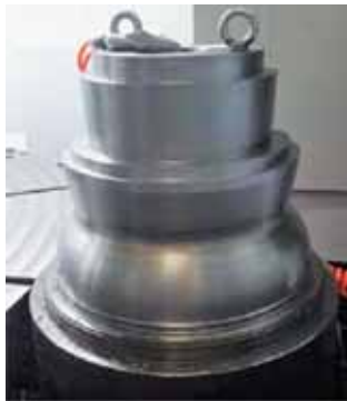
图8 数控立式车削标准件测试
