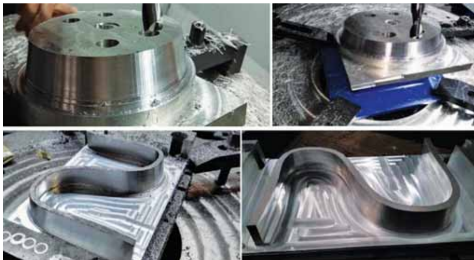
图 10 五轴联动侧刃铣削机床动态性能测试
