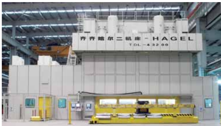
TDL-4 3200 型多工位自动冲压生产线
