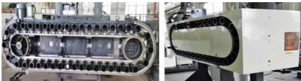
图4 国产高速刀柄精密链式刀库
