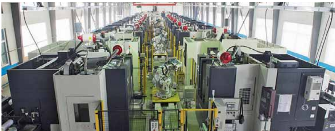
高硅铝合金无缸套发动机缸体加工生产线全景图
