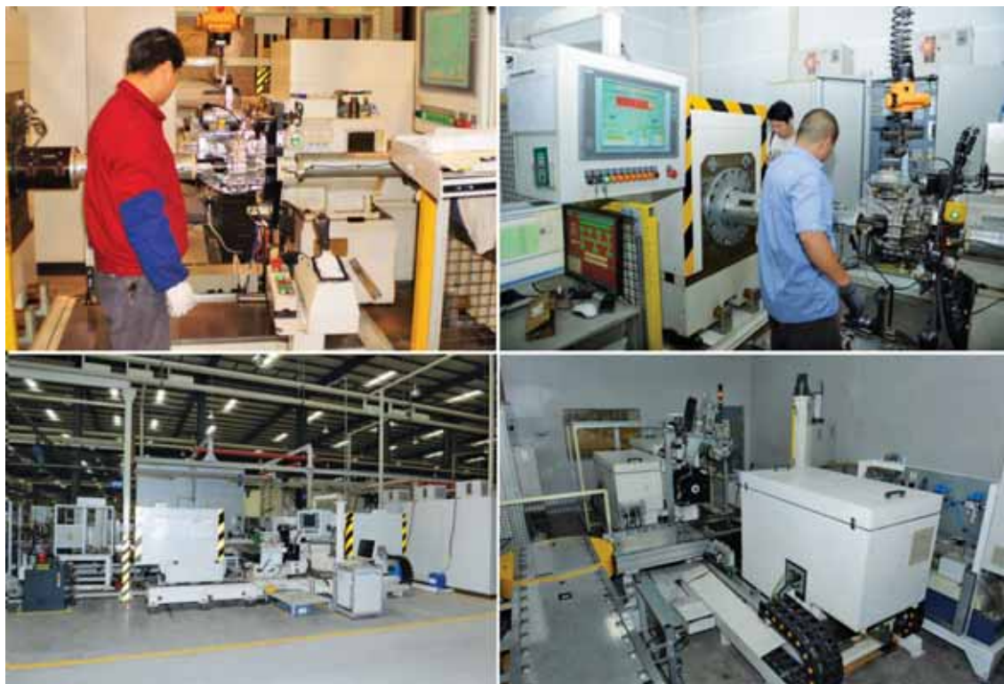
汽车 AMT 变速器总成智能化在线检测试验设备
