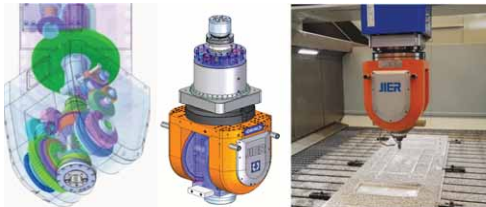
图3 力矩电机直驱双摆角AC铣头
