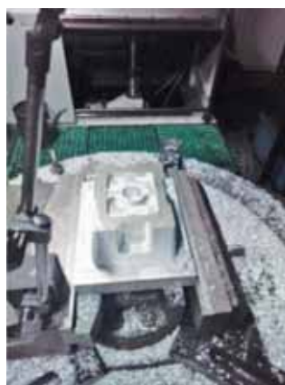
图 15 塔型件粗加工完成后
