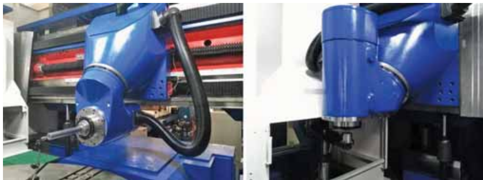
图 3 铣车复合立 - 卧式转换运动状态
