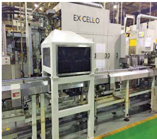
图3 燃烧室容积激光扫描测量系统
