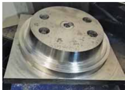
图11 国际标准五坐标 NASA 件试验切削
