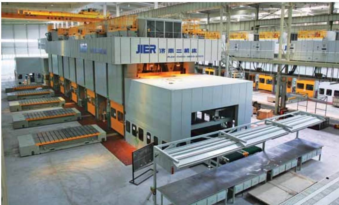
为奇瑞汽车提供的大型单臂快速冲压生产线
