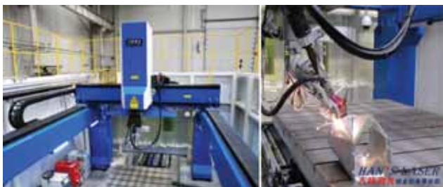
高架龙门大幅面高精度三维五轴联动光纤激光机床
