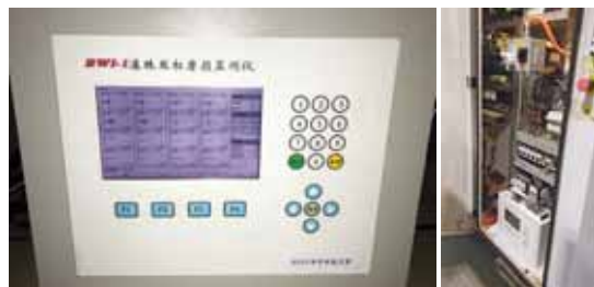
图 10 数控系统智能测控模块平台
