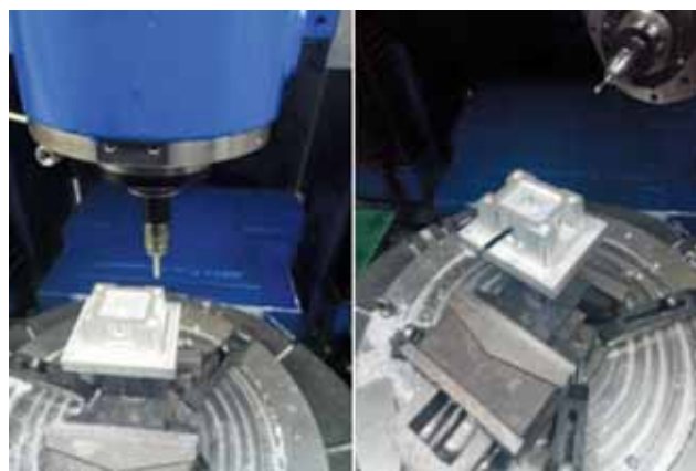
图 16 镗铣 4 处 \phi 16 mm 光孔和 M10 \times 1.5 mm 刚性攻丝
