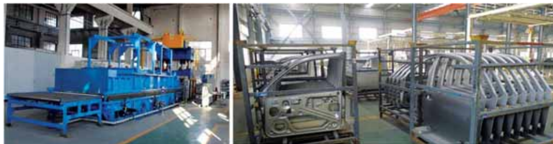
高强钢热冲压中试生产线
