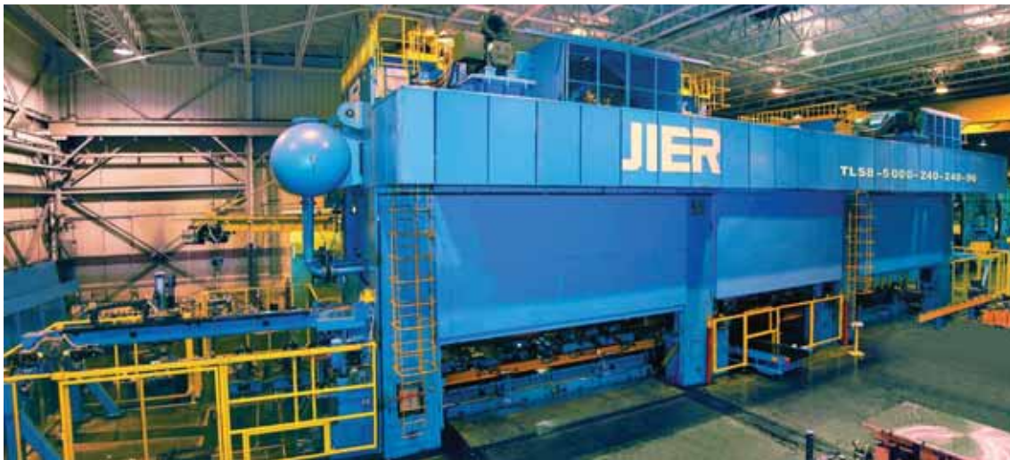
出口美国的 5 000 t 重型多工位压力机
