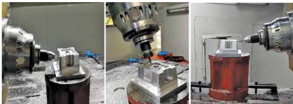
图 25 回转工作台联动系统综合测试
