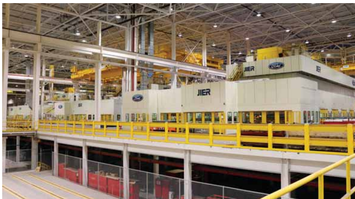
济南二机床为福特汽车美国底特律工厂提供的 4 条大型智能高速冲压生产线
