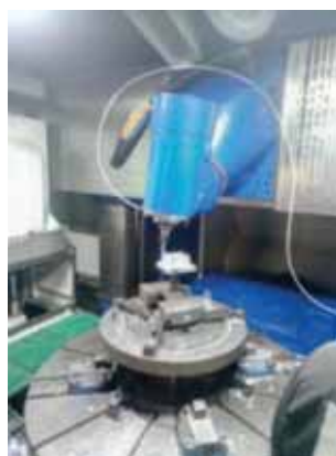
图 20 侧刃粗加工 4 处斜面中
