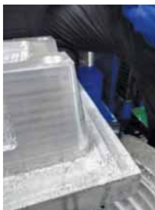
图 21 侧刃精加工 4 处斜面结果
