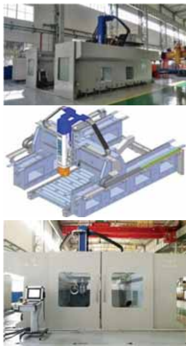
图 1 大型六轴双模式五坐标联动加工中心
