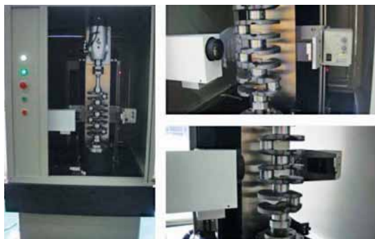
图4 发动机轴类零件精密检测设备
