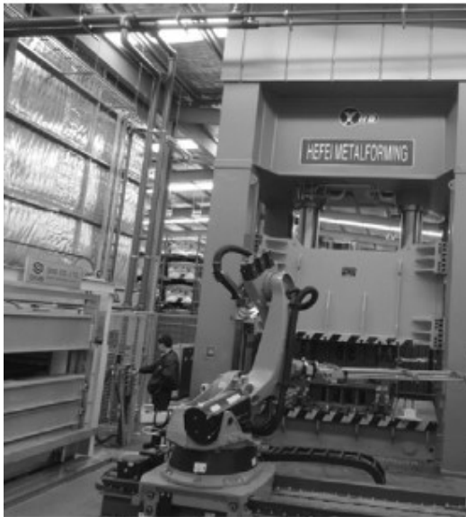
图 1 超高强度汽车结构件热冲压技术和装备生产线
