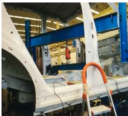
图 7 白车身弯曲刚度试验测试图
