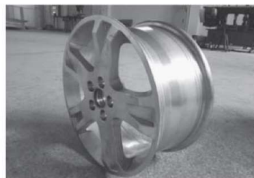
图8 热挤压成形轮毂
