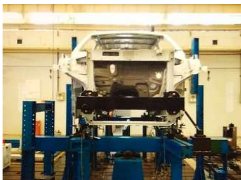
图 8 白车身扭转刚度试验测试图
