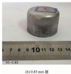
图 10 铝合金板成形试验结果
