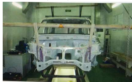
图 9 白车身模态试验测试图
