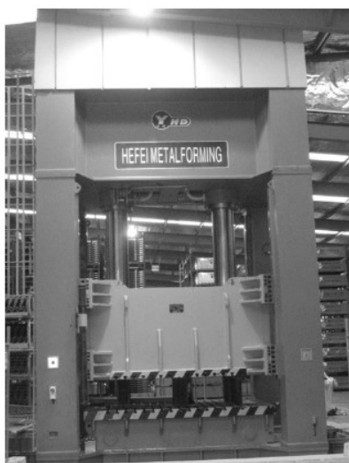
图 5 高速热冲压液压机
