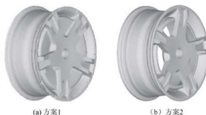
图5 两种挤压方案成形轮毂数值模拟结果
