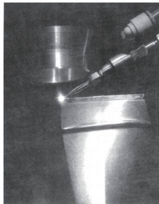
图5 自动送丝激光焊修理涡轮叶片
