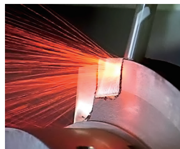
Inconel® 718-用MC275铣槽： MC275陶瓷铣刀，用于Inconel®718的槽铣，切削速度为 670\text{m/min} 。生产效率和金属去除总量明显高于硬质合金铣刀
