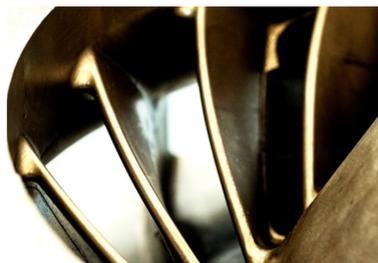
图5 整体闭式叶轮流道局部照片
