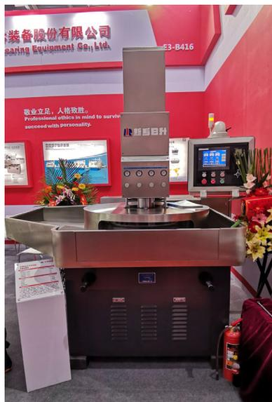
图7 2M84100G双端面研磨机床外观
