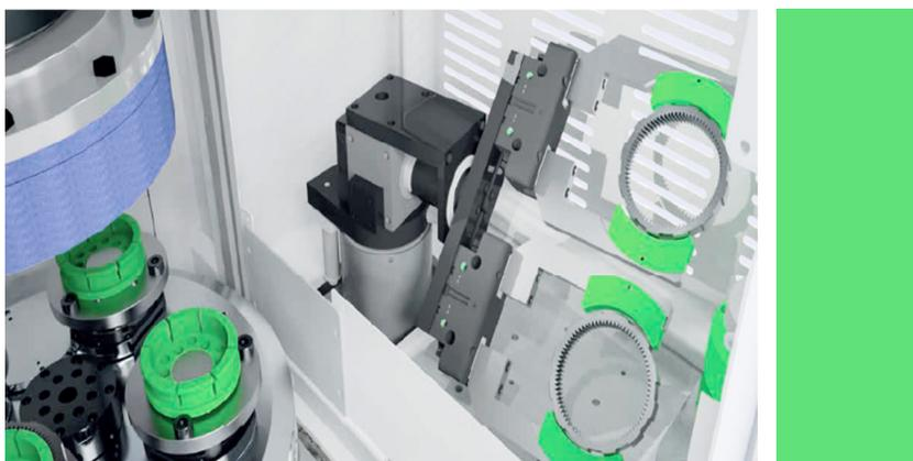
图10 DFine工作区及工件自动翻面装置
