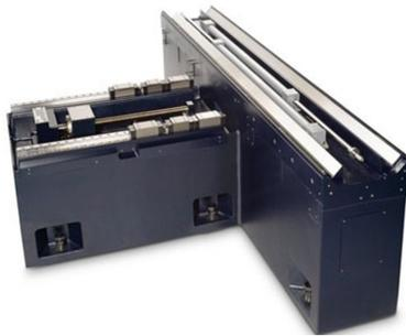
主要技术参数：台面（卡盘）尺寸：800×400mm，砂轮尺寸： $\phi 350 \times 38 \times \phi 127\text{mm}$ ，精细泡沫发生装置TWIN-BIX。
