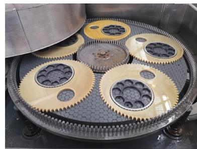
图8 2M84100G双端面研磨机床工作区
