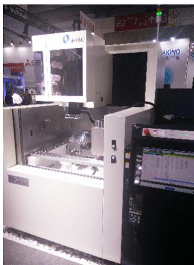
图9 U6 七轴单向走丝线切割机床
