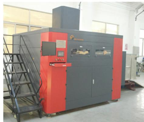
图6 3D打印3DP砂型打印系统
