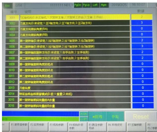
图2 RTCP参数设置界面
