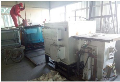
图8 电磁真空增压铸造系统
