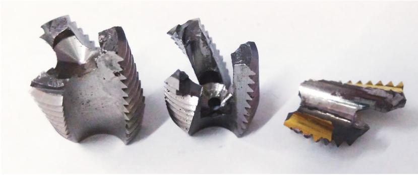
图2 用钻丝锥钻头钻出的两种M14×1.5断丝锥
