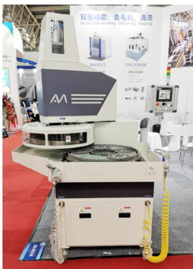
图5 ADL-700双端面研磨机床
