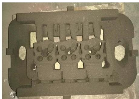
图10 3D打印3DP砂芯
