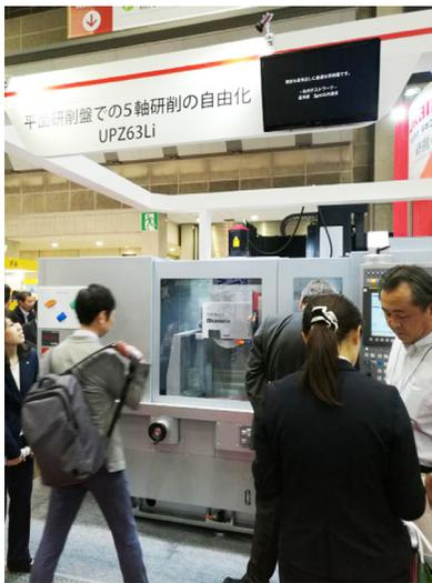
(1) CNC超精密成形磨床UPZ63Li，是为了满足今后复杂形状零件的成形磨削加工，而开发的通过上下、左右、前后3轴CNC控制进行轮廓加工，并且通过增加加工件倾斜轴和旋转轴，实现了5轴CNC控制的成形磨削加工。
