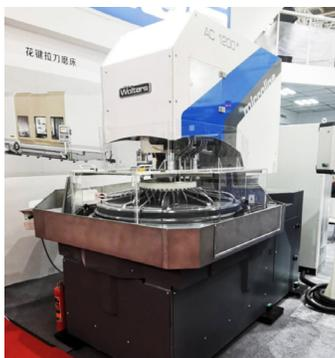
图2 AC1200双端面研磨机床
