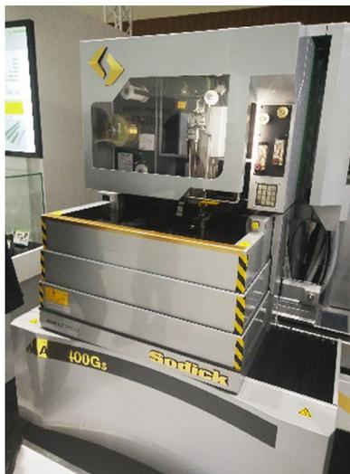
图8 ALN400Gs高速高性能电火花线切割机床
