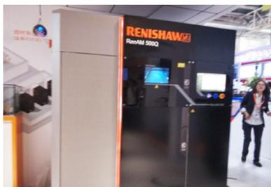
图24 RenAM 500Q多激光增材制造机床
