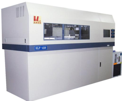
图4 3D打印SLS蜡模系统
