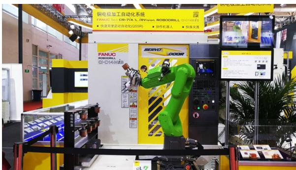
图3 ROBODRILL  $\alpha$ -DiB 铜电极加工自动化系统
