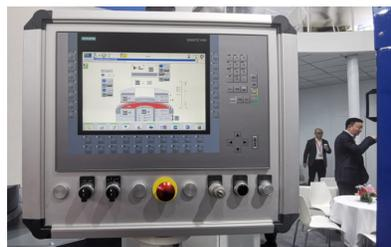
图3 AC1200双端面研磨机操作面板图
