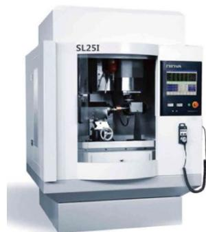
图14 SL25I超硬材料砂轮放电修整机
