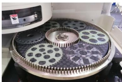
图6 ADL-700双端面研磨机床内部
