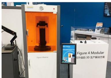
图31 3D Systems公司Figure 4 Modular是可升级的零部件生产解决方案
