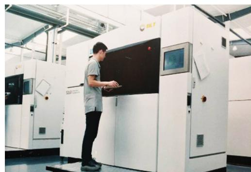
图25 BLT-S310型激光增材制造机床
