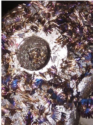
图3 研制过程中的华氏钻头钻断丝锥的效果
