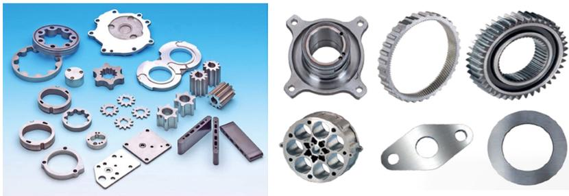
图1 双端面磨床典型加工零件
