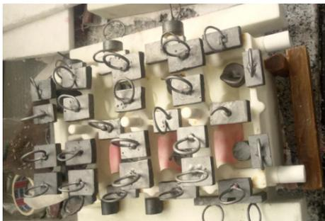
图9 3D打印蜡件和组树工艺
