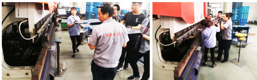
图1 用传统数控折弯机成形钣金件的过程
