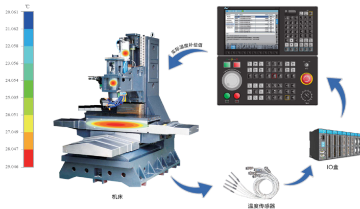
热误差补偿技术基本原理结构图
