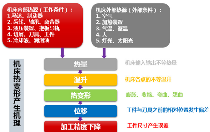
数控机床热变形产生的机理
