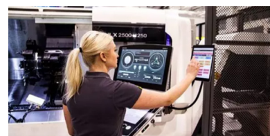
图33 操作员通过机床边联网的平板输入具体的停机信息
