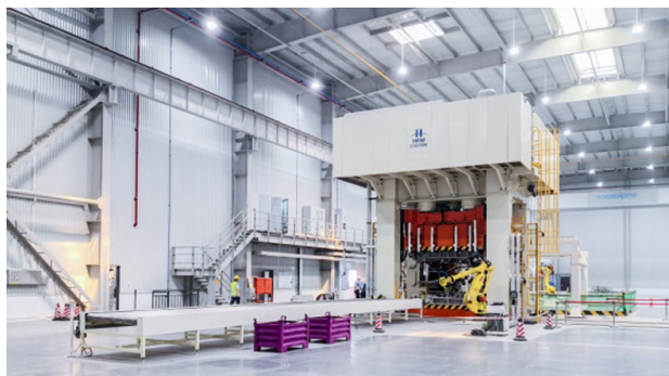
在联机调试中的2600吨间接热成形液压机
