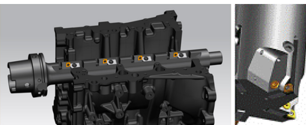
图31 方寸的两种孔加工刀具
