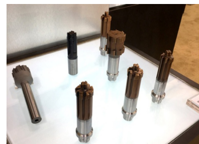
图17 森泰英格高精度可调铰刀和可转位铰刀
