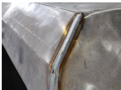
图16 前风窗角焊缝
