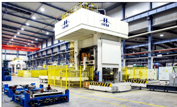
合锻智能辊底炉高速热冲压生产线（直接热成形工艺）
