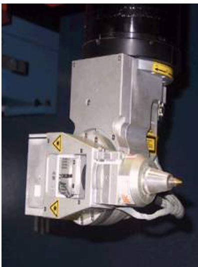
图3 偏置式(Offset Head)切割头
