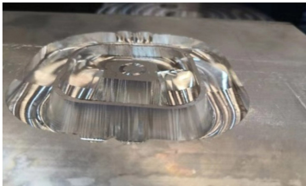
图1 表面波纹严重的零件
