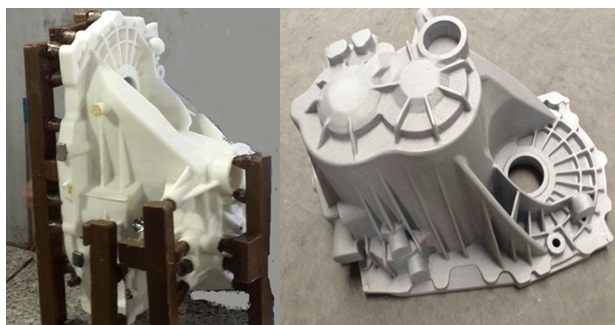
图2 离合器壳体PS模和石膏型熔模铸件
