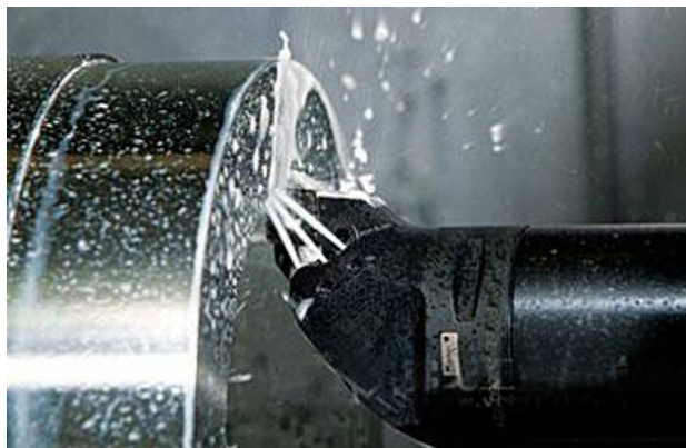
图4 高压冷却断屑形式
