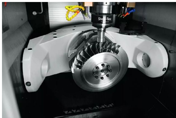
图10 整体叶盘加工示意
