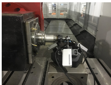
图21 RTCP精度检测
