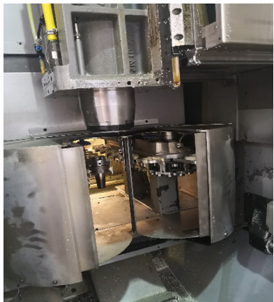
图1 双刀架链式刀库
