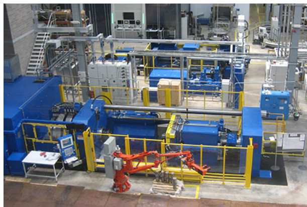
图17 MTI全自动化惯性摩擦焊
