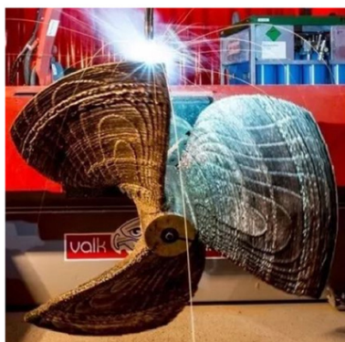
图7 增减材混合制造船用螺旋桨(荷兰Damen)
