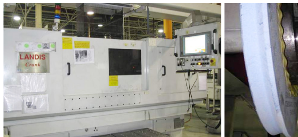
图10 曲轴角磨机及角磨砂轮
