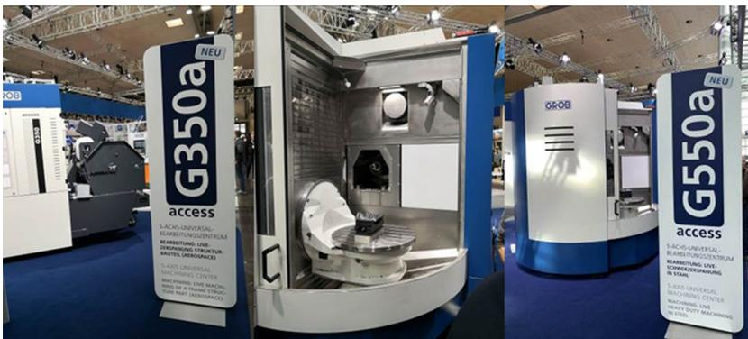
G350a和G550a都以格劳博G系列卧式五轴加工中心的主要结构为基础，兼顾了机床的通用性和经济性，加工对象主要面向汽车、工具、模具、机械制造等领域。产品坚持格劳博独一无二的机床设计理念，采用卧式主轴结构保证了Z轴的最大行程以及最佳的排屑效果；X、Y、Z三个直线轴空间合理安排，保证工作点（TCP）与各导轨的距离最小，增强了工艺系统刚性，使机床具有最佳的稳定性；坚持隧道概念，在使用最长刀具时，机床各旋转轴都不受任何限制，仍然能够实现最大工件的加工；转台的摆动范围大，三个直线性轴和两个旋转轴允许5面加工和5轴联动加工，A轴摆角范围为 $230^{\circ}$ ，B轴可以实现 $360^{\circ}$ 旋转。
