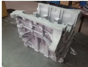
图12 缸体铸件
