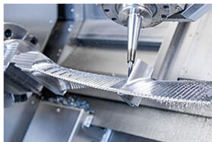
M50-G的另一显著的特色功能是采用超高压冷却泵(UHPC)，冷却压力可控在150~350bar，因而断屑功能得到最优化，减少了加工时间，降低了生产成本。根据WFL提供的数据，在实际应用中成本可减少50%。由于冷却液是通过铣削主轴中心出液冷却，无需额外接口即可实现高达200bar的冷却压力。这一应用不仅可以保证不锈钢材料的加工可靠性和生产效率，而且也适用于加工高合金钢和超合金材料。
