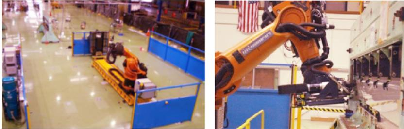
图2 副翼制孔修剪机器人系统
