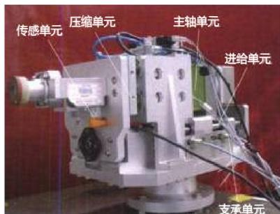
图3 沈飞与北航机器人制孔系统
