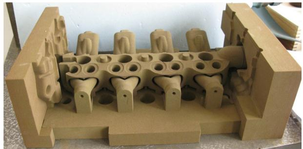
图9 发动机零件砂型和砂芯一体化制造
