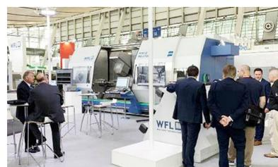
M50-G车铣复合加工中心最大加工直径为670mm，最大顶尖中心距为6000mm。车削主轴最大功率40% (100%)可以达到80(60)kW，最大扭矩40% (100%)可以达到3600(2740)Nm，对应的最高转速为2600r/min；铣主轴最大功率40% (100%)为40(35)kW，最大扭矩40% (100%)可以达到480(420) Nm，对应的最高转速为5000r/min；B轴摆角±110°；Y轴行程400mm。
