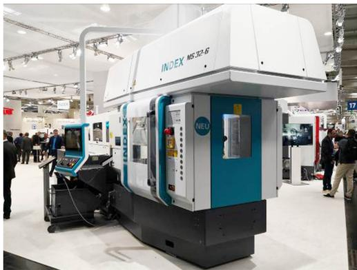
6个主轴安装在核心部件主轴鼓内，紧凑的主轴鼓通过一个端面齿盘分度，使得每个位置都具有最高精度。6个主轴采用无级调速、高扭矩、小尺寸、免维护以及最新同步技术，主轴最高转速为8000r/min。在加工期间，每个主轴位置和每把刀片都始终具有最佳转速，转速互不影响，甚至在切削时仍能对其进行编程控制，从而不会带来额外的辅助时间。从而能获得最佳断屑效果、最高表面质量，并缩短单件加工时间、延长刀具使用寿命。还能加工迄今为止几乎完全不适用于多轴机床的高强度材料。
