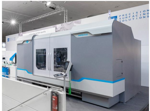
Millgrind BL10的磨削范围为1000mm×740mm，砂轮最大尺寸为 $\phi 300\text{mm} \times 65\text{mm}$ 。电主轴最高转速为10000r/min，功率50 kW，主轴端采用HSK 80B接口，可完成磨削、铣削和钻孔加工工艺。配置顶置砂轮修整器，可对刚玉类、CBN和金刚石砂轮进行在线自动修整。配置自动换刀系统，借助回转刀架，可以同时更换修整滚轮和砂轮，节省换刀时间。刀库系统可容纳60种刀具，其中包括砂轮、修整滚轮、测量探针、铣刀和钻头等，同时刀库可实现模块化扩展。配置A/C摇篮转台，通过西门子840Dsl系统控制，实现对复杂形状的多轴插补磨削。可选配的高性能熔覆激光单元，可实现打标和增材制造。
