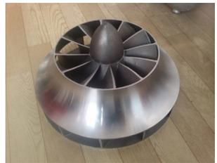
图14 合金钢叶轮铸件
