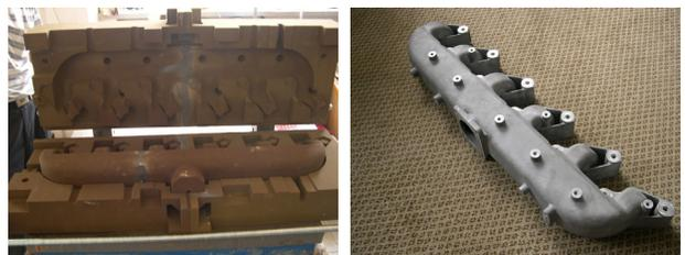
图10 排气管打印砂型、砂型组装和浇注后零件
