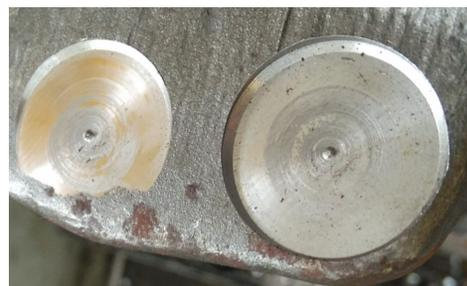
图5 钻孔前的镗平面留有凸尖
