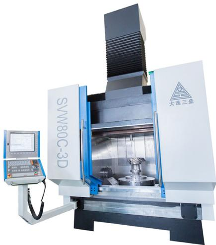
图4 CCMT2016展会亮相的增减材五轴加工中心
