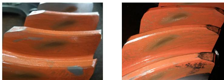
图6 切齿接触区
