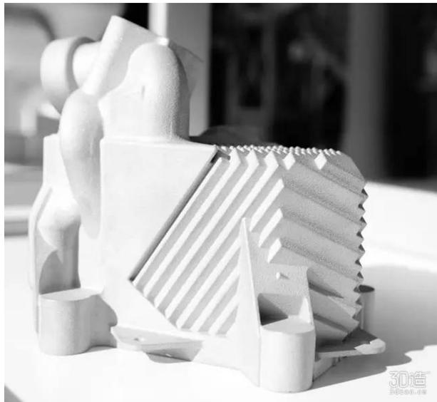
图1 3D打印立体燃油加热器
