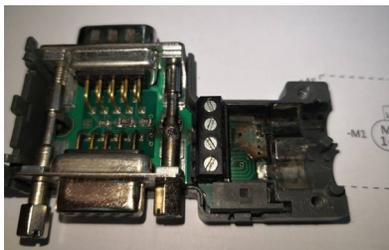
图7 严重烧蚀的PROFIBUS总线接头
