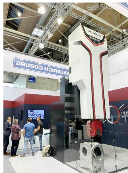
部件的超精密加工、机床一体式包围上的可调导轨、铸铁材质的横梁/滑枕, 结合百年的机床制造经验, 使得机床精度和可用性的寿命得以保证。
