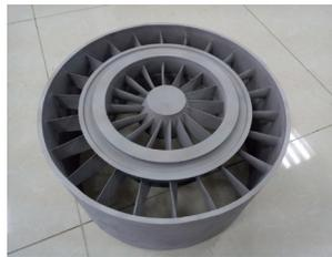
图13 铝合金叶轮铸件
