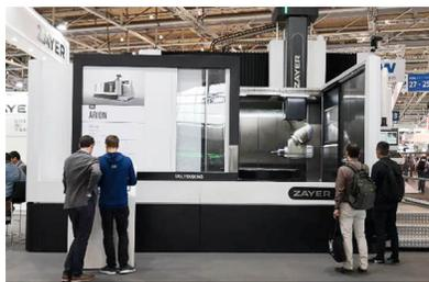
ARION G的工作台的长度和宽度范围都是1250~2000mm, 可配置直径为2000mm的旋转工作台, 采用电机直驱技术, 最大负载为20吨。机床配有一个45°连续旋转头, 最小分度单位0.001°, 电主轴功率为42
