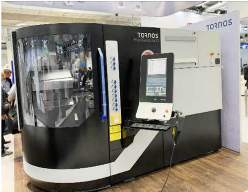
MultiSwiss 6x32的最大加工长度为65 mm，主轴采用静压轴承技术，最大转速为 6000r/min，每个主轴除了具有C轴功能，还具有Z轴移动功能，Z轴行程150mm。静压轴承技术的应用提高了系统的阻尼性能，可以实现更加出色的加工表面质量，同时由于加工过程中振动小，使刀具获得了更长的寿命。6个主轴安装在一个主轴鼓内，主轴鼓由力矩电机直接驱动，实现各个主轴的分度换位，由于没有端面鼠牙盘结构，可实现0.4秒以内的快速换位时间，并具有最低的噪声水平，因此可节省用于锁定及解锁的宝贵时间。
