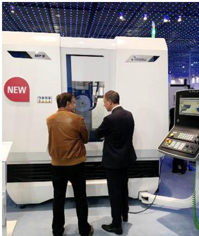
MFP 30磨削中心采用紧凑型设计理念，结构、功能、专用磨削和自动补偿软件符合用户使用需要。紧凑而又节省空间的设计可优化使用现有生产区域，并实现有效的生产流程。MFP 30根据需要可以实现5轴或6轴加工，通过一次装卡可完成磨削、铣削和钻削等工艺，将高效和柔性加工结合在一体。
