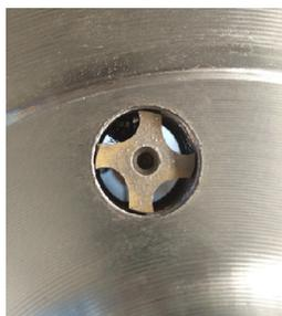
图4 丝锥在出口处折断、卡死停机
