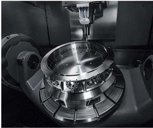
C42U MT的抓取式刀库集成在机架底座内，配备刀具更换装置和可转动的操作台，便于刀具的取放和调整。标准机型配备42个刀具库位，通过附加刀库可扩展为462个。最大刀具重量达为8kg，最大刀具长度为300mm。
