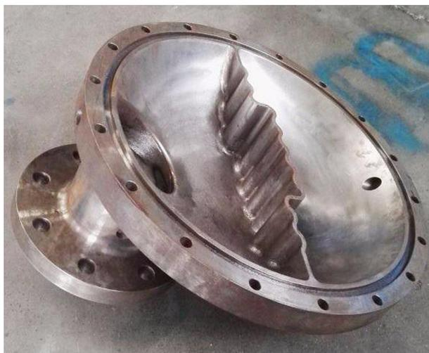
图3 3D打印金属制冷机端盖
