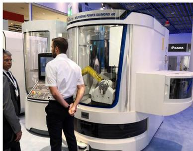
HELITRONIC POWER DIAMOND 400机床是将砂轮磨削和电火花加工“二合一”全能装备，具备出色的生产效率。高性能直驱电主轴的主轴端装备了一套水冷系统。
