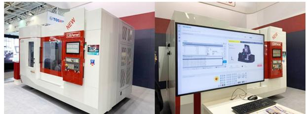
在日益数字化和互联的工业世界中，机床在集成化生产管理中起着基础性的作用。为了应对这种趋势，C.B.法拉利设计了新的具有高精度、高产能的复合加工中心（铣削和车削）——A236五轴加工中心。特点：①该加工中心带有可移动立柱，无论是从进料和出料的角度，还是从它能够与外界交换的信息的角度，都能够适应生产循环的需要。②A236加工中心设计用于加工中小型钢铁、钛合金及超合金等材料的涡轮叶片。A236加工中心还可以用于加工叶轮、整体叶盘、医疗器械零件、钟表制造、凸轮、特殊刀具刀体和任何其他类型的复杂零件。
