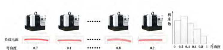
图9.机床集群数据的横向比较评估机床的健康状态
