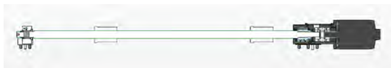
图7 一端固定一端浮动的驱动结构
