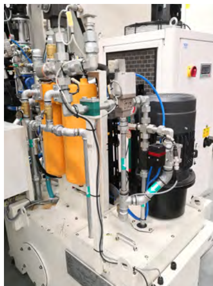
图10 中心出水无极调压结构
