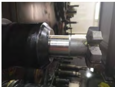
图6 加工凹槽右段粗铣刀
