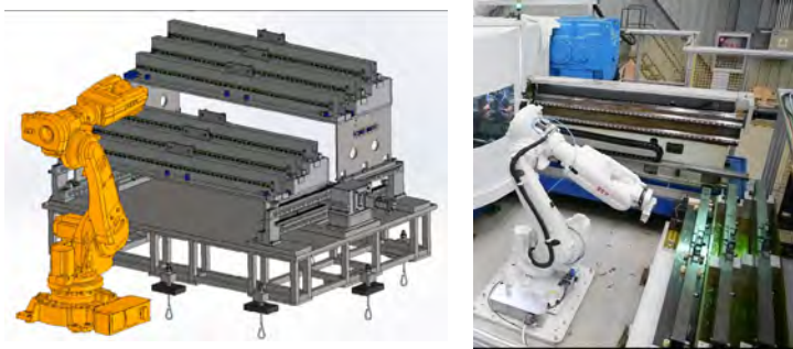
图3 刀具储运系统三维图及实物图
