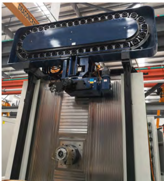
图9 顶置式刀库结构
