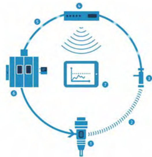
1. iTENDO智慧刀具、2.无线数据传输、3.机房中的icotronic通信模组、4.电子控制单元、5.即时通讯、6.机器控制、7.通过应用程序进行过程控制和调整/ OPCUA可以进行通信。
