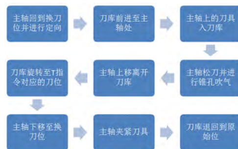
图1 换刀流程
