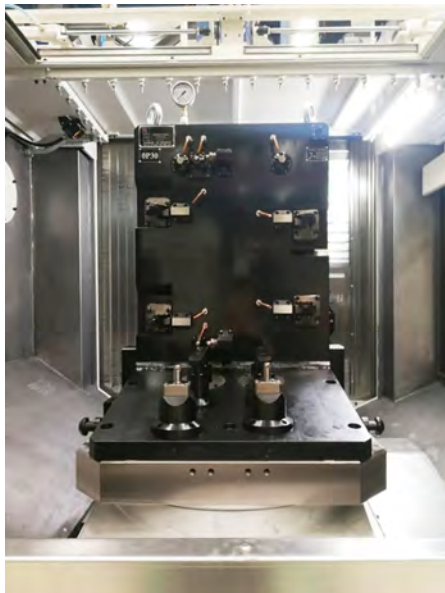
图12 大流量冲洗冷却结构
