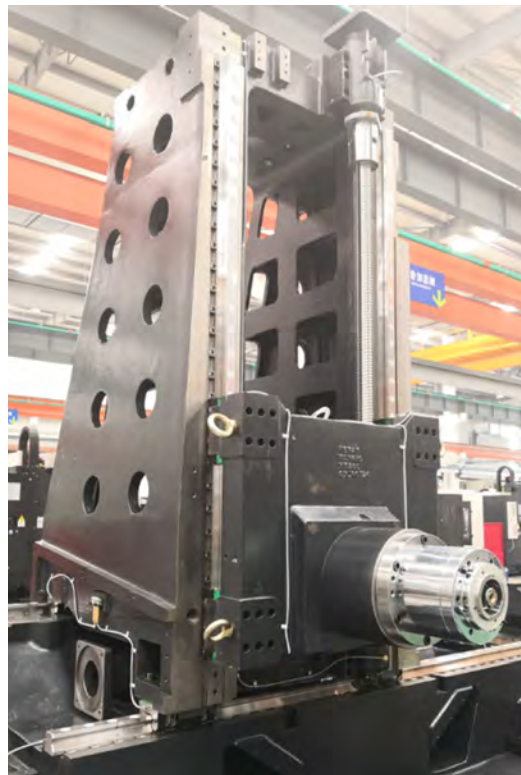
图6 阶梯式立柱结构
