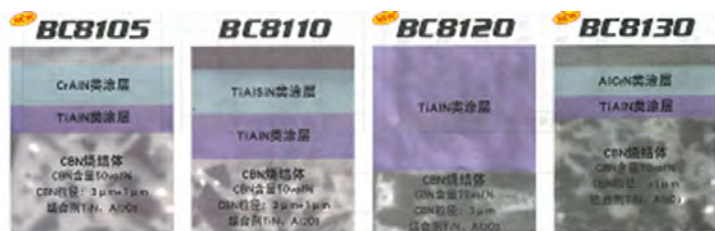
图2 四种BC8100系列CBN刀片的涂层和基体组织
