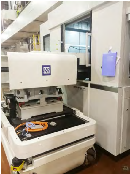
图3 SY500无人化智能移换平台在机床侧更换更换夹具托盘
