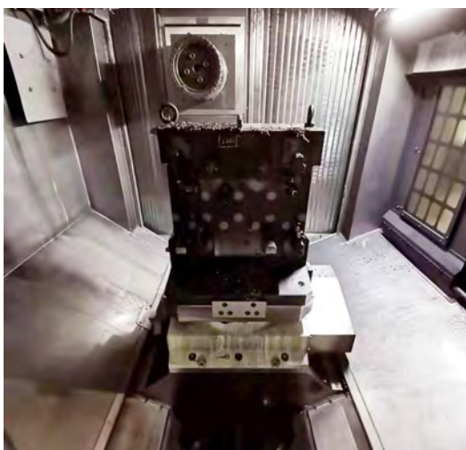
(d) 带大盘铣刀机械主轴配置
