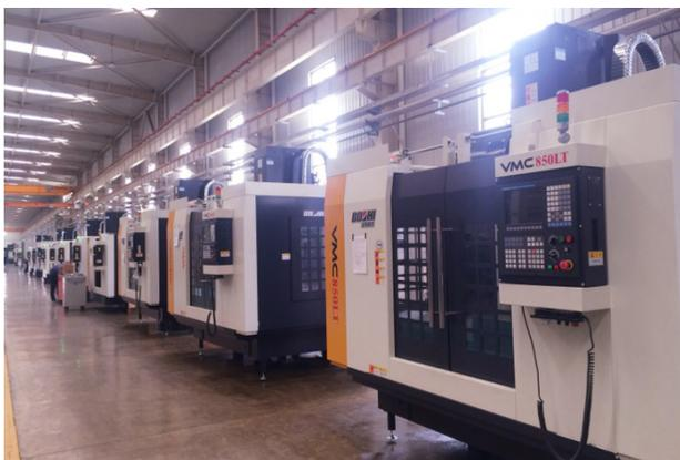
图13 宝鸡机床集团批量配置华中8型系统的加工中心车间
