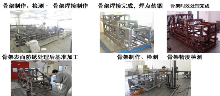
图2 内外饰验证台架骨架制作流程图
