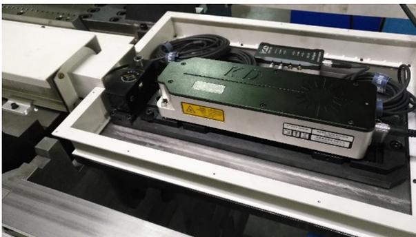
图2 实际装机的激光反馈尺及防护装置
