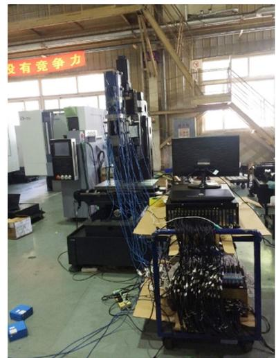
图3 数控机床整机振动测试
