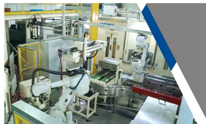
图1 多机器人协同汽车制动钳支架加工全自动生产线
