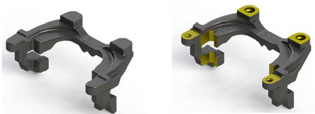
图2 制动钳支架加工毛坯和成品
