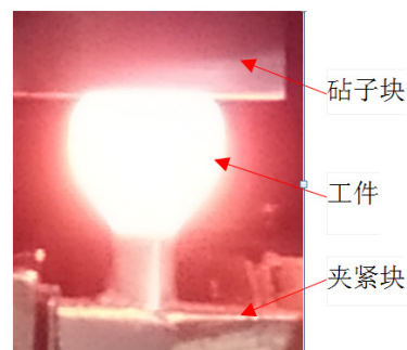
图2 杆料电热锻成蒜头形
