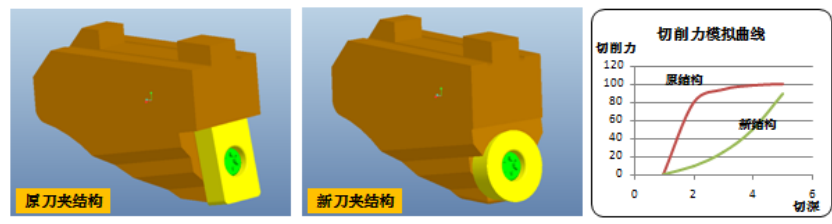
图5 刀夹结构设计及切削力对比
