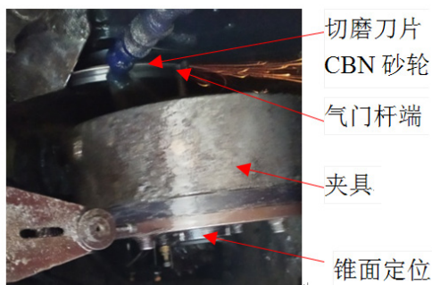
图4 盘锥面为基准切磨杆端面
