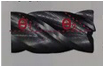
图2 不等导程结构是基于每个切刃的螺旋角度（导程角 \theta ）变化强效抑制振刀，实现优异的精加工表面 \theta_1 \neq \theta_2
