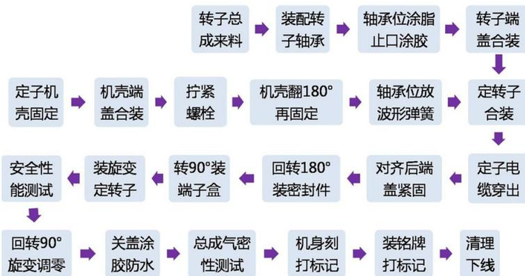
图10 定转子合装测试参考路线
