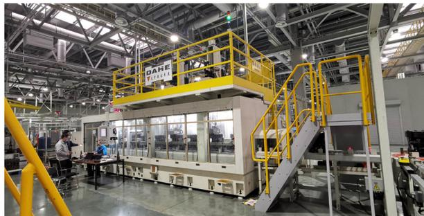
控制系统选用贝加莱高性能工控系统PPC2100，具有64位CNC处理器，配备千兆级工业现场总线powerlink，使机床系统控制扫描周期达到0.4ms。
