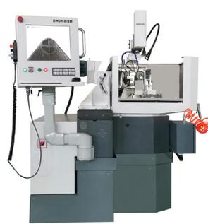
M50 CNC 可转位刀具自动磨床
