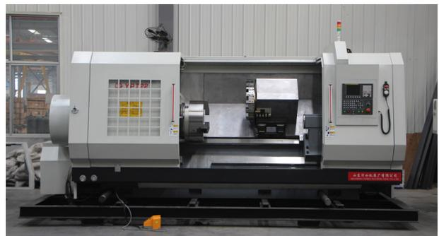
YPT22斜床身数控管螺纹车床
