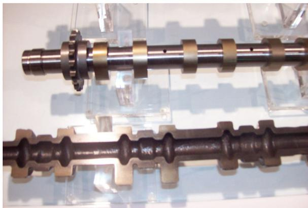
图8 上方为组合凸轮轴，下方为冷激合金铸铁凸轮轴
