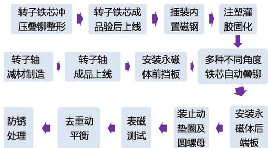
图7 转子总成的通常工艺路线
