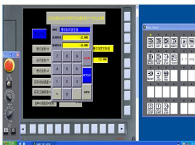
图8 修改宏变量值的十键输入对话框
