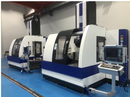
图5 五轴数控气囊式抛光机床实物图
