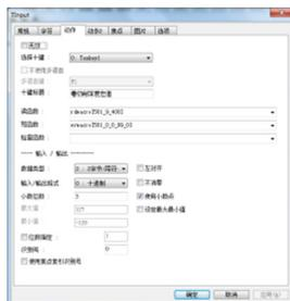
图3 操作界面槽进刀值与宏变量的连接函数关系
