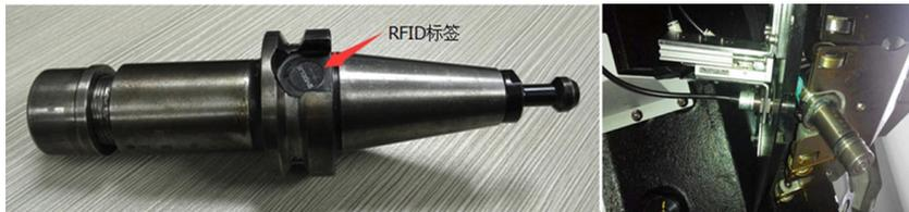
带有RFID的刀柄及读写装置
