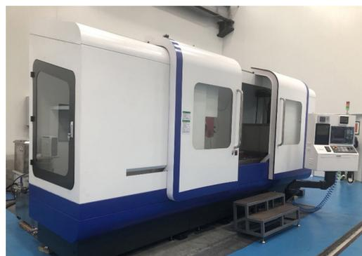
图4 非球面超精密成形磨床实物图
