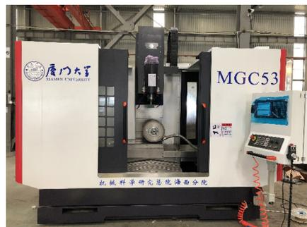
图6 数控离线砂轮修整机床实物图
