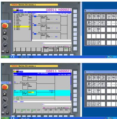
图13 读取宏变量#501的PLC程序
