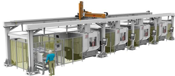
图1 桁架式机加自动线
