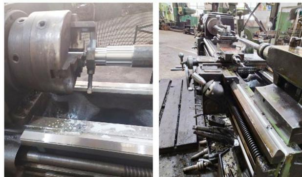
图8 安装拨盘和工件
