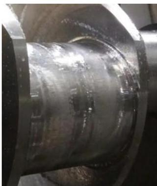
图5 铣削后的连杆颈及开档状态
