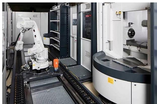
图2 关节机器人式机加自动线
