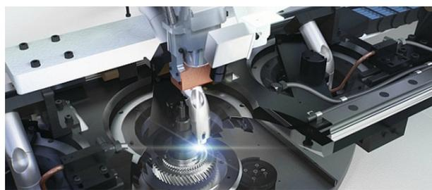
北京市电加工研究所有限公司LASER6120精密刀具激光刃磨机床。机床采用龙门式结构，机床具备五轴四联动，其中A、C轴为光学轴，选用100W光纤激光源，激光波长1064nm，光束质量（ $M^2$ ） $\leq 1.6$ ，可选择60W皮秒激光源；具备自动寻边、自动对焦等功能；可满足PCD、CVD、PCBN刀具（如机夹刀片、轮廓刀等）的刃口加工以及刀具表面断屑槽的加工。
