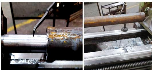
图5 粗车轴另一端（找正“两个点”、打中心孔、反向走刀车外圆）
