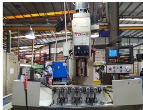
图11 发动机连杆螺纹加工
