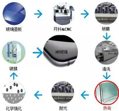
精雕玻璃是采用精雕机砂轮槽对毛坯玻璃进行磨边,去除余量,并通过钻头将玻璃原料进行倒边和钻孔,用细砂轮对外形及摄像头孔精加工,以满足最终成品要求。加工精度达0.01mm。抛光时加入抛光粉,通过研具在一定压力下与加工面作复杂的相对运动,将玻璃原料磨至要求厚度,并抛光成表面镜面效果。
