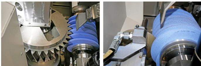
秦川机床工具集团股份公司YK7215数控蜗杆砂轮磨齿机。龙门式立柱、双支撑结构砂轮主轴，矿物质铸件床身；集蜗杆磨与成形磨于一体，用于磨削标准或修形的渐开线圆柱齿轮；砂轮主轴和工件主轴采用直驱方式，最高转速12000r/min，砂轮线速度100m/s；专业化齿轮磨削软件，可实现双联齿轮的相位控制、齿面扭曲控制、单边修整、点修整、网纹磨削、镜面磨削等功能，全新式机械手更换工件的时间小于3s。
