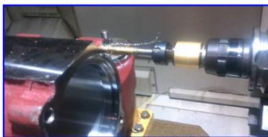
图2 分体式轴箱体螺纹孔加工
