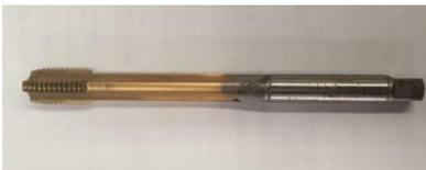
图9 刃带设计浅槽结构丝锥
