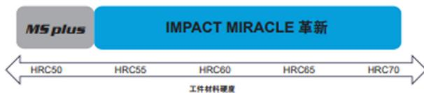
图5 VFR涂层组成及与MS+涂层加工硬度范围比较
