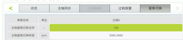
图3 数控系统中主轴星角切换参数设置界面
