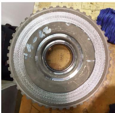
图4 试制后零件加工振纹
