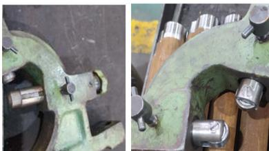
图1 传统跟刀架与改进跟刀架对比（图中滚动轴承采用高速滚动轴承）
