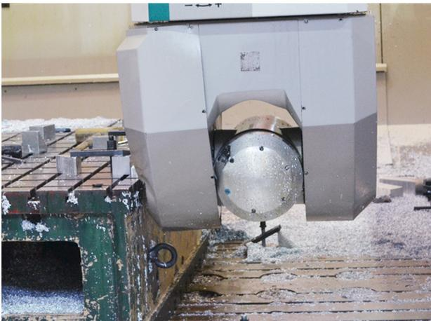
图1 五轴铣头与工装发生干涉
