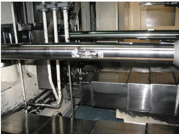
图3 粗镗主轴承孔镗杆（中间为粗精加工曲轴止推面两把刀）
