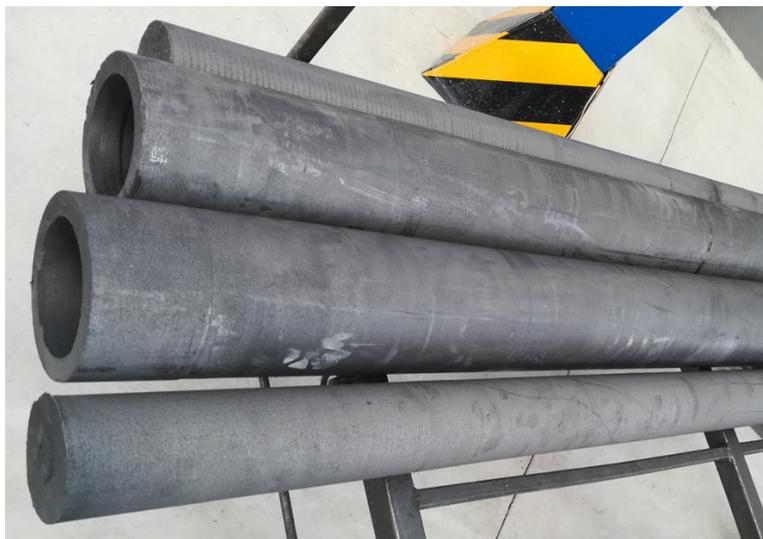
图6 加工工件实物图（工件及料芯）
