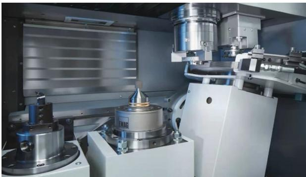
大隈机械(上海)有限公司MULTUS U3000铣车复合加工中心。是智能化复合加工机床MULTUS系列中典型产品, 最大加工直径 $\phi 650\text{mm}$ , 最大加工长度1000mm, 可选配1500mm。具备同级别最大Y轴行程并采用高刚性立柱移动式结构, B轴分度角度 $-30 \sim +210^\circ$ , 使主轴和副主轴拥有同等的加工区域, B轴驱动采用了零反向间隙的滚子齿形凸轮驱动, 主轴和副主轴均可实现精密分度的高精度C轴, C轴定位精度4", 旋转刀具主轴转速 $50 \sim 12000\text{r/min}$ , 主轴转速 $50 \sim 5000\text{r/min}$ , X、Y、Z轴快速进给速度50m/min、50m/min、40m/min; 双滑板机构可将加工时间缩至最短, 支持倾斜轴的车削, 可选用齿轮加工程序包, 只需输入刀具种类、齿轮规格、加工条件等参数, 即可实现高精度制齿。
