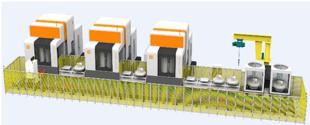
图3 有轨小车式机加自动线
