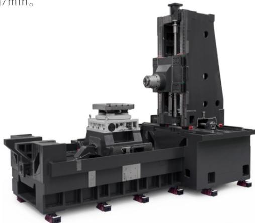
北京博鲁斯潘精密机床有限公司 HMC600DSP-5i卧式五轴联动加工中心。由双主轴和双摇篮式交换工作台组成的卧式加工中心。A、U轴可两端液压锁紧,每个主轴可单独控制,一次可加工2个工件,根据不同的加工工况,可选择四轴或五轴联动。适用于汽车铝合金发动机缸体、变速箱壳体、转向节等汽车零部件精密加工。
