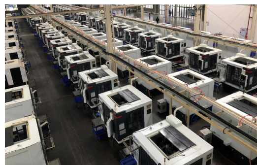
图7 批量配置华中8型系统和直线电机的高速钻攻中心
