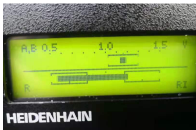
图14 C轴光栅尺信号
