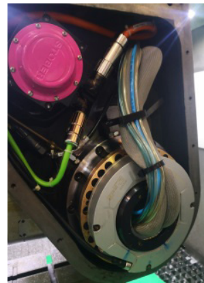
图4 A轴抱闸及管路
