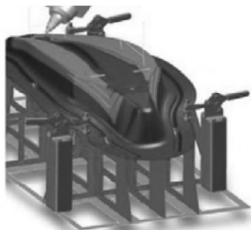
图5 激光切割支架示意图
