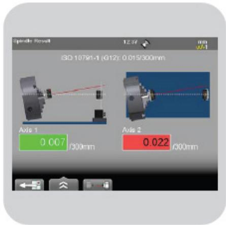
图19 主轴指向性测量后在平板电脑上显示的XK10的测量结果
