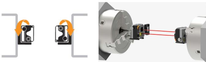
图21 同轴度测量时XK10的部件安装示意及测量分步仿真图片
