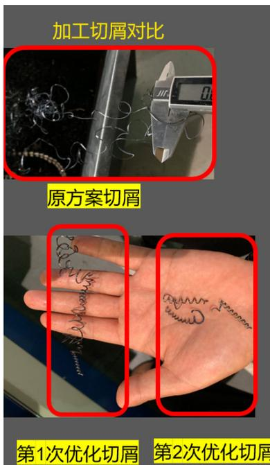
图16 螺纹车断屑情况分析
