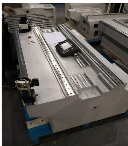
图14 平面度测量时XK10的部件安装示意及测量现场实例照片
