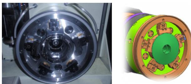
图13 五爪弹性气动夹紧装置
