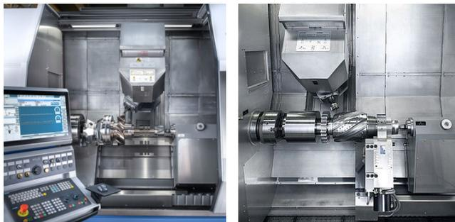
目前机床“复合”程度也在不断提高。从“加工工序复合”发展到“以完成整个零件加工为目的的复合”，一台机床成为一个“车间”，一个零件在一台机床上完成全部加工；几台机床成为一个产品的“制造工厂”。
