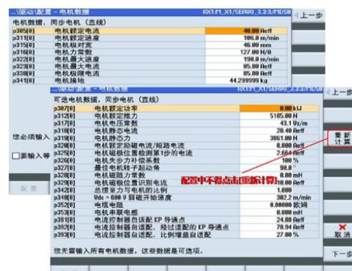
图9 1FN3电机驱动配置画面
