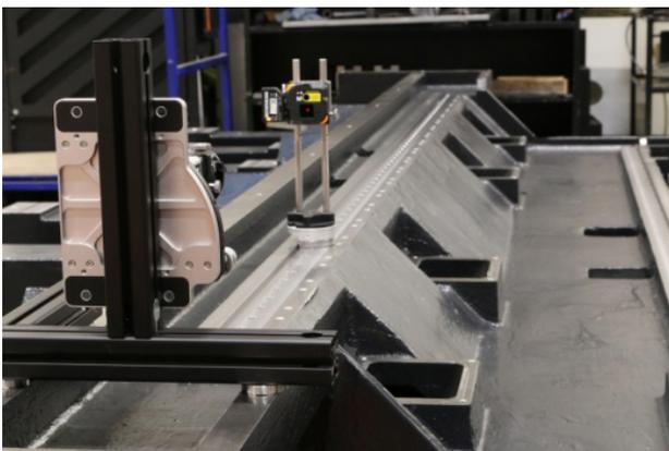
图10 直线度测量时XK10的部件安装示意及测量现场实例照片
