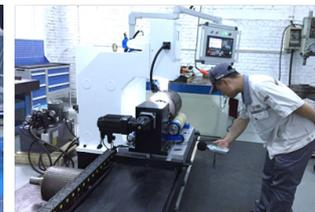
图17 转子导条滚压涨紧机噪声检测
