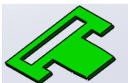
图8 上耳板和下耳板插板结构示意图
