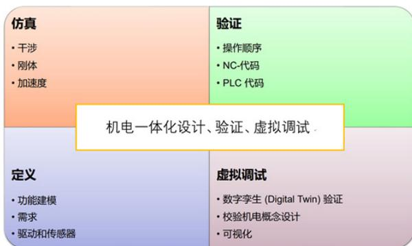
目前欧洲机床制造企业不同程度地实施了机床数字化制造应用。在设计中主要进行干涉、刚性、加速度仿真，对NC代码、PLC代码和操作顺序进行验证；在产品装配中实现机电一体化的虚拟调试；在使用中实现互联互通，与各种管理软件打通，大幅提高生产效率、降低成本、缩短交货周期。
