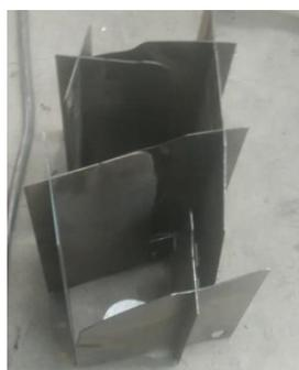
图7 激光切割插装结构图
