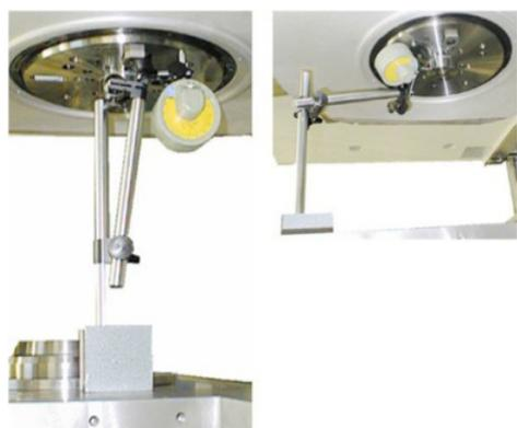
(a) 轴向跳动 (b) 径向跳动
