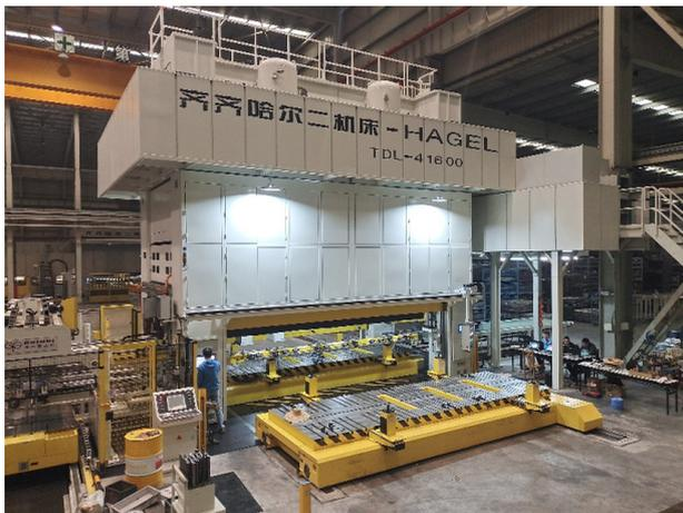
图3 通用技术齐二机床TDL-4 1600型多工位自动冲压生产线
