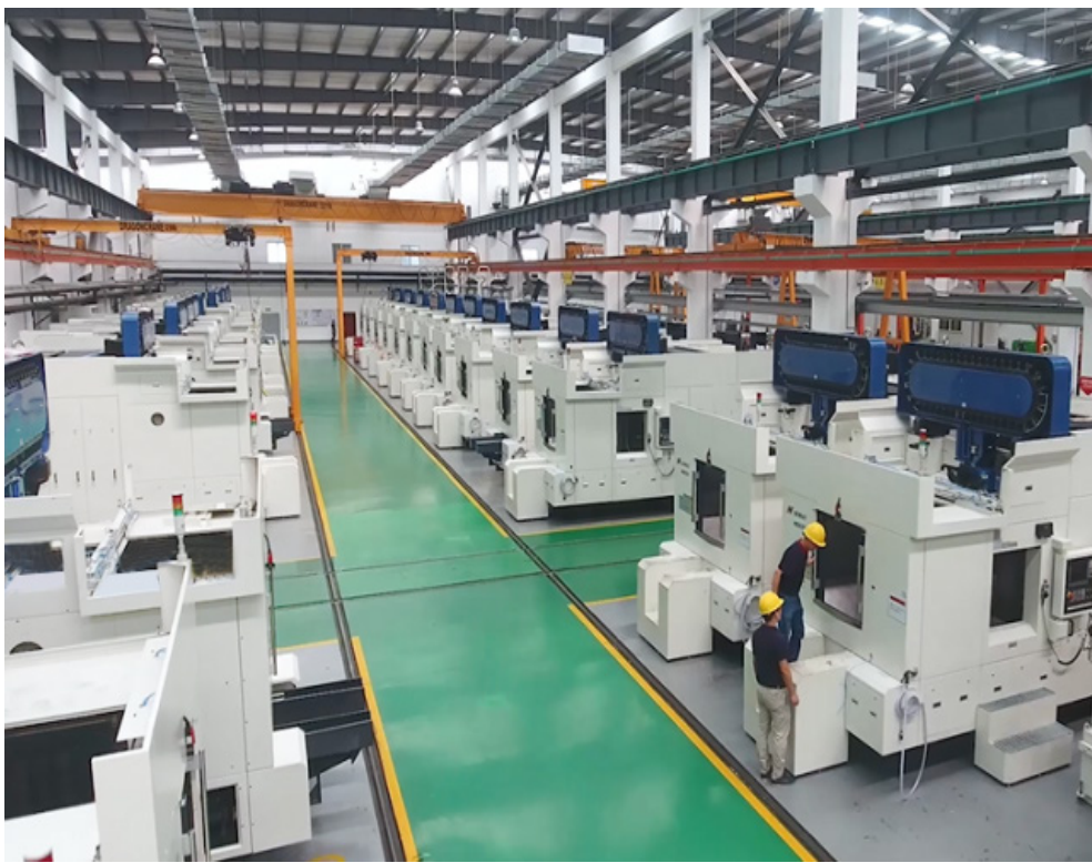
图4 HE系列高效卧式加工中心机床生产现场
