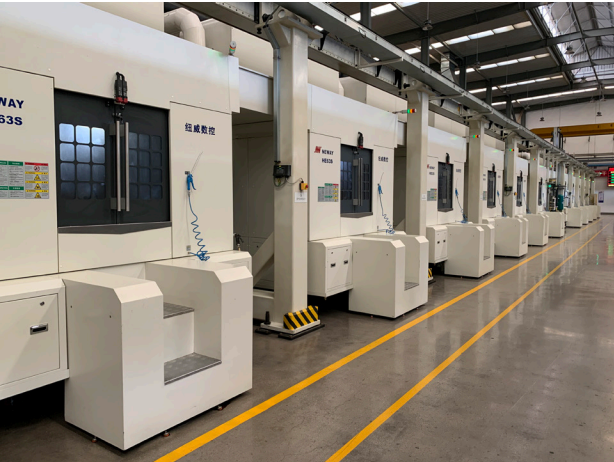
图1 汽车发动机高效加工卧加自动生产线
