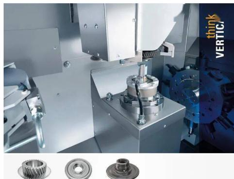
多主轴机床在不增加机床数量情况下提高企业生产率，深受市场欢迎，技术得到快速发展。多主轴结构各异，功能不尽相同，既有多主轴同步加工，也有可独立控制的。
