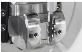
复杂形态金属零件钻铣磨加工
