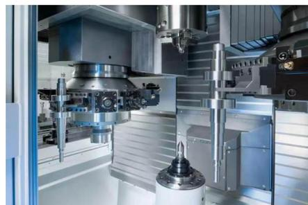
◆济南第一机床有限公司 VL-600ST 数控立式车床。该系列机床采用模块化设计，满足刹车盘单刀架标准车削要求，也可满足其他零件标准车削要求；采用卧式刀架和对置式伺服轴联动上刀架，上下刀架可同时对刹车盘两面进行高效车削加工。
