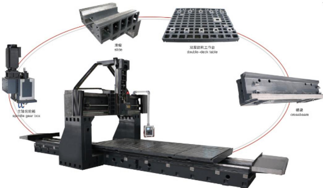
◆广东普拉迪科技股份有限公司 PHC1630龙门加工中心X/Y/Z行程3000/1600/800 mm，两立柱间距2250mm，主轴最高转速8000/20000r/min。采用高架横梁移动式结构，横梁与滑座以“箱中箱”几何热对称结构设计，改善挠曲变形，可提升结构刚性，大幅减少热变形和重量变形，工作台、床身、横梁、滑座、滑枕均采用优质高强度铸铁材料，经二次时效处理，机床抗振性能强。主要应用于航空航天、模具、船舶、高铁、工程机械、汽车等行业。
