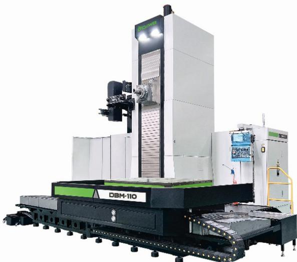
◆湖南九五精机有限责任公司J5MB1112 卧式铣镗加工中心镗轴直径 $\phi 110\text{mm}$ ，立柱横向行程（X轴）1750mm，主轴箱垂直行程（Y轴）1250mm，工作台纵向行程（Z轴）1600mm，镗轴轴向行程（W轴）500mm，镗轴低速最大扭矩1150N·m。采用T型床身，动立柱，正挂式主轴箱结构，配置静压转台，全闭环控制。主轴箱采用齿轮变速传动和液压氮气平衡机构，各传动轴系独立恒温冷却系统，链式刀库和自动排屑装置，自制高刚性高精度镗轴单元，配置整体全封闭式或半封闭式双开门防护罩，适合对箱体类、壳体类、模具类零件高精度孔系和平面加工。
