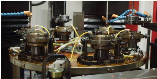
株式会社日进制作所 G50L-MS1型立式数控自动珩磨机加工孔径 $\phi 4 \sim \phi 50$  mm,加工孔长350 mm。采用主轴带主、副双行程机构,实现了长行程设备的紧凑化,主轴回转运动、上下往复运动、油石扩张运动均使用伺服电机控制。主轴转速为3000r/min以内,主轴的上下往复运动速度最大为40m/min,最大行程量为600 mm,行程最小设定量为0.01 mm,油石采用定量扩张方式,每次的扩张量最小设定值为0.01 $\mu$ m。具备自动对刀调整功能,输入被加工工件内径及要求交叉网纹角度,自动计算并设定主轴转速等程序。满足大径、长孔零件的加工,最大长径比约为15。主要用于多路阀、液压集成块等液压行业的产品加工。同时参展还有G50-MS2型立式数控自动珩磨机。
