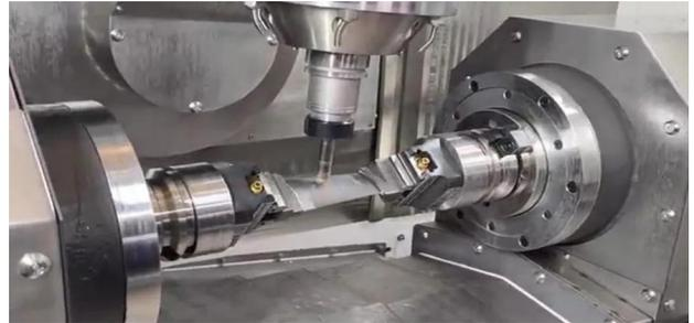
◆浙江日发精密机床有限公司RFMV80-5XP 立式摇篮五轴加工中心：整体桥式对称布局，滑板左右移动距离（X轴）800mm，横梁前后移动距离（Y轴）1200mm，滑枕上下移动距离550mm，A轴摆动角度 $\pm$ 130°。床身采用一体式高架墙结构，X轴采用大跨距高低结构，三轴采用重心驱动技术；内置式电主轴，意大利MCM风格的摇篮工作台结构。全闭环精度控制，适配多种规格电主轴，兼顾轻型切削和重型切削。通过以太网通讯与外部自动化设备的对接，可实现自动化无人化加工。
