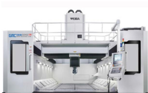
◆意特利（上海）科技有限公司SKY1800 立卧转换龙门加工中心X轴（主轴横向运动）：1500/1800mm，Y轴（转台纵向运动）：1500/2100 mm，Z轴（主轴竖直运动）：1400 mm，B轴（铣头绕Y轴轴线运动）：-30° ~ +180°（叉式）-90° ~ +90°（45°铣头），C轴（转台绕Z轴轴线旋转）：n×360°。大扭矩电主轴（主轴扭矩可达800Nm）；高刚性主轴箱，流体强制循环冷却；高精度转台，具有连续旋转和左右平移功能，双电机机械消除结构；各轴采用大惯量伺服电机驱动滚珠丝杠副，全闭环光栅尺；独特的转台惯量自适应控制方法，对转台惯量变化起到自适应匹配，得出适合当前惯量的转台旋转速度，提高加工效率。
