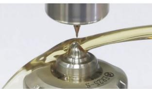
金属和特种材料的微小孔钻孔加工
