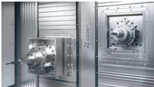
巨浪凯龙的双主轴五轴立式加工中心DZ 08P+，电主轴配置水冷却系统，主轴转速40000r/min，动柱式结构，大理石床身，具有良好的刚性和热稳定性，直连式伺服驱动，可配置工件交换单元，实现在加工同时上下料，直线轴采用直线电机驱动，微米级加工精度，快移速度75m/min，可满足医疗器械与精密加工领域的特殊要求。
