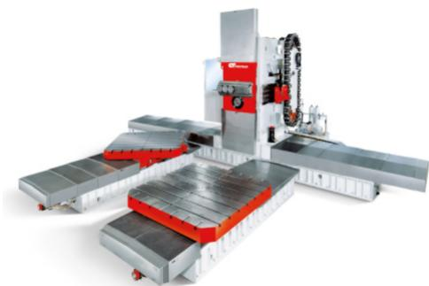
◆华日斯蒂科技发展股份有限公司MX5RAM主轴箱正挂落地铣镗加工中心立柱横向移动行程（X轴）4000 + N×2000 mm，主轴箱上下移动行程（Y轴）2000 + N×500…4000 mm，滑枕前后行程（Z轴）1200mm，W轴行程800 mm，镗杆直径 $\phi 130/\phi 160$  mm。采用“箱中箱”和热对称结构，滑枕和立柱均采用四导轨设计，主轴箱对滑枕组件重心和滑枕挠度进行实时几何补偿。可以配置万能铣头、立式自动铣头和正交铣头，可提供车削工作台和倾斜工作台。
