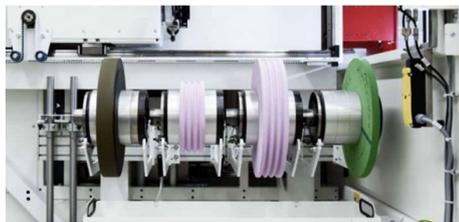
冈本工机(常州)有限公司UPZ52Li CNC超精密成形磨床工作台上作业范围 $550 \times 220$  mm。采用T型一体床身，动柱式结构，X轴采用直线电机驱动，油冷式砂轮主轴，进给轴的最小设定单位 $0.1 \mu\text{m}$ ，配置CCD摄影头、探头进行在线测量，搭载自主开发工艺软件，能实现砂轮成形磨削、多位置磨削和轮廓磨削。
