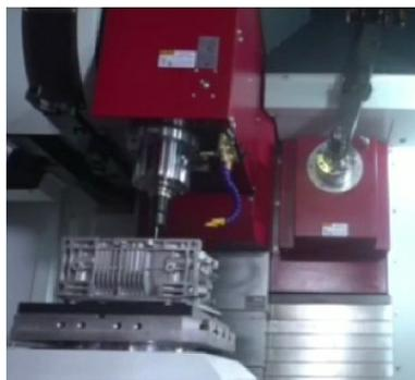
◆丰田工机（大连）有限公司 FH5000S-I 卧式加工中心：一款高速高效的卧式加工中心，主轴最高转速15000 r/min，扭矩530N·m，X、Y/Z轴行程800/880 mm，X、Y、Z轴快移速度60 m/min。应用有限元分析，提高机床结构刚性，实现加工过程的热位移最小化，丰富的支持功能实现快捷的换工装作业，双中心槽设计使排屑更顺畅，具有运行状态及数据可视化功能，达到机床自动稳定运行。□
