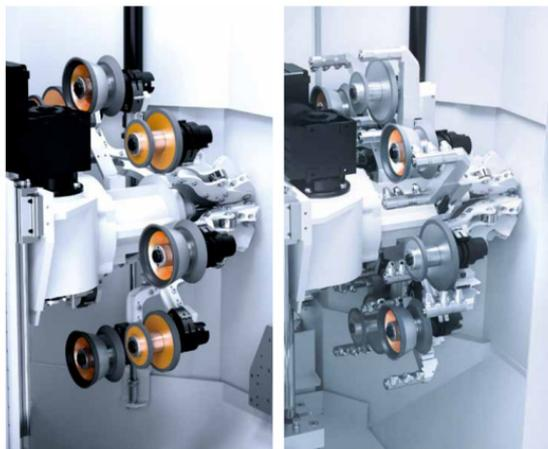
阿格顿中国AGATHON Evo Combi四轴磨削中心最大磨削外径为 $\phi 100$  mm（可选 $\phi 120$  mm），最小内径为 $\phi 3.96$  mm，可磨削刀片厚度最大为28.5 mm，砂轮直径为 $\phi 400$  mm。X轴、Y轴和C轴采用直驱技术，工作区的两个料盘能分别放置毛坯和已加工完成的工件，磨削区域和料仓分开，最多可配置16个料盘，配置平面4轴自动上下料机器人，加大了行程和可旋转角度范围，一次装夹高效重复精度磨削刀片双边倒棱，以及专门针对超硬磨削
