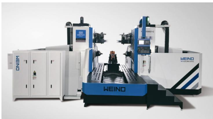
◆济南章力机械有限公司BOSM-2210 双面镗铣加工中心两立柱间距1550mm，两滑枕上下行程1000mm，单个滑座纵向行程500mm，主轴锥孔BT50。机床配有专用移动式工作台，二套卧式滑枕，可实现对工件的快速加工，在有效行程范围内对工件进行钻削、铣削、镗削等加工，工件一次加工到位(无需二次装夹)，实现装卸、定位速度快及加工精度、加工效率高。□
