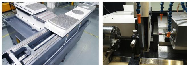
厦门创云精智机械设备股份有限公司 WM831系列 高精度数控外圆磨床 机床有8个数控轴，加工区采用5个数控轴，X轴和V轴为全闭环控制，V块+压轮的机构提高了工件的跳动精度，机床主体与外罩采用分离式结构，配置NUM数控系统，集成高精密切头、高速电主轴、双砂轮同步高速磨削等技术，采用粗精双砂轮磨削工艺确保产品精度，可选配工艺数据库，集成大量的成熟产品加工工艺，可实现自动上下料，批量无人化生产，广泛应用于铣刀、钻头、铰刀及各种高精密切机械零件加工。
