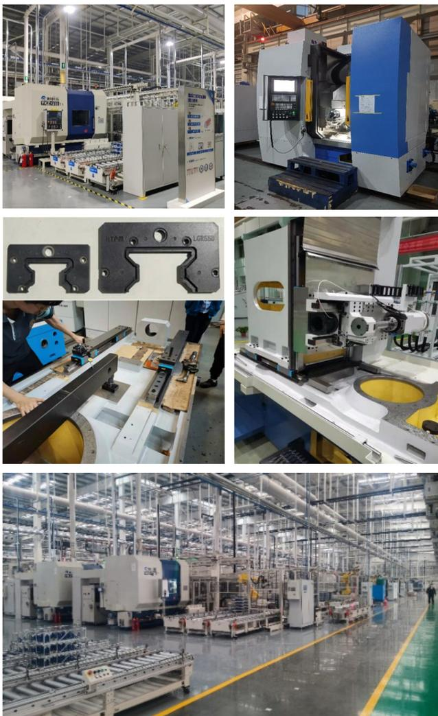
经过多年的联合技术攻关与产业化环境下的迭代验证，目前已在数控磨齿机精度、效率、可靠性等方面得到显著提升，核心新型磨齿技术得到突破，机床关键部件以及齿轮在线测量设备的国产化替代方案正在批量应用。采用蜗杆砂轮磨削主轴技术、齿面抗扭曲核心关键技术、超精镜面磨削技术、磨齿机制造工艺过程控制技术等核心新技术的数控磨齿机，批量加工齿轮精度可稳定达到GB5级，达到进口同类设备水平。法士特高智新工厂建设完成面向高端商用车领域的高精度齿轮高效加工示范应用生产线，产线设备国产化率由10%提升至78%，齿轮批量磨削精度由GB6级提升至GB5级，设备采购周期缩短6个月，成本降低60%以上，机加车间自动化率达到100%。
