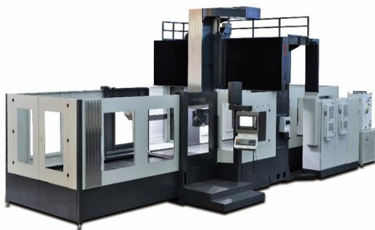
◆兹默曼机床(北京)有限公司 FZU32 五轴联动龙门加工中心 是一款紧凑的高架横梁移动式五轴联动龙门加工中心,采用热对称结构,八边形滑枕,中心驱动方式,模块化设计,满足不同用户的加工需要。X轴行程2000/4000/6000 mm可选, Y轴行程3000 mm, Z轴行程1250/1500 mm可选, A轴转动范围 $\pm 110^\circ$ 或 $-95^\circ \sim 125^\circ$ 可选, X/Y/Z轴进给速度 60 m/min, A、C轴进给速度30 r/min。用于加工铝、复合材料、塑料、聚氨酯和粘土等非金属材料。
