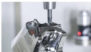
模具零件铣削加工
