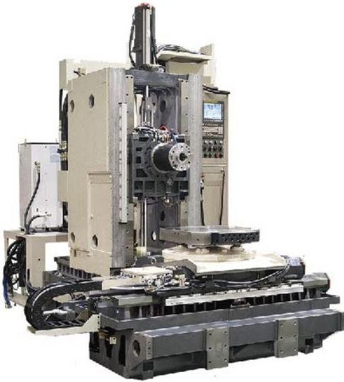
◆特雷维桑机床有限公司DS1200/450C数控镗铣加工中心X/Y/Z轴行程7500~11500/2400/2200mm；数控平旋盘（U轴）行程450mm，最高转速100r/min，电机功率37kW，最大扭矩16956N·m；最大工件直径 $\phi 2500$ mm，最大车削直径 $\phi 2000$ mm；卧式镗铣主轴（W轴）主轴直径 $\phi 280$ mm，电机功率37kW，最高转速2000r/min，W轴（数控滑枕）行程350mm。机床的数控平旋盘（U轴）是该设备的特色，可配置多样化的铣头；可以配置一个或两个2400×2400mm的连续旋转工作台，工作台也可以最大倾斜 $10^\circ$ ，最大承重25T；自动链式刀库，40个刀位，可扩展至80个刀位，一次装夹就可完成工件所有加工面的多种工序高效加工。
