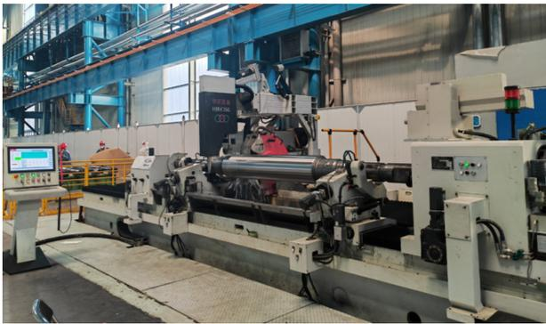
满足市场高端冷轧汽车板生产线高精度轧辊的高效磨削加工需求，为新能源汽车电机核心部件研制提供了国产高精度成套智能磨削装备。以平辊磨削机床为例，试件精度达到：圆度 $1.5\mu\text{m}$ ，圆柱度 $1.5\mu\text{m}/\text{m}$ ，表面粗糙度 $Ra0.2\mu\text{m}$ ；曲线磨削精度达到 $2\mu\text{m}/\text{m}$ ，比肩国际龙头企业水平，极大满足了国内客户的高效高品质生产要求的同时，也为本企业带来高端数控机床销售订单的增长。根据第三方数据显示，2021年公司数控轧辊磨床国内市场占有率达到43%，国际市场占有率达到23%，国内排名第一，全球前三。
