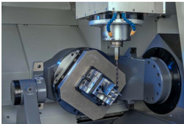
◆安田亚司达(上海)机床贸易有限公司立式数控镗铣加工中心：JIGBORER系列采用了高刚性一体化桥架对称结构、预载荷自我调整型主轴、机体温度控制系统等YASDA独有的技术，通过搭载精度补偿功能“HAS 4(High Accurate & Speedy Machining System)”以及高功能测量系统等，实现亚微米级高精度加工。主构件导轨结合面使用刮研加工处理技术，保证精度的长期稳定性。
