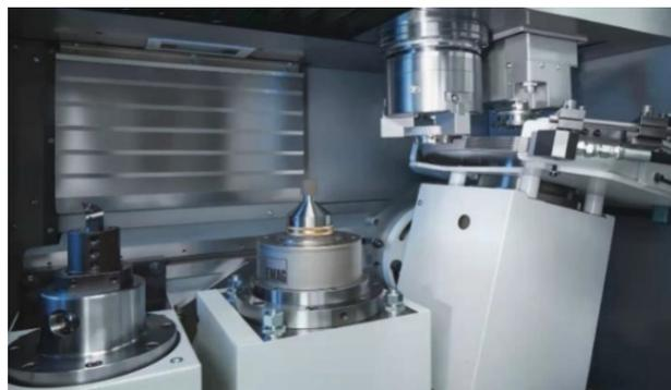
兄弟机械商业(上海)有限公司M200 $\times$ d1五轴联动车铣复合加工中心采用龙门式结构, 搭载具备车削主轴功能的倾斜转台, 一次装夹完成铣削和车削加工。工作台直
