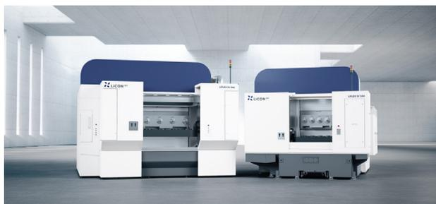
◆德国林康机床制造有限责任公司 Twin-Spindle 卧式五轴加工中心：主轴距离从400 mm到1500mm不等，两个主轴的运动独立控制，是一款具有高效率和高柔性的双主轴卧式五轴加工中心。可以选择托盘式或双耳轴式的交换工作台，有多种主轴可以选择，最大扭矩能达500N·m，最高转速为16000r/min，线性轴最大快速速度为140m/min，加速度为0.9g。通过LiCON i<sup>3</sup> 技术可以在不降低X、Y和Z三个轴的刚度情况下，对两个主轴进行
