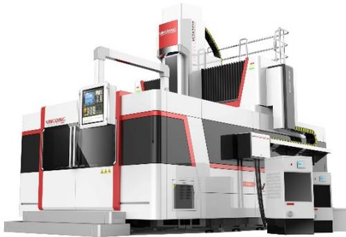
◆珠海格力智能装备有限公司GA-GM3020高速五轴龙门加工中心X/Y/Z轴行程3200/2300/1250 mm，X/Y/Z轴重复定位精度 $\leq 8 \mu\text{m}$ ，高架横梁移动式结构，高速直驱传动系统，X、Y轴大推力直线电机驱动，快速移动速度80m/min。高速高刚性电主轴，最高转速20000r/min；配置大扭矩双摆角铣头与A轴大扭矩转台，满足 $\phi 1800\text{mm}$ 零件一次装夹多面加工。全闭环直驱控制，配置微量润滑冷却系统。
