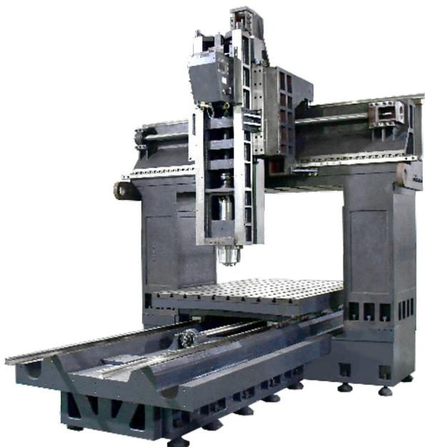
◆崑崙机电股份有限公司 RB-212 数控龙门加工中心X/Y/Z轴行程 2120/1200/800 mm机床采用一体式底座和龙门架，加大横梁和立柱截面，龙门架固定面长度，增加机床刚性，配置两档齿轮箱主轴，最高转速6000 r/min，满足重切削需要。适用于加工中小型精密的零组件及模具。
