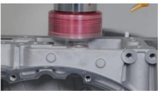
金属成型毛坯复合加工
