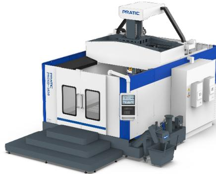
◆河北发那数控机床股份有限公司FA2518HE 数控龙门铣床该机床为工作移动式龙门加工中心，横梁采用2轨或3轨阶梯式垂直结构，工作台采用双层布局结构。X/Y/Z轴行程2500/1800/1000mm，主轴转速8000r/min。三轴均采用重载直线导轨，刚性强、动态性能佳。三轴进给传动结构为行星齿轮减速器或联轴器将动力传递到滚珠丝杠副。主轴传动结构可选择齿形皮带传动、直联结构或全齿轮结构三种方式，主轴箱两侧配有氮气平衡缸，保证主轴箱运动稳定；可选配全闭环控制、刀具检测和工件检测系统。主轴系统及高速齿轮的冷却采用油冷机冷却。□
