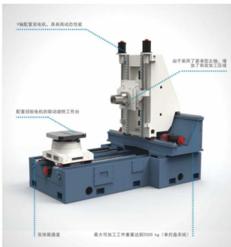
◆格劳博机床（中国）有限公司 G350 五轴联动通用加工中心：该设备X/Y/Z轴上的行程为600/855/750mm，最高速度为70/45/90m/min，最大加速度：0.5g/0.4g/0.7g。卧式主轴可达到同类机床中最长Z轴行程和最佳排屑效果；三个直线轴的独特稳定布局，将导轨与工作点（TCP）之间的距离比较小，“隧道”概念保证在使用最长刀具时机床各旋转轴都不受任何限制，最大工件直径φ720mm。
