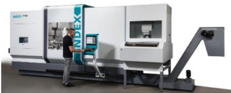
该公司展出的INDEX G420车铣中心可用于机械工程、汽车和航空航天等领域的高效加工，主要加工复杂多品种的大型工件。三滑台配置均带有Y轴，强大的铣削电主轴，以及2个刀塔，带有多达139刀位的刀库，为产品加工提供了最大的柔性。总计多达16个运动轴确保了工件加工的各种可能性。加工区域适用的车削长度可达1600/2300mm。强力主轴和副主轴设计用于棒料直径102mm或者直径120mm，或卡盘直径315mm/400mm的加工。刀塔可选配中心架用于加工长轴类零件。并
