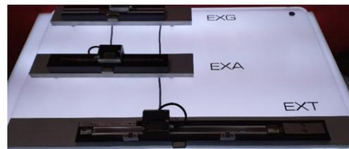
光栅尺采用封闭式和敞开式。精度等级± 3 μm、± 5 μm、测量长度玻璃光栅3040mm、钢带光栅50m。绝对尺兼容BISS-C及发那科、三菱等多种协议。角度编码器精度等级± 1"、± 2.5"、± 5" ± 10"等。有绝对式和增量式输出。
