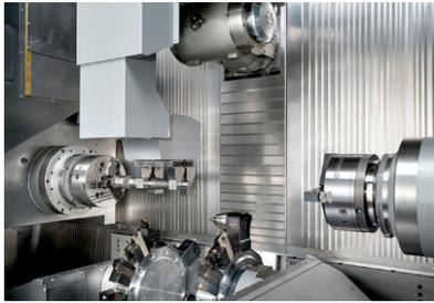
大隈机械(上海)有限公司MULTUS U3000 铣车复合加工中心,是MULTUS系列中智能化复合加工机床的典型产品,最大加工直径 $\Phi 650\text{mm}$ ,最大加工长度 $1000\text{mm}$ ,可选配 $1500\text{mm}$ 。具备同级别最大Y轴行程并采用高刚性立柱移动式结构,B轴分度角度 $-30^{\circ}\sim+210^{\circ}$ ,使主轴和副主轴拥有同等的加工区域。
