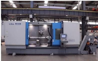
◆山东普利森集团有限公司 CH6163-5 铣车复合加工中心。最大加工直径 $\phi 630\text{mm}$ ，最大加工长度 $1000\text{mm}$ 。主轴单元有分别控制的液压阻尼和液压制动系统，保证了机床在高速铣削和低速重力铣削时主轴平稳抗振；Y轴为互为 $60^\circ$ 夹角的X轴和U轴插补虚拟轴，行程大，刚性好；24位刀库安装在下滑板后部与Z轴同时进给，可以在Z轴行程的任意位置装刀换刀，减少了传统固定刀库的装刀换刀动作故障，并且大大缩短了换刀的辅助时间。
