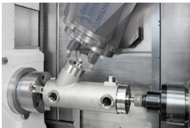
迪恩机床(中国)有限公司PUMA SMX2600ST 铣车复合加工中心。卡盘尺寸10英寸,最大车削直径 $\Phi 660\text{mm}$ ,最大车削长度 $1540\text{mm}$ ,共有9个轴,采用正交型Y轴结构,左右主轴及铣削主轴组合,铣削主轴安装在摆动B轴上,配备12位高刚性伺服刀塔,具有强大的切削性能。结合左右主轴、B轴铣削功能和下刀塔,具有更高的多任务处理能力,适用复杂零件和高精度要求零件的加工。采用人体工程学设计,前置刀库及触屏式ATC操作面板,更加便于操作和维护修理。
