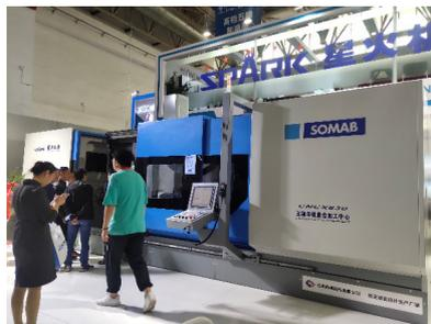
该公司展出的CNCX630五轴车铣复合加工中心能够实现X、Y、Z、B、C五轴联动，其中X、Y、Z、为
