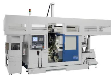
村田机械的对向双主轴车铣复合加工机MT系列，是一款可灵活对应多种上下料方式的多功能自动化复合机床。全部刀塔可搭载Y轴、动力刀座，将车削、打孔、精加工等多道工序集为一体，1台设备既可复合加工也可正反加工，实现复杂工件工程集约化。同时既可搭载高速伺服棒料堆载装置，又可通过新型高速门型机械
