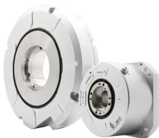
高精度整体式角度编码器主要指标：准确度 $\pm 1''$ ， $\pm 2.5''$ ， $\pm 5''$ ；分辨力26bit或28bit；输出协议：Biss、DQ、Canopen。
