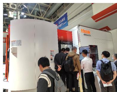
该公司展出了INTEGREXi-630V、INTEGREXi-250HS、INTEGREXi-500S三款车铣复合加工机床。其中INTEGREXi-630V机床X轴行程1425mm/56.10in，Y轴行程1050mm/41.34in，Z轴行程1050mm/41.34in，最大加工直径1050mm/41.34in，最大加工长度1000mm/39.37in，车削主轴最大转速550 r/min，铣削主轴最大转速10000 r/min，刀库容量43。高效摆线加工、修抛加工、铣、车、钻、五轴联动加工以及斜角锥度孔都可以Done in one在一个工序加工完成。可缩短加工节拍，实现生产加工的高精度与工序集约。采用基于人机工程学的设计，可实现舒适的操作性。
