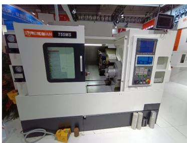
◆浙江金火科技实业有限公司TT7580数控车床。这是一款斜床身刀塔车床，床身上最大回转直径φ650mm，拖板上最大回转直径φ400mm，最大车削长度800mm。采用整体倾斜30°结构床身，床身横
