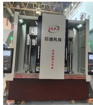
该公司展出的JXLC45型数控立式车床是采用数控系统控制的两坐标数控机床，最大工件高度300mm，最大切削直径360mm（回转450mm），最大切削余量单边5mm（直径100mm），主轴转速范围50~1500r/min。能自动进行各种盘类零件的内、外圆柱面、圆锥面、圆弧面、切槽、倒角、螺纹（公、英制螺纹，锥螺纹，端面螺纹）及钻、铰、镗孔等工序的切削加工。本机床对于汽车配件、轴齿类零件小型电机行业电机及电机壳盘件都有更强的优越性。是一款高刚性、高精度、优良的精度保持性、生产效率高、操作宜人性好、造型美观、防三漏效果理想的全功能数控机床。
