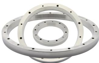
金属光栅角度编码器主要指标：金属光栅尺寸 $\phi 52\text{mm}$ 至 $\phi 550\text{mm}$ 多种尺寸；应用领域为数控转台、DD马达等；通讯协议BiSS-C、SSI；绝对位数21bit-28bit。
