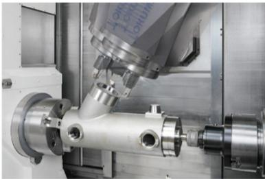
◆德马吉森精机机床贸易有限公司CTX Gamma 2000TC铣车复合加工中心。最大工件直径 $\phi$ 700mm,最大工件长度2000mm,最大棒料直径 $\phi$ 127mm,X/Y/Z轴行程800/420/2050mm。内置主轴驱动,扭矩达4000N·m,车/铣主轴最高转速12000r/min,扭矩220N·m,超紧凑车/铣主轴满足复杂车削和铣削加工要求,可选配第二刀架、刀塔中心架及刀塔顶尖。
