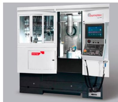
WFL车铣技术公司M30 MILLTURN铣车复合加工中心，适用复杂轴类及盘类零件的六面加工，复合了车削、铣削及钻削加工工艺，能够实现五轴联动加工，还可以根据需要进行选择相应的模块，实现齿轮加工或深孔加工。
