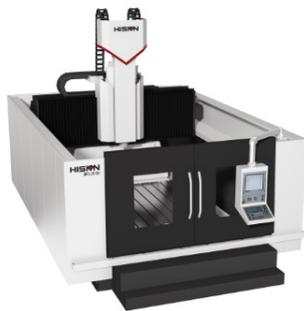
BFL2030H动柱高速铣削中心适用于新能源汽车“一体式压铸前机舱和后底板”零件的加工。产品标配五轴头，配合第四轴转台实现六轴加工；零件一次装夹可以完成整套工序的加工，提升零件加工效率。
