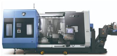
◆科德数控股份有限公司KTX1250 TC五轴卧式铣车复合加工中心。机床平斜床身立柱移动的结构,配合单摆直角头、双工件主轴和中心架或下刀塔;主轴转速最高为12000r/min;B轴摆动范围为 $-120^{\circ} \sim +120^{\circ}$ ,最高转速为60r/min。工件最大回转直径为 $\phi$ 700mm,最大车削直径为 $\phi$ 630mm。采用八角滑枕整体结构,应力分布均匀,刚性好。
