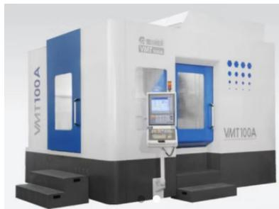
该公司展出的VMT100A五轴立式铣车复合加工中心功能复合化，主轴可立卧转换并可连续插补运动，且具有高精度，在全行程2000mm范围内（VDI标准），定位精度≤0.006mm，重复定位精度≤0.004mm，回转工作台定位精度≤6"，重复定位精度<4"；转台扭矩最大可到18000N·m，摆动主轴最大扭矩≥700N·m；可实现自动对刀、在机测量、RTCP自动标定、主轴主动热补偿、过程监控、自适应加工等自动化特点。具有一次装夹实现钻、扩、铰、镗、攻丝、铣等多工序集成加工功能。
