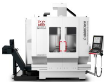
科德数控KMC800W系列重切型产品搭载了企业自主研发的大扭矩高效机械主轴，主轴内部采用1:4的齿轮减速比，配备同样自主研发的水冷主轴电机，额定扭矩84N·m，主轴电机可实现最高转速10000r/min，机械主轴采用BBT40接口，相较于BT40能实现更高扭矩的切削。
