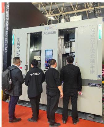
该公司展出的DVL400-4及DVL400-II数控车床。其中DVL400-4机床最大回转直径580mm，最大加工外径420mm，主轴通孔直径50mm，主轴端部型式及代号A2-8，主轴转速范围30~1800r/min，主电机功率15kw，主轴扭矩300N·m，X轴快速移动速度14m/min，X轴最大行程190mm，X轴定位精度0.01mm，X轴重复定位精度0.005mm。DVL400-II为立式双工位长轴车床，最大回转直径400mm，最大加工外径350mm，主轴电机15kW，主轴最高转速1800r/min，12寸液压三爪卡盘。DVL400-4采用动柱式结构设计，可有效提高机床刚性和抗振性，从而保证机床的精度和稳定性；床身导轨采用阶梯式结构，使移动部分轻量化，同时优化了机床受力结构；导轨采用进口品牌直线滚柱式导轨，能够长期保持良好的刚性和精度。可广泛应用于汽车、兵器、液压配件行业的精密加工，占地面积小加工精度高等特点。
