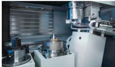
兄弟机械商业(上海)有限公司M200 $\times$ d1五轴联动车铣复合加工中心,采用龙门式结构,搭载具备车削主轴功能的倾斜转台,一次装夹完成铣削和车削加工。工作台直径为 $\Phi 140\text{mm}$ ,A轴旋转范围为 $+120^{\circ}\sim-30^{\circ}$ ,X/Y/Z轴快移速度为 $50\text{m/min}$ ,A轴最高转速为 $60\text{r/min}$ ,C轴最高转速为 $200/2000\text{r/min}$ (车削主轴)。A轴采用滚子齿式凸轮,C轴采用力矩电机,消除了背隙,实现高速高精度五轴联动加工。最高转速为 $2000\text{r/min}$ 的高输出车削主轴、车削刀具的双柱塞锁紧方式以及A轴采用机械+伺服夹紧方式,能发挥出高效的車削加工能力,C轴具有锁紧功能可以满足更大旋转方向上的负载和更苛刻的切削条件,提高机床的加工性能。
