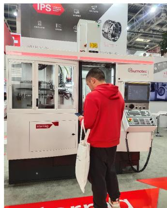
该公司展出的Bumotec 191neo五轴联动铣车复合加工中心，主轴通孔直径有三种规格：42mm，50mm和65mm，背面加工单元有四种不同的类型：“P”型-单虎钳机构，“PRM”型-多副虎钳和夹具组合，“R”型-立卧转换背主轴结构，“RP”型-背主轴虎钳或顶针结构。由此可见，191neo向市场提供的不是一种单一的生产方式，而是基于一个平台的12种配置。191neo在生产中极其稳定，无需任何人为干预，提供了惊人的生产力。换刀时间减少了约15%，进一步提高了对最严苛加工节拍要求的响应。此外，斯达拉格开发和生产的铣削主轴扭矩更大，背面加工单元的运动由电机控制，速度提高12%，位置控制更严格、更精确。
