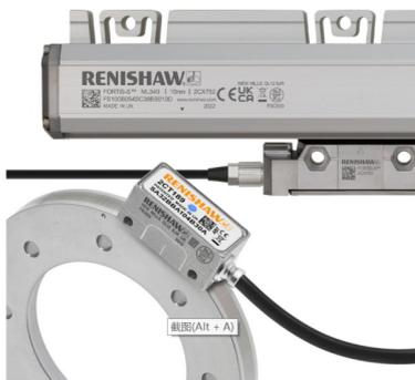
RENISHAW的钢带光栅尺在测量机和仪器上使用很广泛，精度等级± 5 μm/m，如海克斯康(Hexagon) 测量长度最长可达30~50m。26位的角度编码器也大量用于数控机床的机床旋转工作台和机床倾斜头，角度编码器精度等级（玻璃光栅取决于直径大小）2.78"，金属光栅精度等级± 0.5"（取决于直径大小）。现在也有绝对式的光栅尺，长度为10m，通信接口是IC-HAUS的BISS-C。新推出的FORTiS封闭式绝对直线光栅，其搭载雷尼绍经验证的绝对式光栅技术，采用异常坚固的封闭式设计，可在极其恶劣的环境中实现优异的测量性能，适用于对加工精度有较高要求的机床。FORTiS™光栅系统采用雷尼绍成熟的绝对位置测量技术。密封式读数头内部放置一个微型超高速数字摄像机，可读取单码道、精细栅距（30 μm）钢栅尺，具有出色的位置反馈、运动控制、测量及抗污性能。
