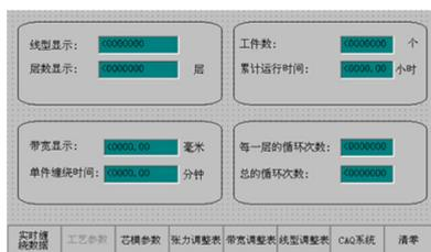
在工艺参数区，可以显示线型显示、层数显示、带宽显示、单件缠绕时间、工件数、累计运行时间、每一层的循环次数、总的循环次数。层数显示是指当前缠绕到哪一层；线型显示和带宽显示，是根据当前缠绕到的层数对应的线型和带宽；单件缠绕时间是指单个缠绕程
