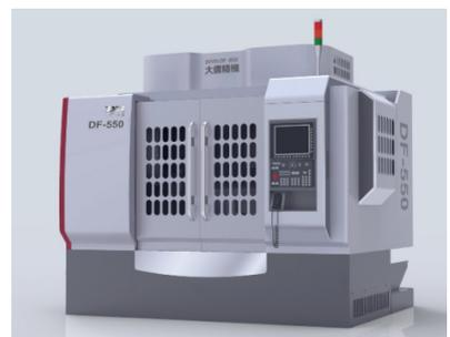
大侨精机的专利产品——双主轴双盘面五轴加工中心，双主轴同时加工，成倍提高效率。
