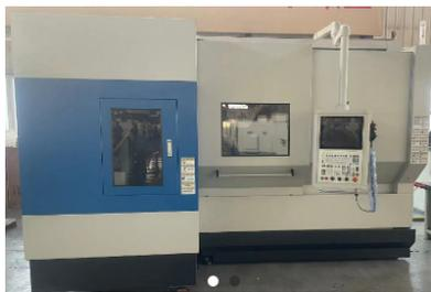
该公司展出的LM400卧式五轴车铣复合加工中心最大车削直径中
