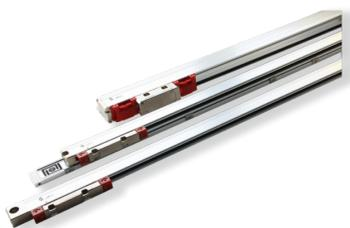
高精度绝对式光栅尺主要指标：最大量程4040mm；精度 $\pm 3\mu\text{m/m}$ ； $\pm 5\mu\text{m/m}$ ；定位精度 $\pm 0.1\mu\text{m}$ ；分辨率 $0.0025\mu\text{m}$ ；运动速度 $\leq 180\text{m/min}$ ；通信接口：BiSS-C、DQ。
