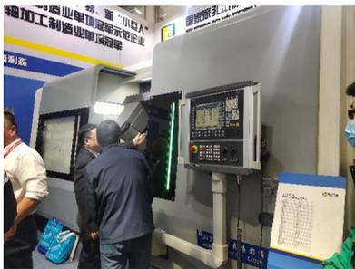
CH6163-5车铣复合加工中心是一种高柔性多用途复合加工中心，机床通过控制X、Y、Z、B、C五轴联动，能够完成任意角度和形面的车削、铣削、钻削、镗削、磨削、攻、铰、扩、滚齿等任务。机床配置大功率主轴和B轴动力刀塔及24位自动刀库使机床具有超凡车铣加工能力。
