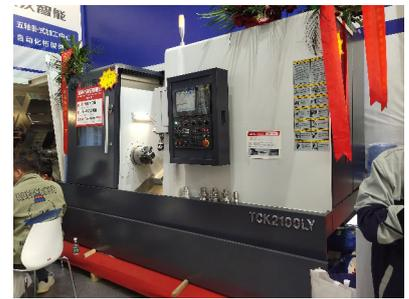
该公司展出了三款车铣复合加工中心，分别是TCK2100LY大型车铣复合（插补y轴）、TCK63Y-1500大型车铣复合加工中心和TCK56SY-BMT55大型车铣复合（双主轴）。其中TCK63Y-1500大型车铣复合加工中心，尺寸426×210×260cm，重量5000kg，配置有上银滚珠线轨岐山丝杆BMT65三和Y轴刀塔超同步A2-8电主轴及华中818F系统。一次装夹可完成车、铣、钻孔、滚齿等工序的复合配置BMT65动力刀塔，其刚性可替代小型加工中心，最大回转直径可达720mm，适用范围广泛，搭配37kW高刚性电主轴，是大型车铣复合最具性价比的选择。
