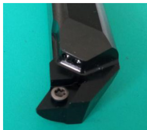
实拍的内孔镗刀杆 (上方两个喷嘴 \phi 1\text{mm} )
