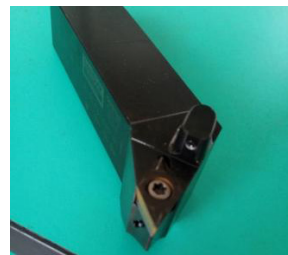
实拍的外圆车刀 (上下各一个喷嘴均为 \phi 1\text{mm} )
