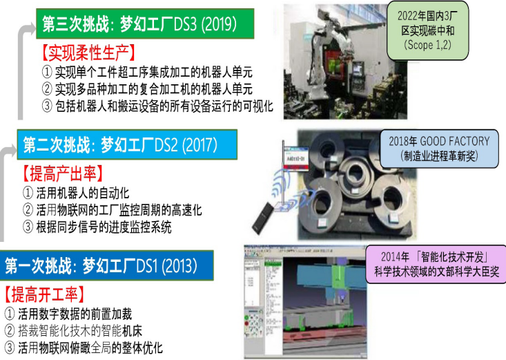
图5 大隈智能工厂的构建过程
