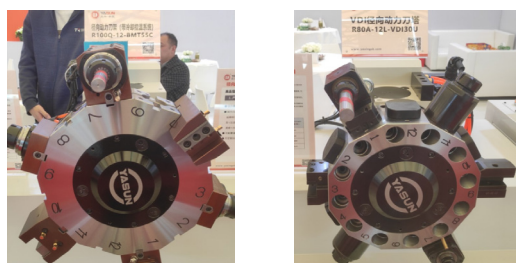
(a) 径向动力刀架（带冷却控温系统）
