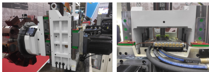
图10 台湾联碁的线轨Y轴刀架（框架内还有两个硬轨）
