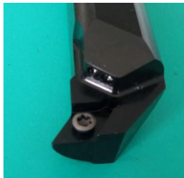
(c) 实拍的内孔镗刀杆 (上方两个喷嘴 \phi 1mm)
