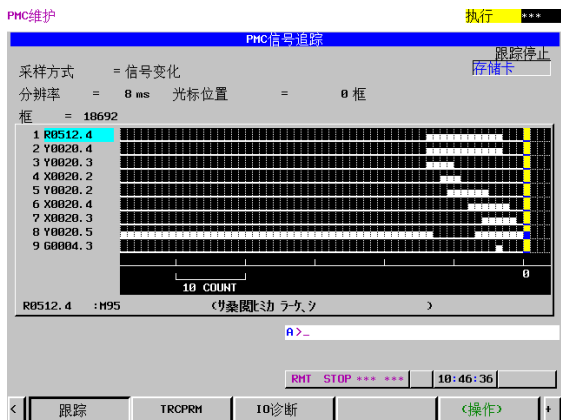
图6 PMC信号追踪用于机器人上下料PMC动作时序确认
