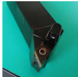
(d) 实拍的外圆车刀 (上下各一个喷嘴均为 \phi 1mm)
