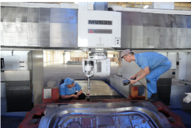
图4 现场手工对刀设定高度
