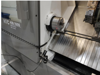
图6 检测主轴动平衡图
