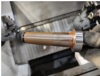
图7 检测尾座顶尖接触率图
