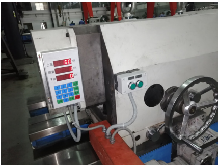
图5 测力仪安装图
