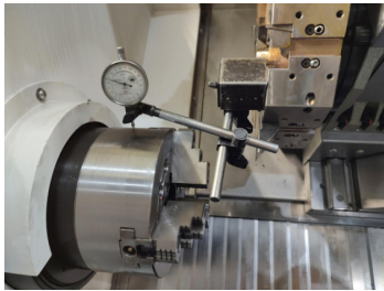
图5 检测机床的卡盘跳动图
