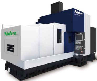
新开发的高速主轴（主轴转速10,000r/min）相比标准主轴（7,000r/min），在保持主轴高刚性结构的同时提高转速，不仅可用于传统的零部件加工和粗加工，还能满足需使用高速旋转的小径工具进行模具精加工和铝材高效加工等工序。通过主轴的高速化，转速范围扩大到35r/min至10,000r/min，在理想加工条件下实现了表面质量的提升和高效加工，大大提高了用户的生产效率。
