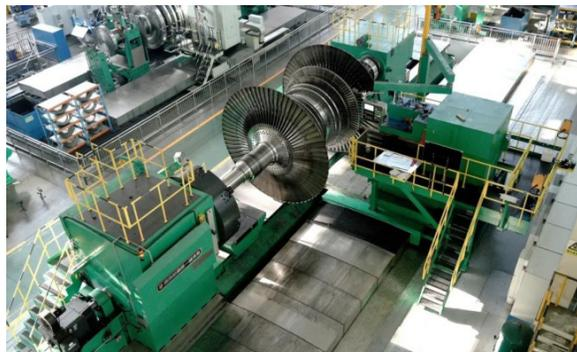
据了解，国内核电大型汽轮机转子“外窄内宽”凹槽的加工一直是限制汽轮机产出的主要因素。在传统加工“外窄内宽凹槽”时，需要进行12次手动换刀再对刀，加工效率低，且主要核心技术加工精度不达标。能满足要求的进口设备价格昂贵，并要签署苛刻的限制条件，长期受制于人。齐重数控研制的该重型数控卧式车床是专门用于核电大型汽轮机转子等高精度零件加工的，能够完全达到关键技术指标要求，效率更高，且兼具高精度、高刚性、高可靠性特点。机床最大车削直径4.5m、最大工件长度16m、最大工件重量350t、主轴端/径向跳动达到0.005mm。
