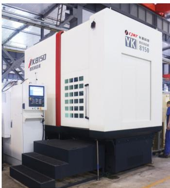
按比例高速旋转，一方面可以加工出所需的齿面形状，另一方面在加工的同时，实现了分度，大大提高了加工效率。本技术有效地解决了传统齿轮加工工艺加工非贯通、无退刀槽结构形式内齿圈困难的问题，同时，为齿轮加工领域提出了一种全新概念的齿轮加工工艺。在技术开发过程中成功申报了一项外观设计专利“刮齿机防护罩”（专利授权号：ZL202230710568.8）。
