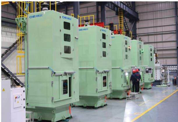
图1 深槽加工数控立式内拉床实物图
