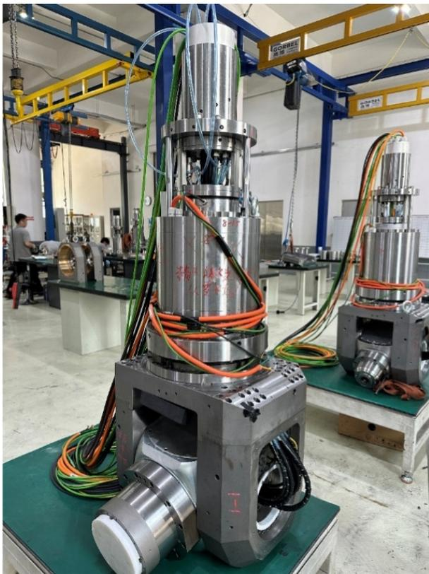
对于摆头旋转密封系统，伊贝格通过“复合密封形式+高性能材料+智能监测”三重技术路径，解决了高端五轴机床的精度保障、寿命提升、工况适应性这三大核心
