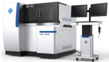
(3) 北京海普瑞森超精密技术有限公司 DJC-250A超精密单点金刚石车床,最大加工直径 $\phi 250\text{mm}$ ,面形精度 $PV < 0.2\mu\text{m}$ ;X/Z轴最大行程200mm,表面粗糙度 $Ra < 2\text{nm}$ 、直线度0.14m/100mm,主轴最高转速8000rpm。X/Z轴均采用液体静压导轨,直线电机驱动,全闭环控制,PMAC可编程控制器。可选配B轴、真空度可切换吸盘、精密微调刀塔,实现360°分度功能。
