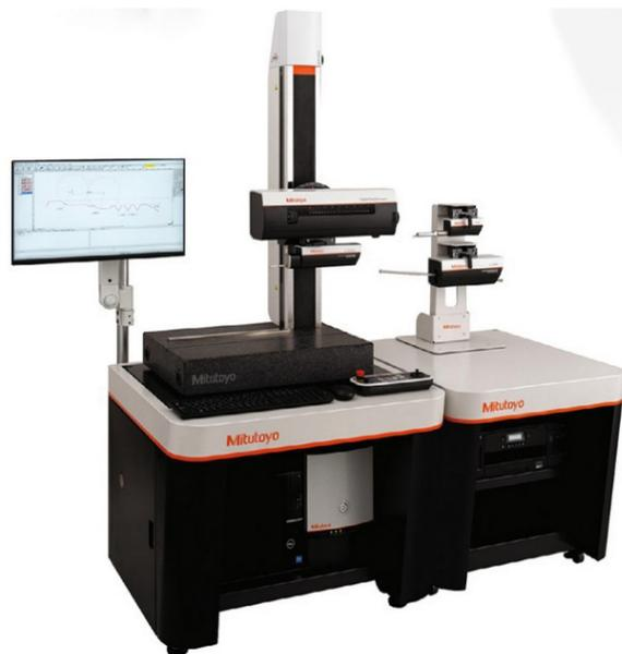
传统上，测量表面粗糙度与轮廓需使用两台独立设备或驱动单元。FTA-H3000 仅需一次操作即可完成两项测量，显著降低了人为误差，同时最大化提升了生产效率。该设备专为追求高效且绝不妥协精度的制造商和专业人士设计，以前所未有的方式简化了测量流程。
