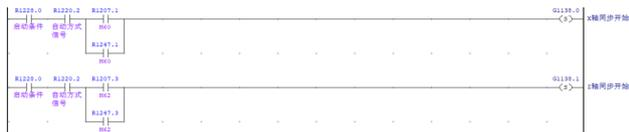
图14 同步控制开始图
