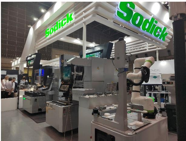
单机自动化解决方案，由五轴立式加工中UX650L、自动工件更换装置SR12 AWC组成。UX650L采用直线
