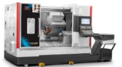
(3) 东莞市扬牧数控科技有限公司 LM-08Y2 双主轴双通道车铣复合中心，床身上回转直径 $\phi 500\text{mm}$ 、拖板回转直径 $\phi 200\text{mm}$ ，最大加工长度200mm，主轴/副主轴最高转速5000r/min，X1/X2轴行程420mm，X1/X2快移速度20m/min；Z1/Z2轴行程265/1200mm、Y1/Y2行程 $\pm 35\text{mm}$ 。对向式双主轴，左右刀塔配备双Y轴硬轨高刚性动力刀塔，大扭矩内藏式驱动电主轴转速12000r/min。
