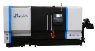
(2) 安徽力成智能装备股份有限公司 VQXC125球笼硬车硬铣复合机床,最大夹持直径 $\phi 110\text{mm}$ 、最大工件长度260mm、加工沟道直径范围 $\phi 45\text{--}95\text{mm}$ ,工件所配钢球直径范围 $\phi 12.7\text{--}22\text{mm}$ ,工件最大柄部直径 $\phi 38\text{mm}$ ;一次装夹硬铣多沟道的球笼硬车硬铣床复合机床,适用于钟形壳热后VL/CG型沟道的硬铣精加工。
