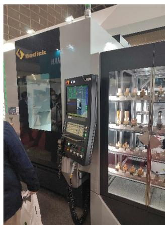
高效加工解决方案以大型ALN800G i Groove + Edition线切割机床为主体，为“汽车零部件的大型模具”等大型模具的制造提供高效解决方案。该机X、Y、Z轴行程分别为800mm、600mm、500mm，U、V轴辅助行程为200mm；加工槽内尺寸1500mm×1040mm，最大加工件1250mm×1020mm×500mm，3000kg。其“i Groove”旋转结构能够减少大厚度加工中线材的消耗，S3core（自动模芯处理系统）、ACPS（自动导电块移位器）、防止工件电蚀和化学腐蚀的“Rustless”等多个选
