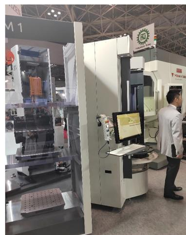
PX30i五轴精密立式加工中心，标配33工位APC和323刀位ATC，可实现长期无人化加工。它配备了YBM系列中使用的预紧自调节主轴，可在保持刚性的同时实现高速5轴加工，在日本的目标市场定位在半导体制造设备零件的加工领域。该机X、Y、Z轴行程分别为680mm、400mm、500mm，B、C轴转动行程为 $-125^\circ \sim +65^\circ$ 、 $360^\circ$ ，主轴最高转速20000r/min，最大加工件 $\phi 400\text{mm} \times 315\text{mm}$ ，80kg。
