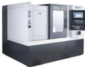
(2) 华粹智能装备有限公司 UPC200超精密机床,最大加工直径 $\phi 200\text{mm}$ 、最大车削长度200mm,专为光学透镜、反射镜、高精度零件及模仁的加工制造而设计,表面粗糙度甚至能达到纳米级。机床主轴采用小孔节流空气静压形式,在10,000r/min转速范围内主轴的径向跳动和轴向窜动均小于50nm。基于高速64位Delta Tau PowerPMAC运动控制器,自主研发了人机交互控制系统。
