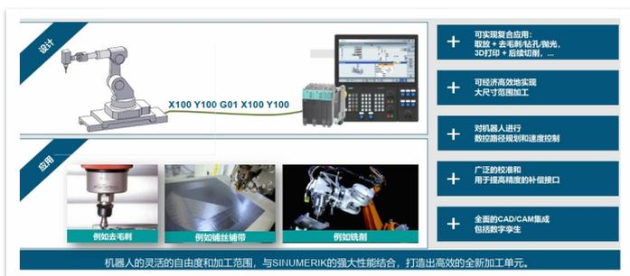
图8 Run MyRobot功能示意图
