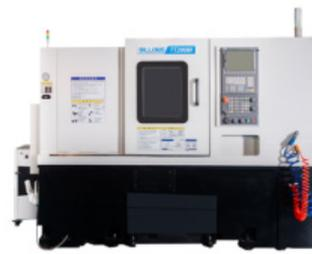
（3）玉环市坎门机床厂 K06SY2车铣复合机，最大切削直径 $\phi 280\text{mm}$ 、最大切削长度600mm、主轴最高转速4300r/min；X1/X2轴行程190mm、Z1/Z2轴行程600mm、Y1/Y2轴行程 $\pm 50\text{mm}$ 、12工位T1/T2刀塔。床身整体450布局，双C轴控制，XZ轴采用加长滑块直线导轨，Y轴采用硬轨结构和动力刀塔一体化设计，极大提高了切削刚性和抗振能力。
