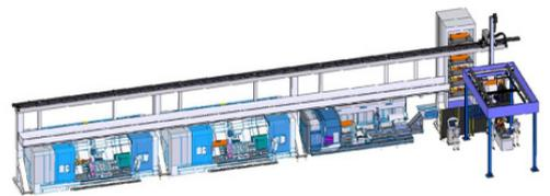
(2) 重庆机床(集团)有限责任公司 VHL4035正倒立式数控车床，最大工件回转直径 $\phi 600\text{mm}$ 、最大工件直径 $\phi 420\text{mm}$ 、最大工件长度450mm，立式/倒立式主轴最高转速2500r/min，快移速度24m/min，五轴四联动正倒立式数控车床，采用立式主轴和倒立式主轴垂向对置、双径向进给水平移动、双轴向进给垂向移动、伺服双面加工W轴的复合式布局，实现高效高精度车削加工。
