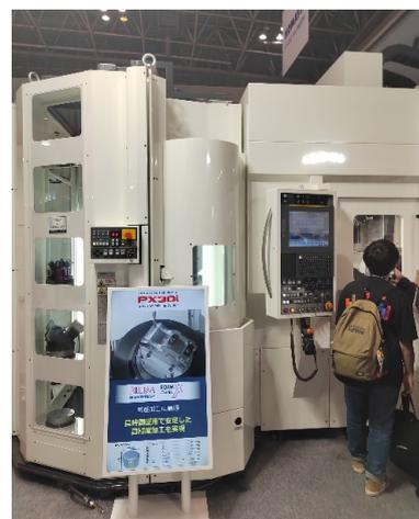
展出的YBM640三轴立式加工中心和精密微细加工中
