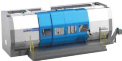
(2) 科德数控股份有限公司 KCX1200TM五轴联动卧式铣车复合加工中心，最大车削直径 $\phi 400\text{mm}$ 、最大车削长度1200mm，B轴旋转角度 $-30\sim 210^\circ$ ，B轴额定扭矩 $576\text{N}\cdot\text{m}$ 。直线轴定位精度 $0.008\text{mm}$ ，旋转轴 $10''$  (VDI)，直线轴重复定位精度 $0.005\text{mm}$ ，旋转轴 $5''$ ；模块化设计，快速实现不同行业的工艺需求。
