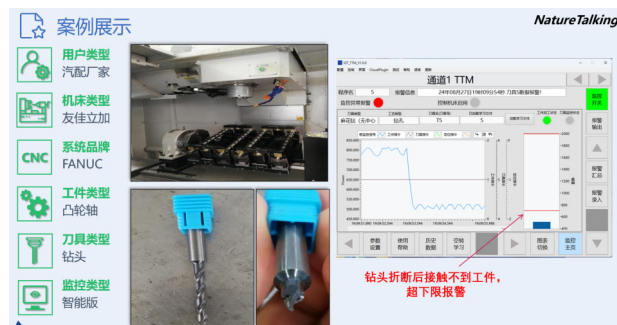
(a) 智能刀具监控系统在加工中心的应用案例
