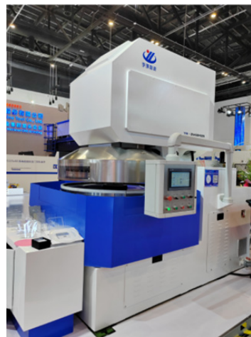
图3 YH2MG84125 高精度立式双端面研磨（抛光）机
