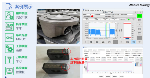
(b) 智能刀具监控系统在车床的应用案例
