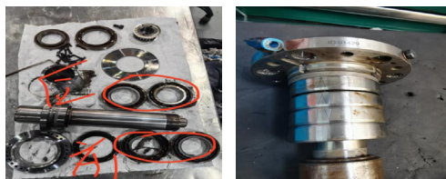
(a) HOFIER金刚轮解剖图 (b) NILES金刚轮解剖图 图2
