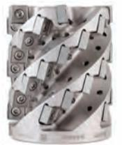
这款产品刀片在刀体上布置为不等螺旋角不等齿距, 可以有效降低切削加工负载, 以及加工中的振动噪音。并且为了在加工 S 类材料的过程中获得更高效的冷却, 这款铣刀的刀体为每一片刀片的刃口设计了内冷通道, 这种设计不但可以让刀片刃口获得充分的冷却, 也可以进一步提高排屑能力, 因此在狭小的加工空间中也能获得顺畅的排屑。
