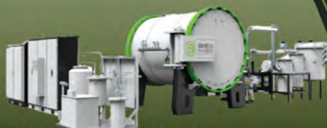
碳化硅化学气相沉积炉
